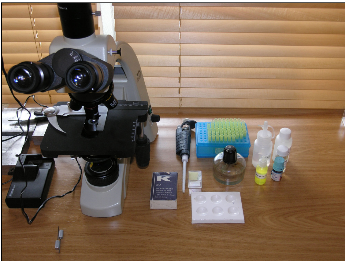
Figura 3: Material necesario para la práctica de la microscopía química: Microscopio, porta y cubreobjetos, placa de gotas de porcelana, pipeta para manejar cantidades entre 20 y 100 microlitros, mechero de alcohol y reactivos.
