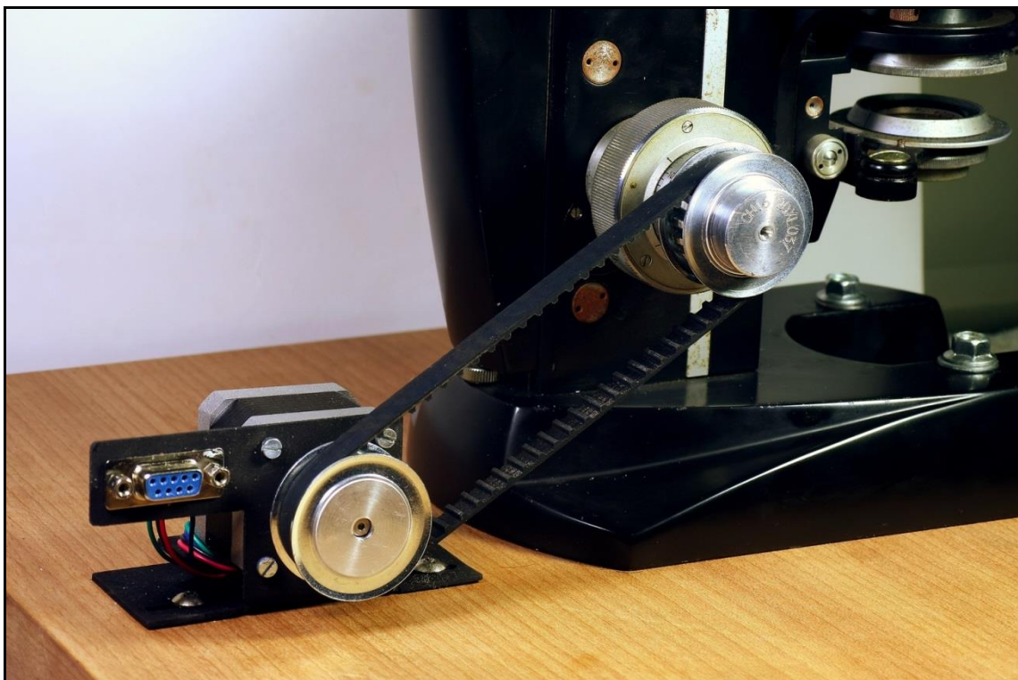
Figura 12: Detalle transmisión del movimiento del motor a un microscopio petrográfico. Poleas dentadas y
