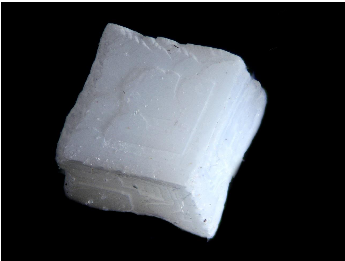
Figura 16: Cristal romboédrico de carbonato cálcico obtenido sintéticamente mediante cristalización en gel en el laboratorio. (Fot. César Menor-Salvan).
