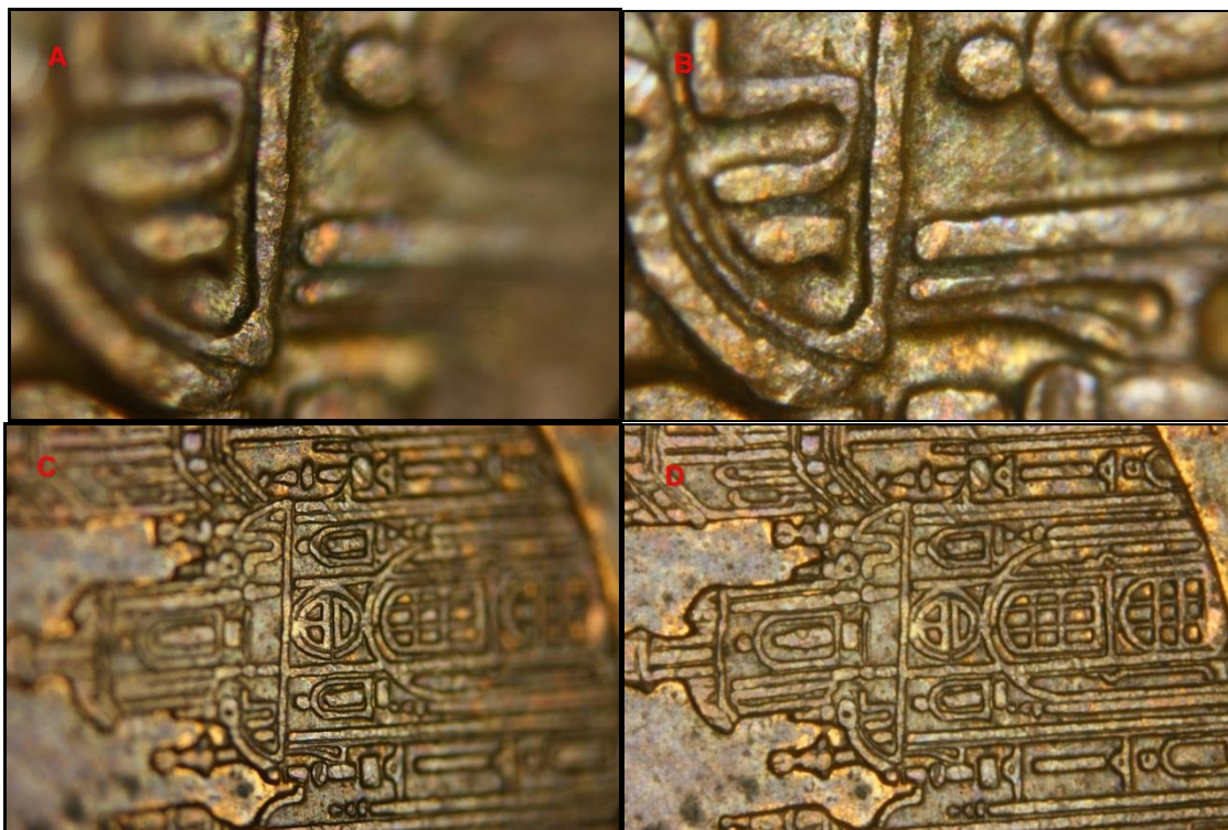
Figura 4: Imagen de la superficie de una moneda puesta a 45^\circ respecto del plano de la cámara. A y B tomadas a 3 aumentos, C y D tomadas a 10 aumentos. A y C a diafragma totalmente abierto, B y D a diafragma totalmente cerrado mostrando mayor PDC pero menor calidad de imagen.
