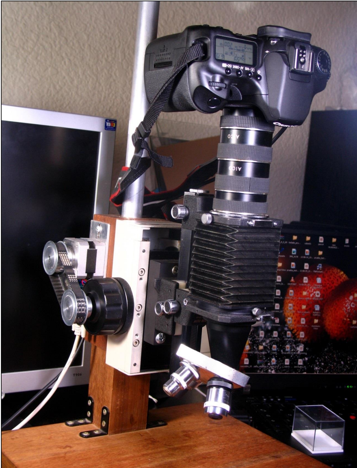
Figura 10: Macroscopio casero. Un fuellé de fotografía se encuentra unido a un piñón de enfoque con movimiento macro y micrométrico, en la parte inferior se encuentran los objetivos mientras en la superior se coloca la cámara, en este caso una DSLR Canon Eos 40D. (Fot. H. Cócera).
