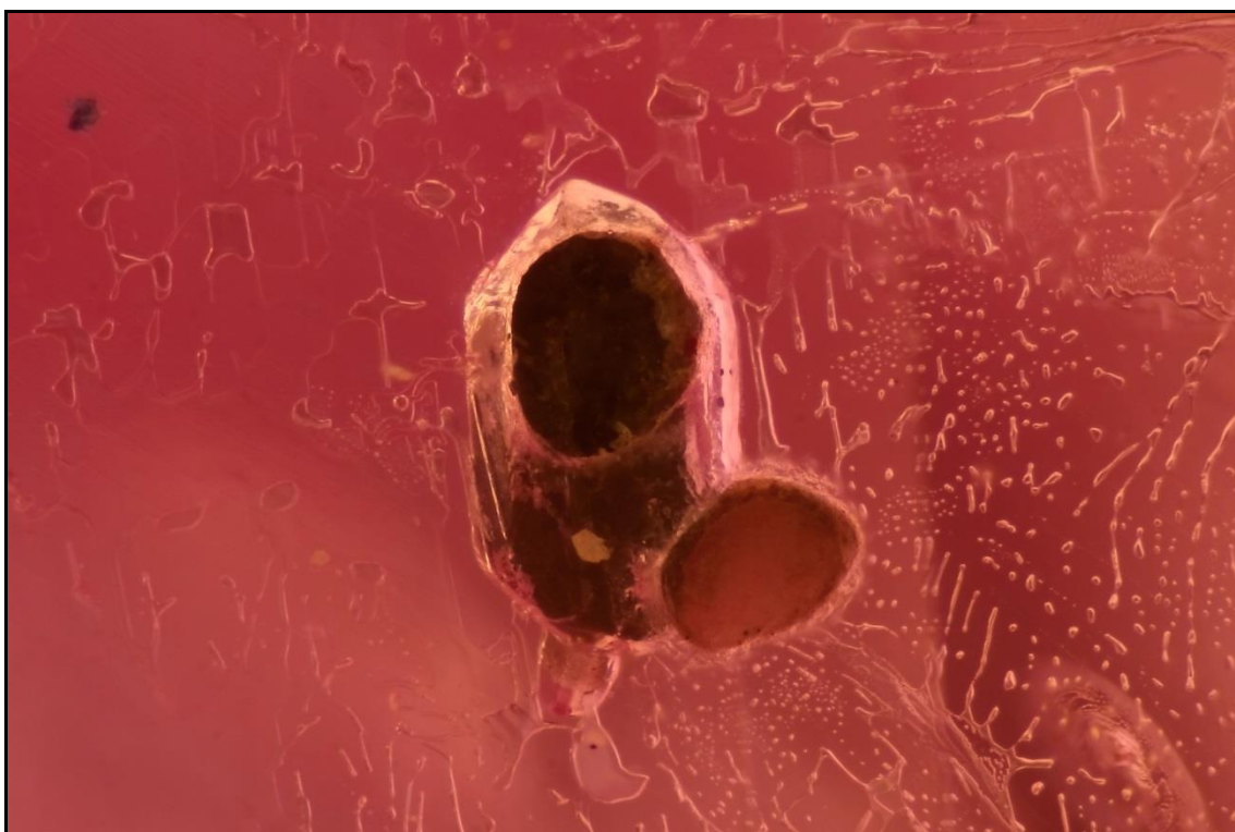
Figura 20: Imagen de una inclusión en cristal de rubí obtenida mediante Stack_Duino + multifoco. (Col. M.A. Maroto, Fot. H. Cócera).
