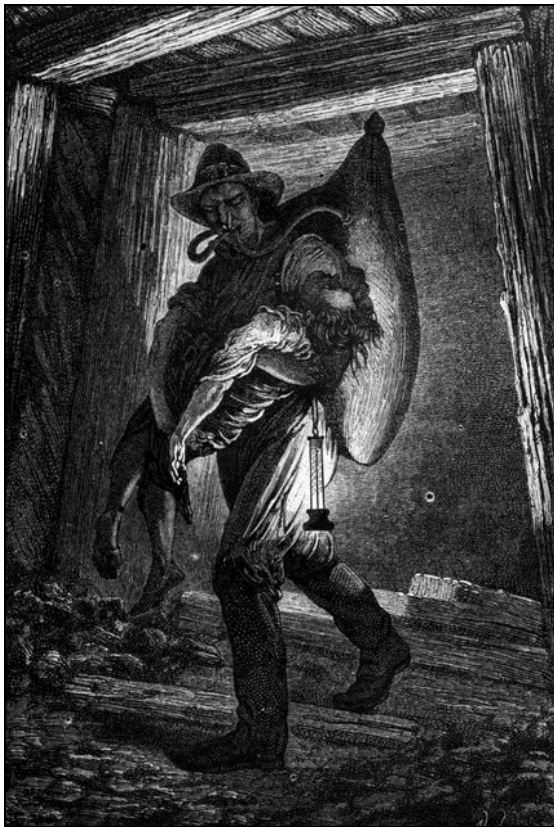
Izquierda: Saco Galibert (La vie souterraine, 1867); derecha: Aparato de salvamento Rouquayrol (La vie souterraine, 1867)
