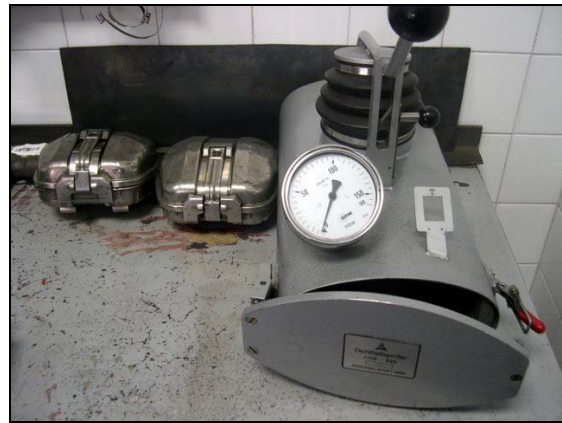
Izquierda: Autorrescatador MSA (Fot. M. Cañón, 2009); derecha: Comprobador de estanqueidad de autorrescatadores MSA (Fot. M. Cañón, 2009)
