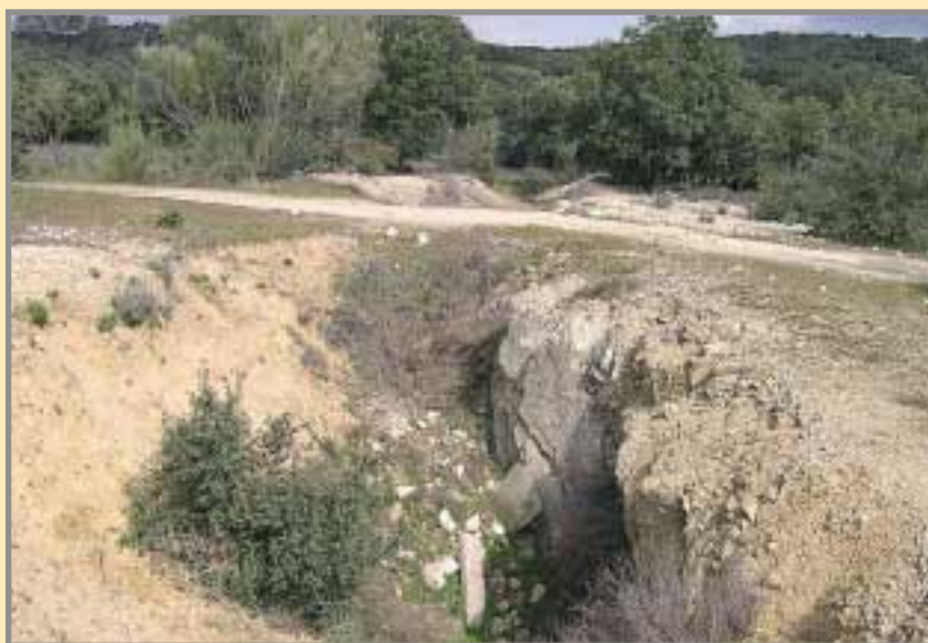
Afloramiento trabajado del filón de fluorita y sulfuros de la mina "Rosita", que encaja en unas adamellitas porfídicas. Foto: R. Jiménez, 2004.
