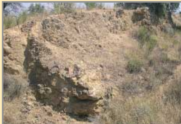
Trinchera sobre filón de barita con galena y esfalerita en la mina "El Molinillo", de Cadalso de los Vidrios. Foto: R. Jiménez, 2004.
