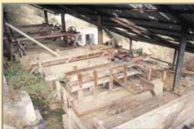
Las instalaciones se conservan en muy buen estado, como estas mesas de sacudidas para concentración de estaño. Foto: L. Jordá, 2003.
