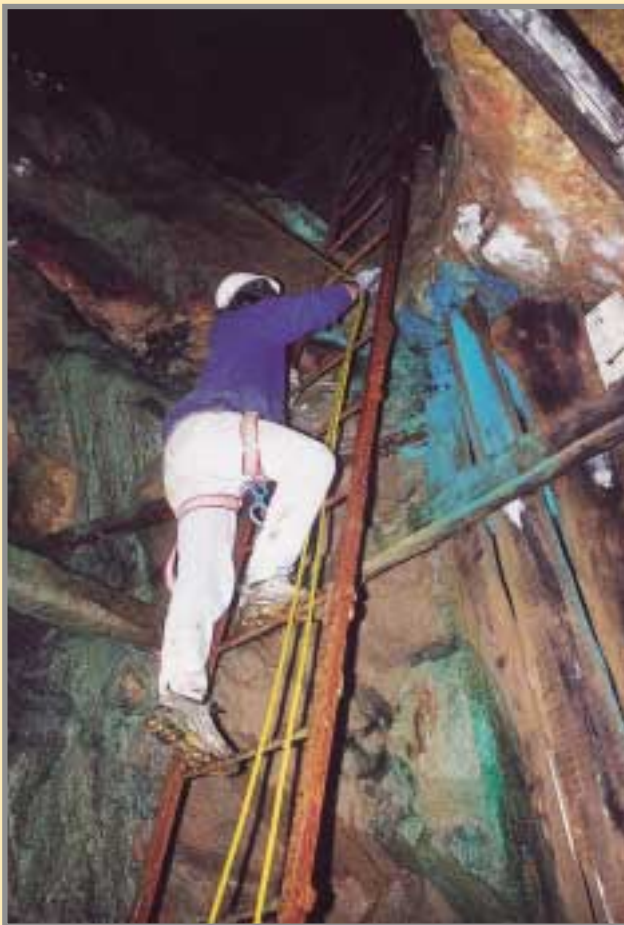
Colada cuprífera sobre la madera del contrapozo que conecta el nivel -18 de la mina con el -28. Mina Pilar, de Colmenarejo. Foto: L. Jordá, 2003.
