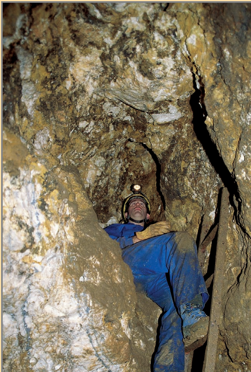
Enclave preciso de trabajos para piromorfita realizados entre agosto y octubre de 1997. El hueco no existía, se picó a marro y puntero. Obsérvense las vetillas de galena en la barita, en la proximidad del hastial de limonita (derecha), que es el que suele albergar las geodas de piromorfita. La escalera fue introducida en 1987. Foto: G. García, 4/2004.
