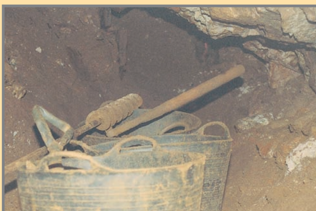
Con la pértiga "sacacorchos" se provocaban pequeños derrumbes de tierra para intentar crear una gatera que diera paso a la galería sobre filón donde estaban las piromorfitas. Foto: J. Peña, 6/1997.
