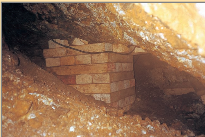
La llave de madera de 1 m x 70 cm construida por los buscadores es una verdadera fortificación minera. La seguridad es lo primero. Foto: J. Peña, 11/1998.
