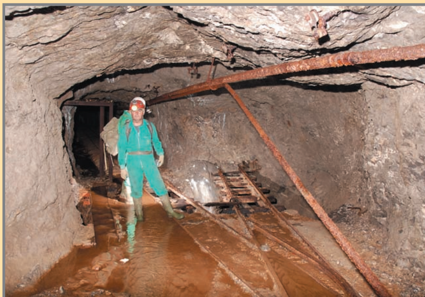
Coladero de mineral en el nivel 2º. En la imagen, cruce de vías para el basculado, cuneta de desagüe y tubo de aire comprimido. Foto: M. Hedrosa.
