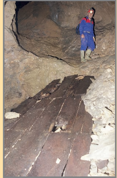
Antiguo deslizadero de mineral en una rampa de explotación de La Isidra. Foto: M. Hedrosa, 10/2006.
