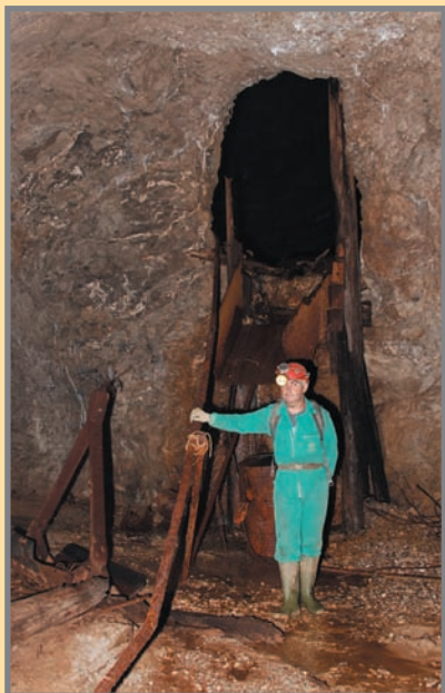
Restos de una piqueta de carga de una rampa de explotación en el 2º nivel. Foto: M. Hedrosa.
