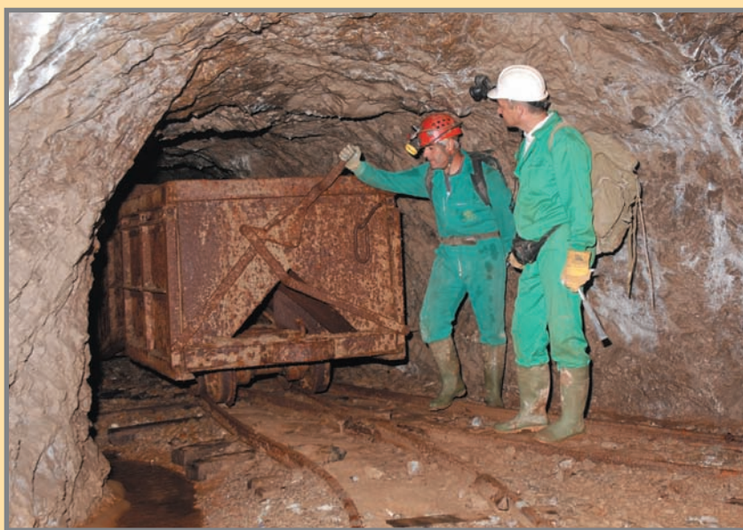
Nivel 3° de La Cuerre. Obsérvese el vagón de descarga lateral con el fondo inclinado 45°. En este nivel se encontraron las pisolitas de hidrocinquita de la página 65. Justo a la derecha está el segundo enganche del pozo y termina donde actualmente hay un hundimiento. Foto: M. Hedrosa.
