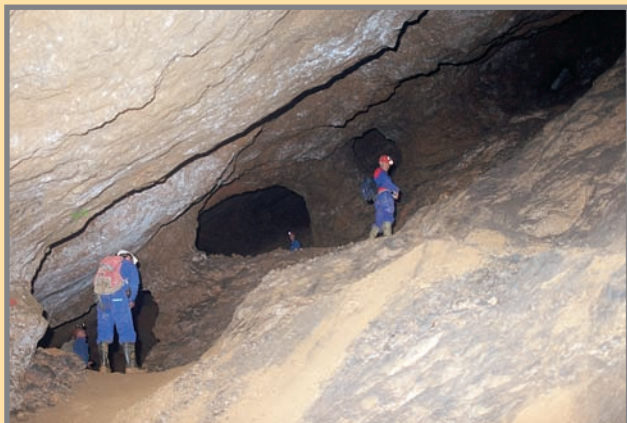
Zona de explotación en la mina Isidra, con columnas de sostenimiento. El mineral de esta zona es mixto de blenda y calaminas. Foto: M. Hedrosa, 10/2006.
