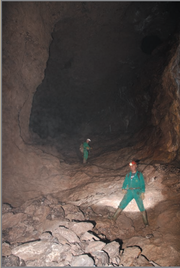
Rampa entre niveles 4º y 5º de La Cierre. Actualmente hay una altura de unos 14 m hasta el techo. En esta zona (que ahora se ve como roca desnuda), el agua ha arrastrado al menos 1,5 m de escombros que ha colmatado el 6º nivel, cerrando el acceso a una de las mejores zonas de geodas de La Florida. Foto: M. Hedrosa.
