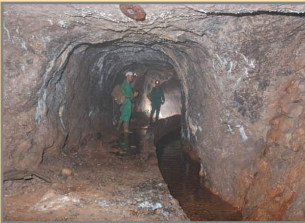
Al haber tapado el socavón de desagüe que había por debajo de las escombreras de La Cuerre, el agua de la cuneta interior vuelve hacia atrás, y penetra en la mina juntándose en la 5ª planta con el agua que viene del hundimiento en superficie, generando un caudal que ha causado importantes destrozos. Foto: M. Hedrosa.
