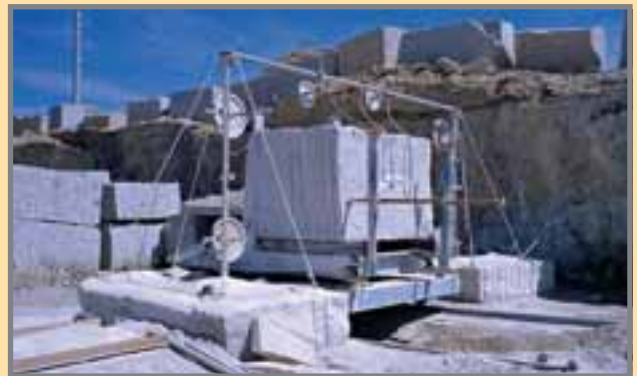
Inicios de la cantera de Valdemanco, de Granitos García. Aún no se empleaba apenas el corte con hilo, abriendo los frentes con lanza térmica y perforación con pólvora negra. Foto: F. Piña, 1993.
