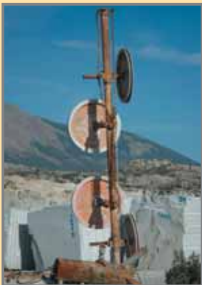
Pértiga para desvío de hilos diamantados. Foto: G. García, 1/2008.
