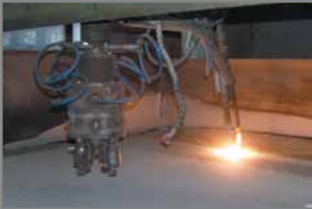
El "flameado" permite obtener acabados rugosos en las planchas. Taller de Granitos Carralón. Foto: J. González del Tánago.
