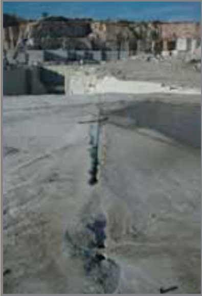
Ranura de un corte con hilo diamantado. Véanse los finos ripios de corte. Navazales. Foto: G. García, 1/2008.
