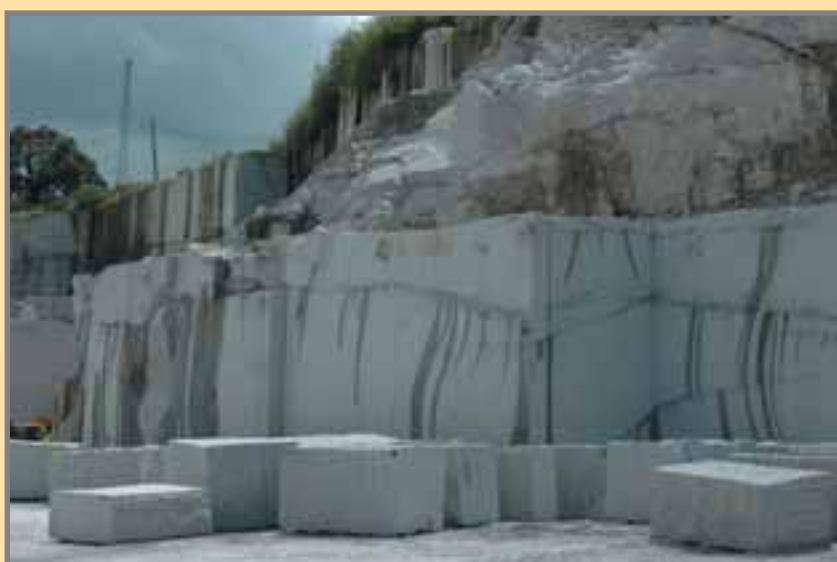
Vena pegmatítica en el frente. Obsérvese que la vena está fracturada y por ella se filtra el agua. Foto: A. Bueno, 1/2005.
