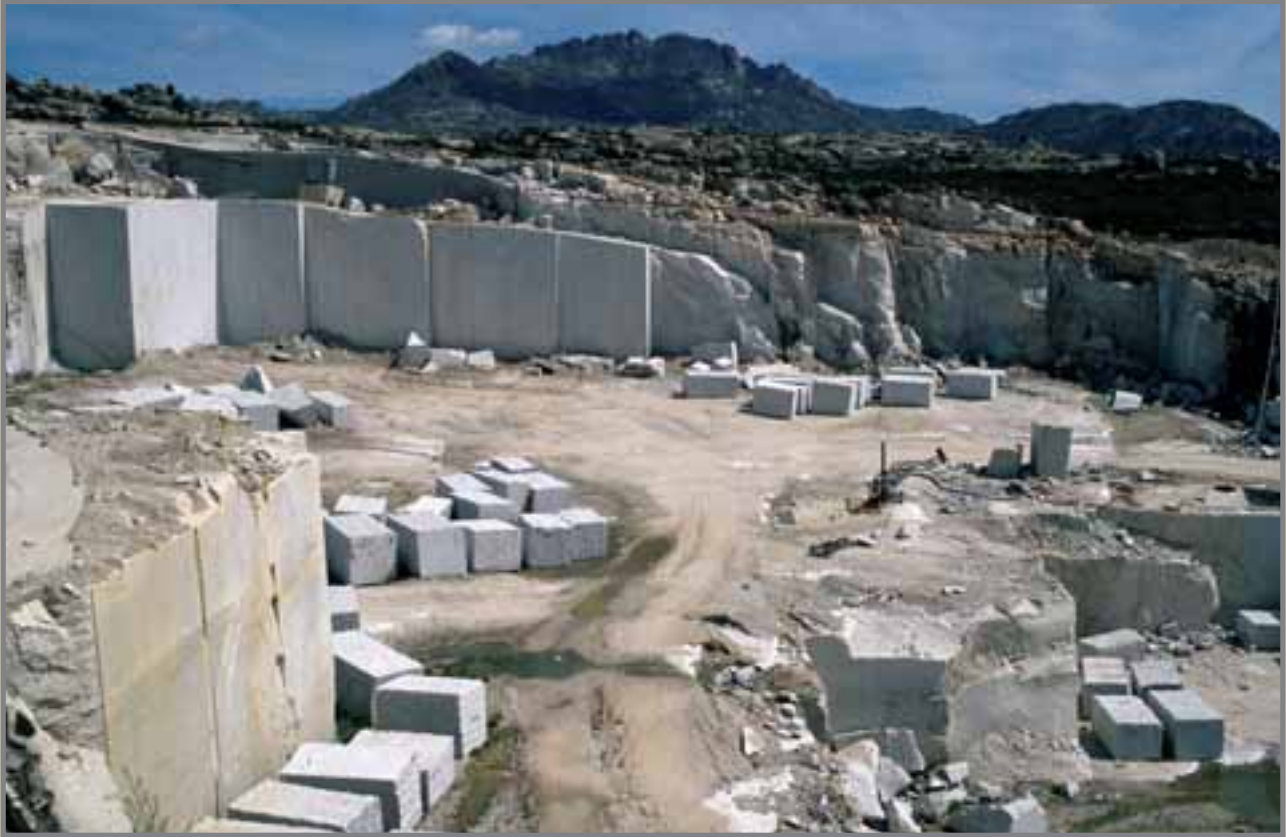
Vista parcial de un cantera con dos niveles de extracción. La utilización del hilo de diamante ha permitido reducir el polvo y el ruido en los trabajos, aumentando además el porcentaje de material aprovechado merced a la perfección de los planos de corte. Foto: J. González del Tánago.
