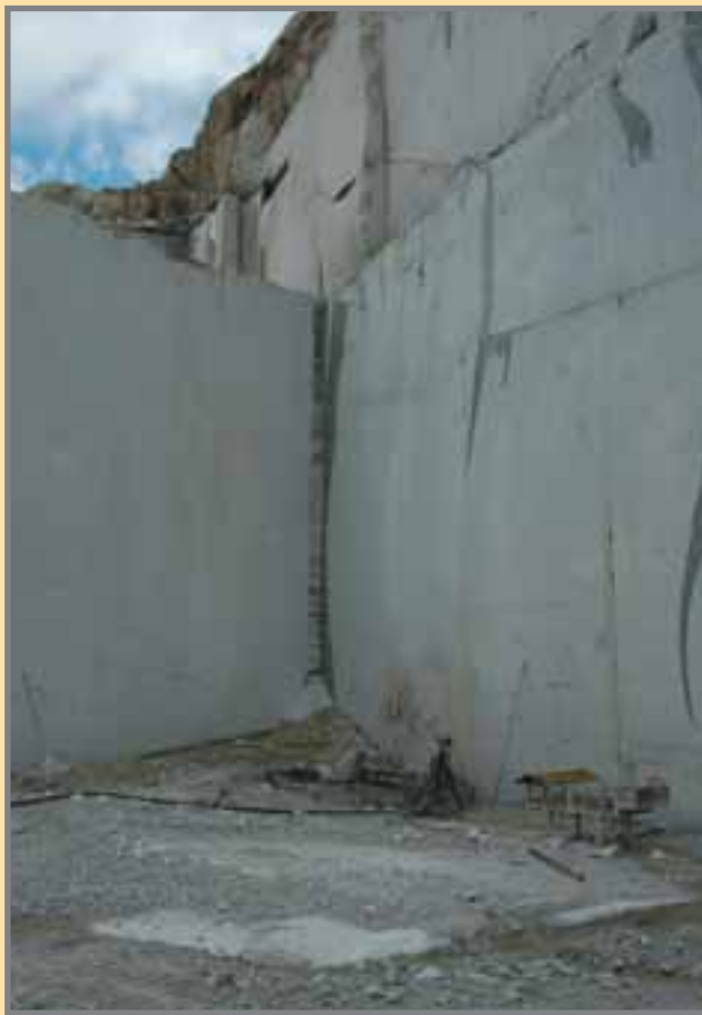
Preparación de taladro horizontal para la colocación del hilo de diamante. Foto: A. Bueno, 1/2005.
