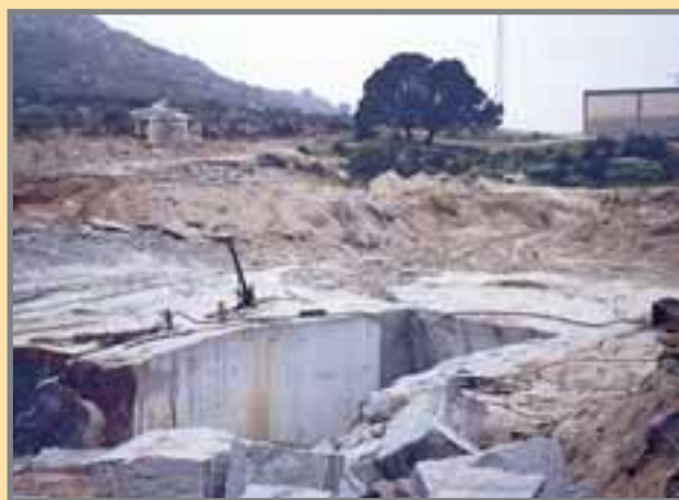
Inicios de la cantera de Navazales. Obsérvese la montera arenizada (lehm) del afloramiento, hasta llegar al granito fresco explotable. Foto: G. García, 2/1990.
