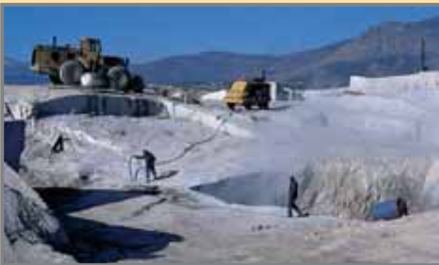
Ranura de un corte con hilo diamantado. Véanse los finos ripios de corte. Navazales. Foto: G. García, 1/2008.
