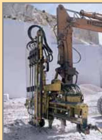
Apiladora de planchas en el taller de Granitos Carralón, en Cerceda. Foto: J. González del Tánago. Inferior derecha: detalle de un bastidor de perforación múltiple adaptado a una pala hidráulica.
