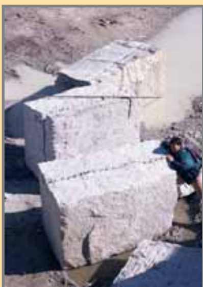
Recorte de bloques con barrenos y cuñas. Foto: G. García, 11/1991.
