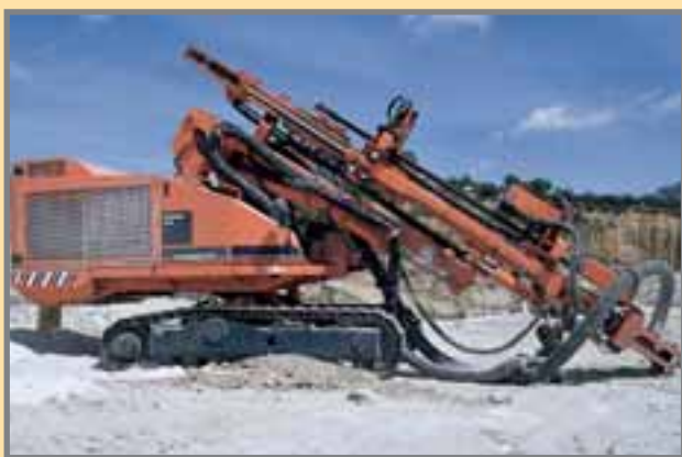
Carro perforador sobre orugas Tamrock. Foto: J. González del Tánago.
