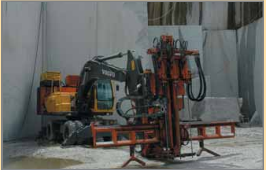
Las canteras de roca ornamental. El granito de Madrid: Perforadora múltiple montada sobre una pala de ruedas.
