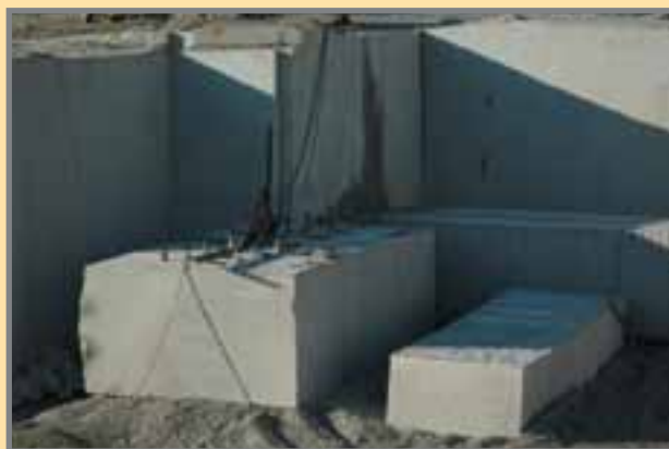
Proceso de disminución de tamaño del bloque. Se van cortando secciones que se vuelcan sobre un lecho de arena para evitar dañar la pieza. Foto: G. García, 1/2008.
