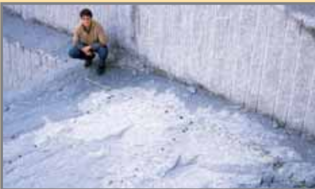
Superior: Trabajos de sección de bloques primarios con lanza térmica. Valdemanco. Foto: F. Marcos, 1993. Inferior: fraccionamiento de rachones con cordón detonante de 6 g. Foto: G. García, 11/1991.
