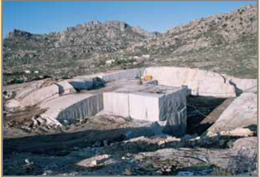
Inicios de la cantera de Valdemanco, de Granitos García. Aún no se empleaba apenas el corte con hilo, abriendo los frentes con lanza térmica y perforación con pólvora negra. Foto: F. Piña, 1993.
