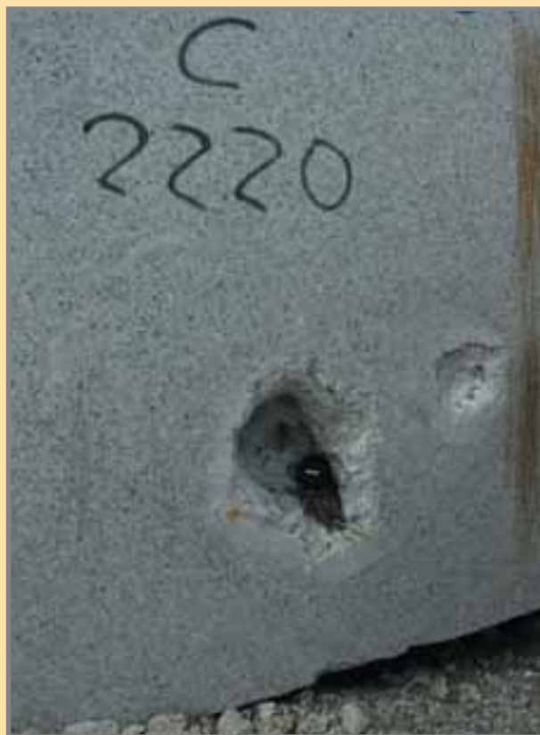
Cavidad miarolítica en un bloque de granito. La presencia de estos diferenciados impide el óptimo aprovechamiento del bloque. Foto: A. Bueno, 1/2005.
