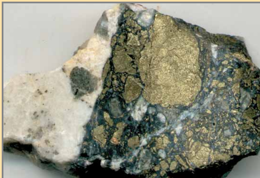
Muestra cortada de calcopirita, que permite apreciar la textura brechoide producida durante los rejuegos mecánicos del filón. Esta calcopirita es compleja, con inclusiones de especies minoritarias que aportan Ag, As, Ni y Ge. Foto: C. Menor.
