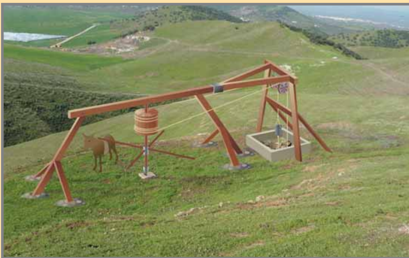
Superior: esquema de malacate, en Malo de Molina (1889). Inferior: recreación de malacate en los restos del Pozo "San Miguel" del Coto La Luz. Foto: Colectivo Arrayanes.
