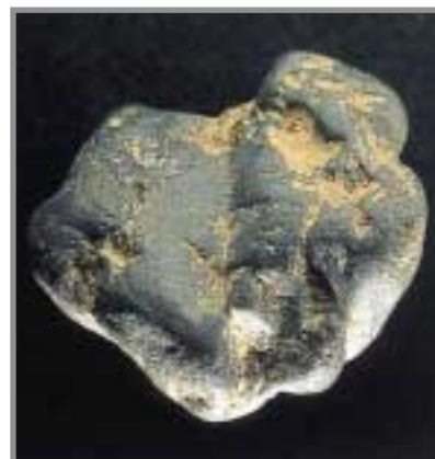
Macra de casiterita rodada aparecida en el concentrado. Procede del río Rubiós. Foto: F. Piña.
