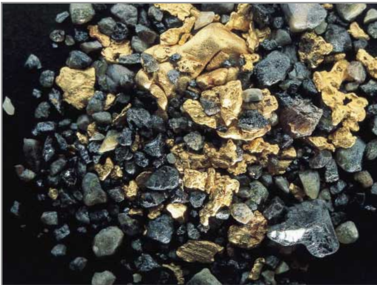
Concentrado de oro y casiterita recogido en una jornada de 8 horas de bateo en El Bardal, río Águeda (Navasfrías). Encuadre de 3 cm. Colección: G. García. Foto: F. Piña.
