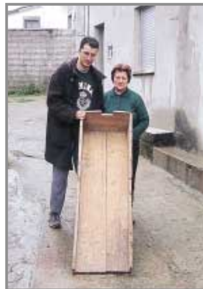
Canaleta de concentración de Esperanza Holgado. Esperanza trabajaba con su marido en concesiones de particulares, formando cuadrillas con otras personas. Cada semana tenían que entregar al dueño 1/2 kg de mineral. Foto: I. Orea.
