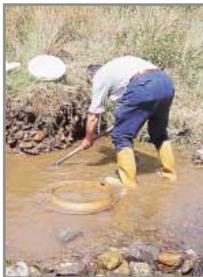
Rufino Orea recoge el material del lecho y lo precriba con una zaranda. Foto: I. Orea.
