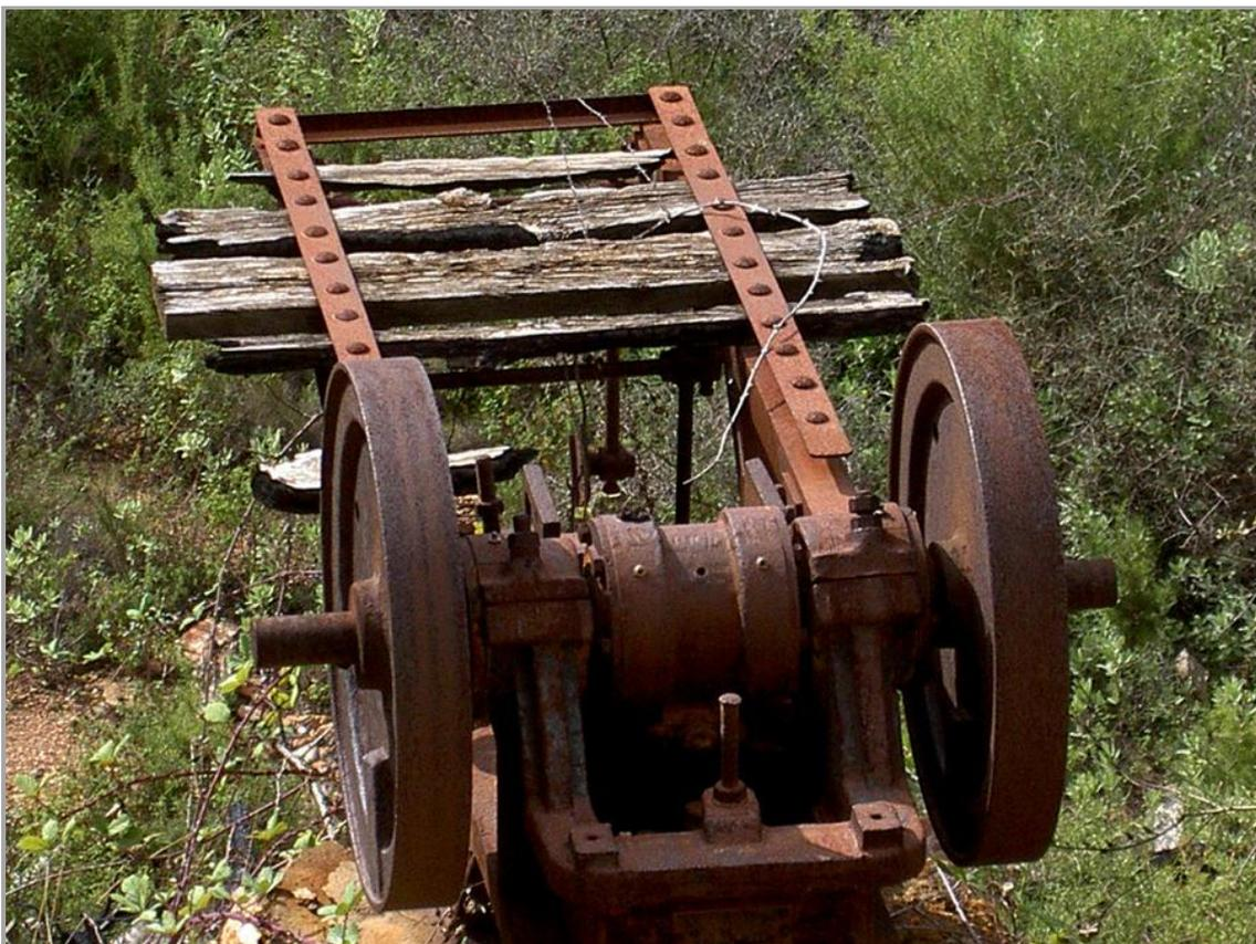
Figura 45: Trituradora de mándibulas (Fot. J.M. Sanchis, 2008)
