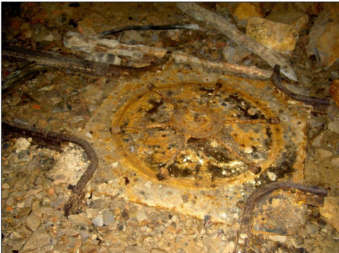
Figura 66: *Placa giratoria para vagonetas en la Galería Júpiter (Fot. J.M. Sanchis, 2008)*
