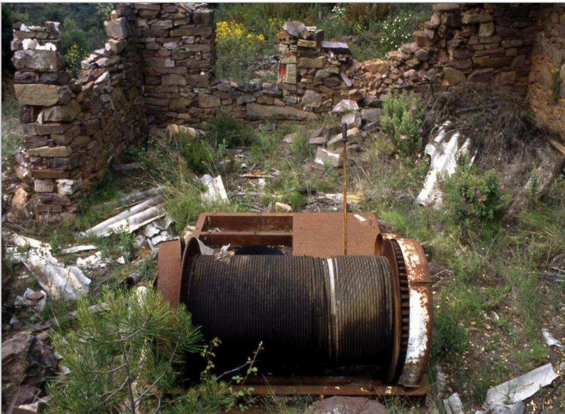
Figura 39: Máquina de extracción del pozo Manuel (Fot. J.M. Sanchis, 1998)
