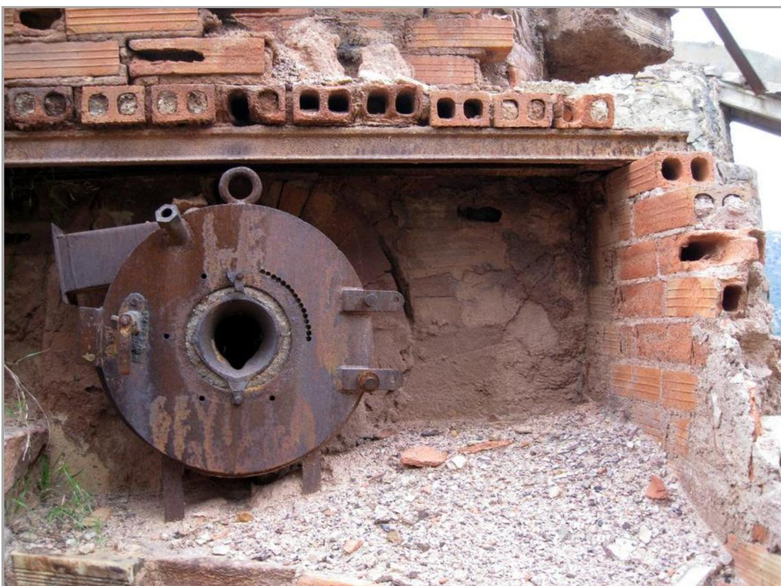
Figura 54: *Detalle del quemador de gas-oil (Fot. J.M. Sanchis, 2008)*
