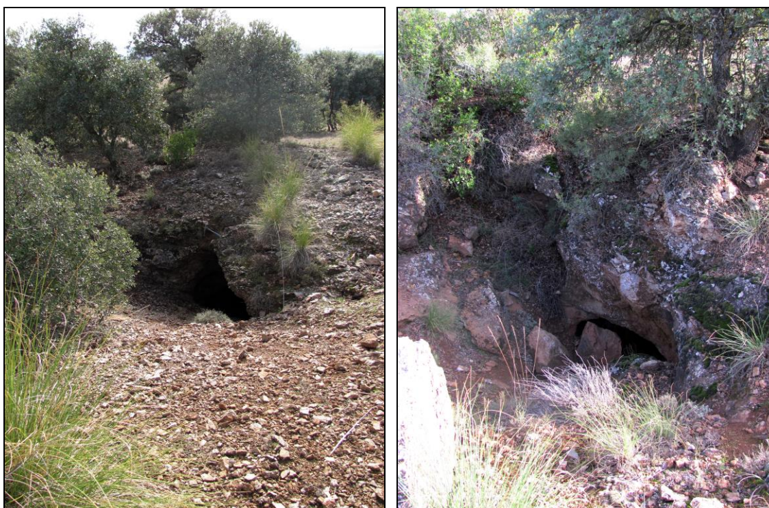
Figuras 88 y 89: Izquierda: Tercera labor en el Punto 24 con un pozo inclinado. Derecha: Cuarta labor en el Punto 24 con un socavón de poco desarrollo.
