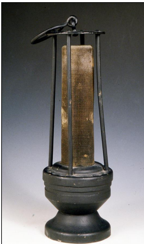
Figura 51 Lámpara Davy-Mueseler empleada en la época (Col. ETSIM. Fot. J.M. Sanchis)
