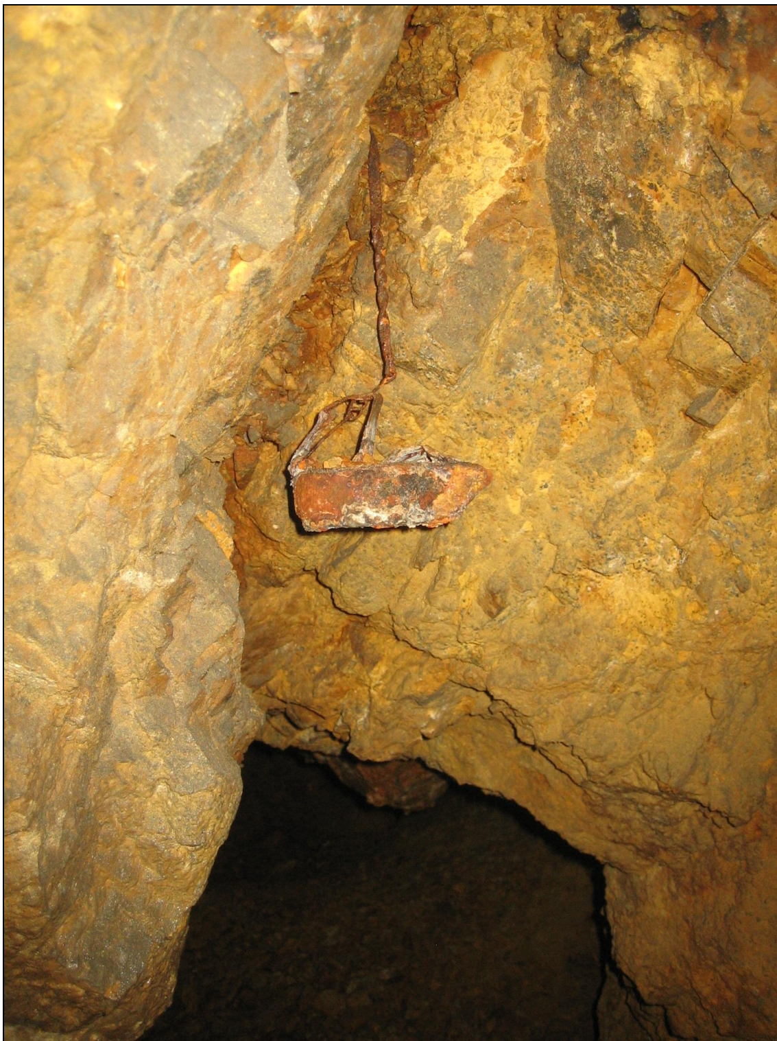
Figura 5: Candil tipo Almadén en el interior de una mina de plomo en el barranco de San Antonio el Alto (mina Dos Hermanas, Pinar de Bédar, 2010).
