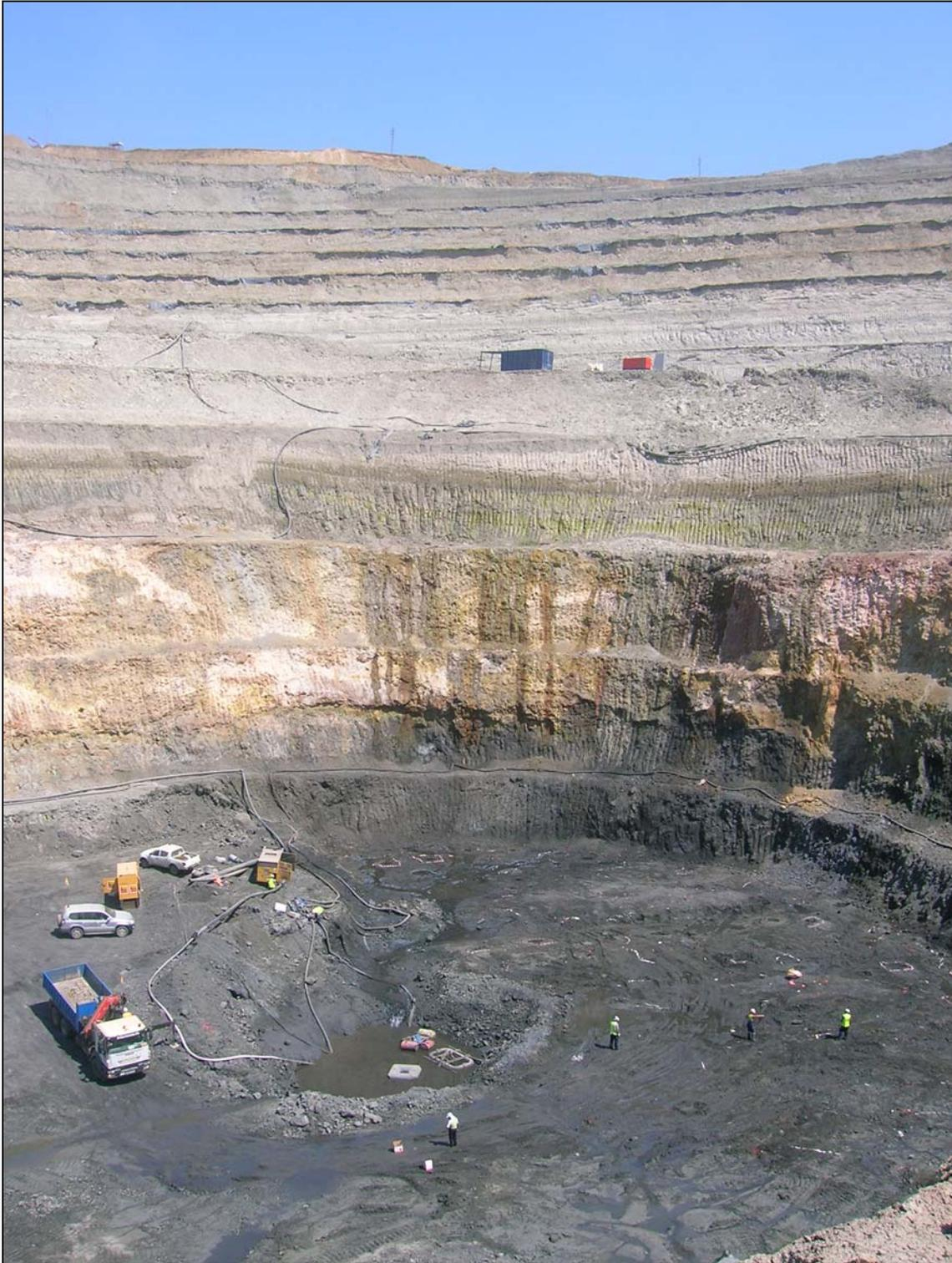
Figura 1: Acceso a la zona de enriquecimiento secundario en la fase 1 de la corta (color negro en el fondo de la imagen). Se observa el corte de la falla F1, de 15 m de salto, a cuya derecha en la imagen se sitúa el gossan siderítico.
