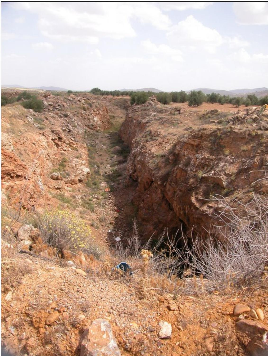
Figura 1: Mina "Perdiguera": el zanjón ha seguido la dirección de un filón de baritina y galena, cortando trabajos más antiguos formados por un pozo y galerías. Quedan restos de mineral en la pared derecha. Foto: C. Menor, junio 2006.
