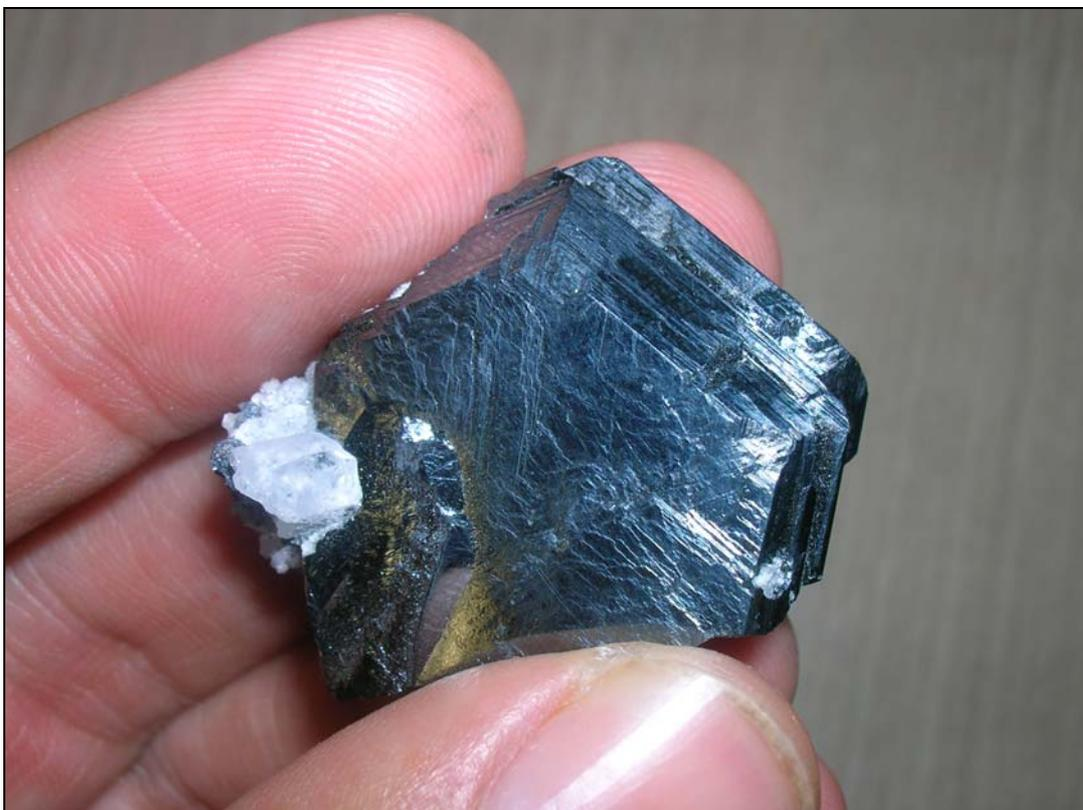
Figura 18: Ocasionalmente los cristales de calcosina alcanzan dimensiones notables. El de la imagen se desprendió de su matriz tras una voladura en el banco -135 (mayo de 2010).
