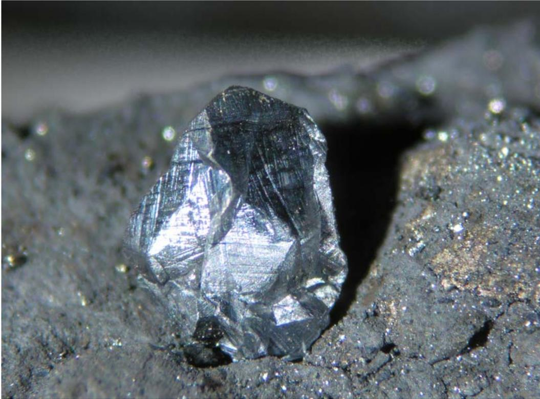
Figura 23: *Cristal de 4 mm de djurleíta sobre sulfuros de cobre de grano fino (Foto: Cesar Menor-Salvan).*
