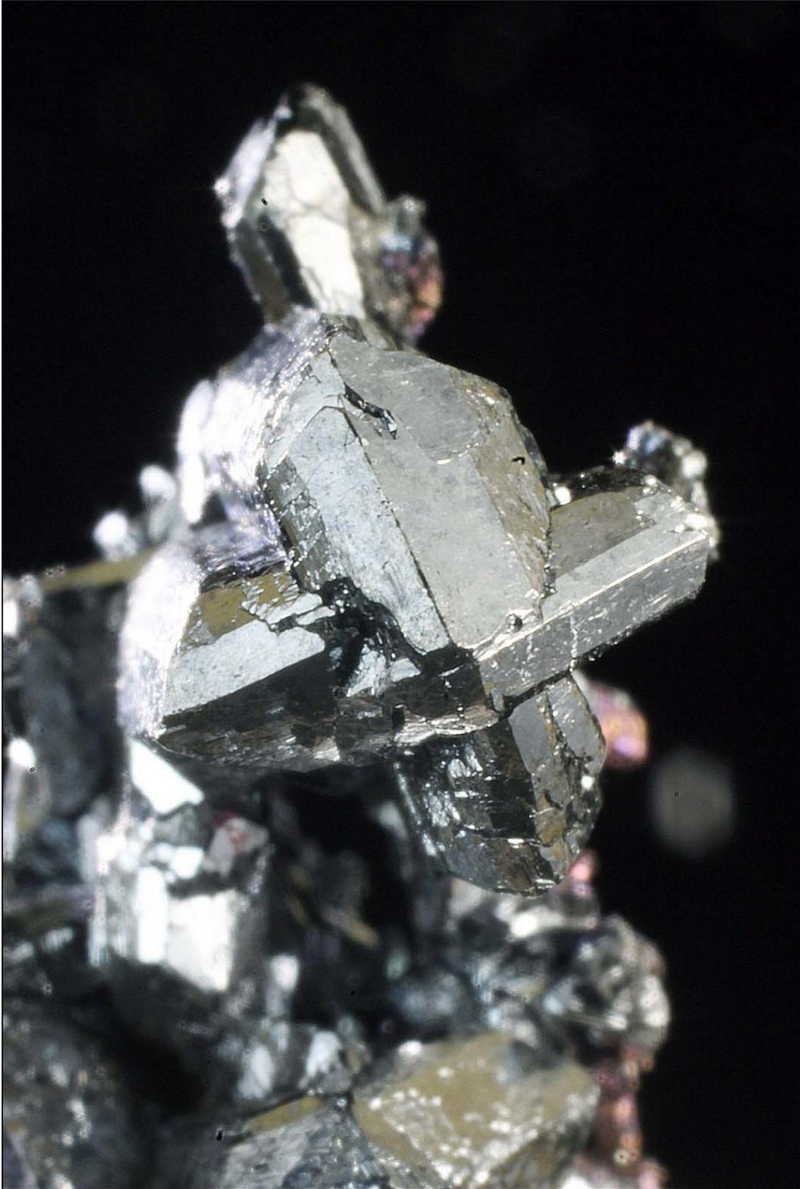
Figura 6: *Calcocina*. Macla de penetración en  $\{032\}$  de dos individuos hexagonales (Foto: J.M. Sanchis).
