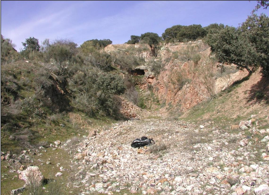
Figura 91: Inicio de la corta de la mina Cerro de San Pelayo. Se observa en primer plano parte de la escombrera donde predominan los cantos de cuarzo procedentes del "sierro". Fotografía: Santos Barrios (2007).
