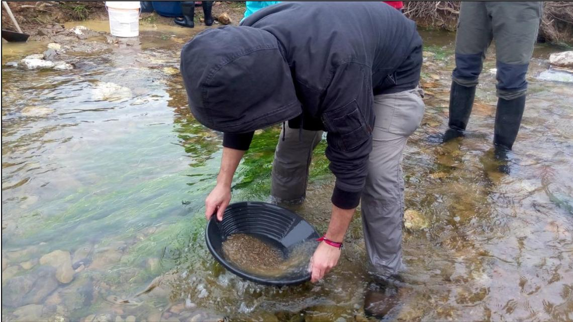
Figura 8: Reconcentración de los minerales atrapados en el canal de lavado con la batea.
