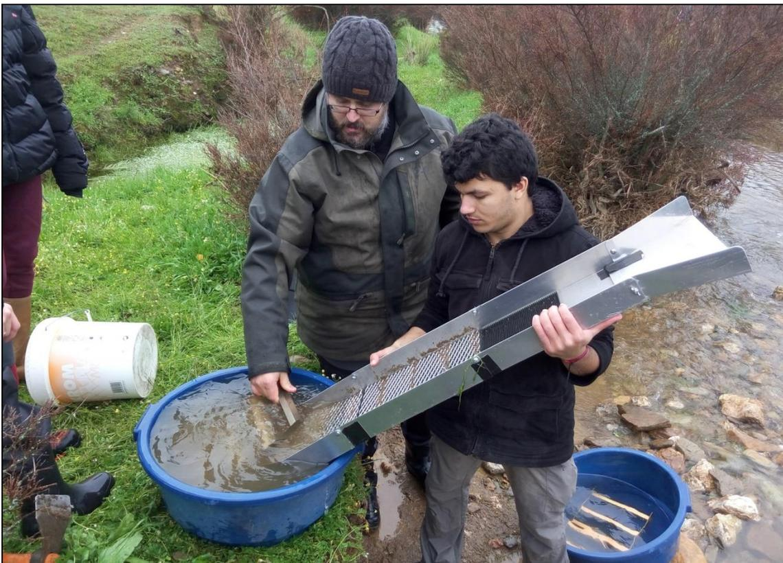
Figura 7: Recogida del material atrapado en las moquetas y rifles del canal de lavado.
