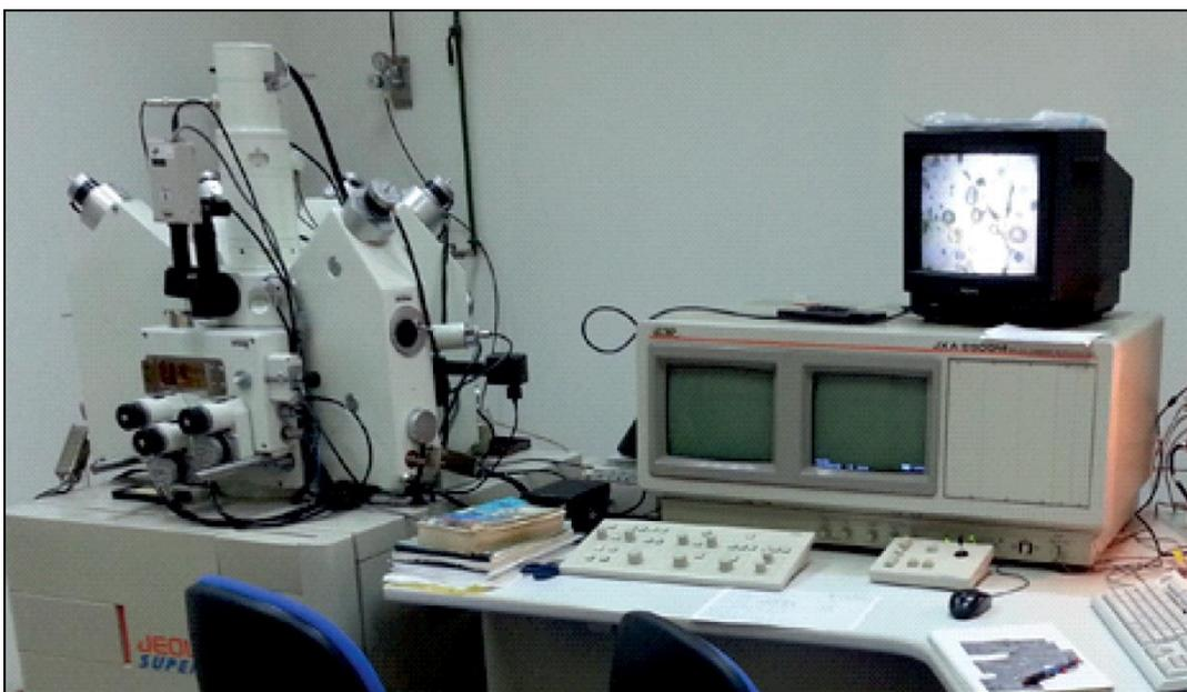
Figura 13: *Microsonda electrónica utilizada para el estudio de la textura interna y composición de las partículas de Au.*
