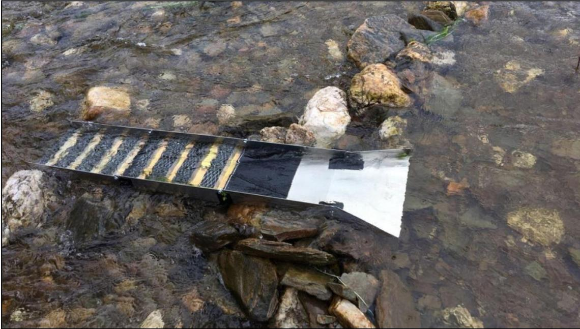
Figura 6: Canal de lavado colocado con inclinación y caudal de agua ideales para el lavado del material.
