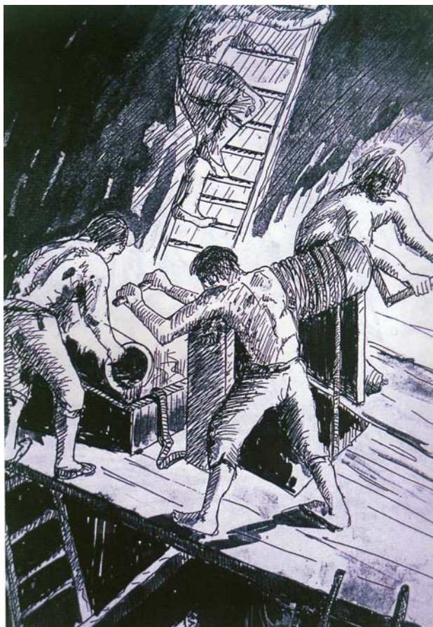
Figura 3: Desagüe de labores mineras con tornos de mano y zacas.
