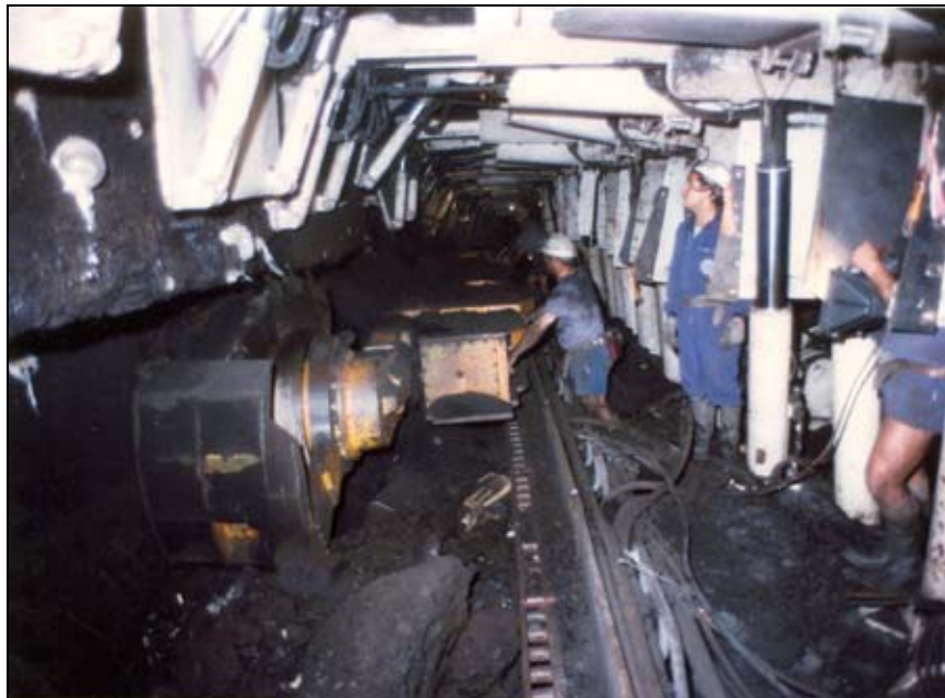
Tajo de pilas automarchantes en funcionamiento (hay 2 expuestas)
