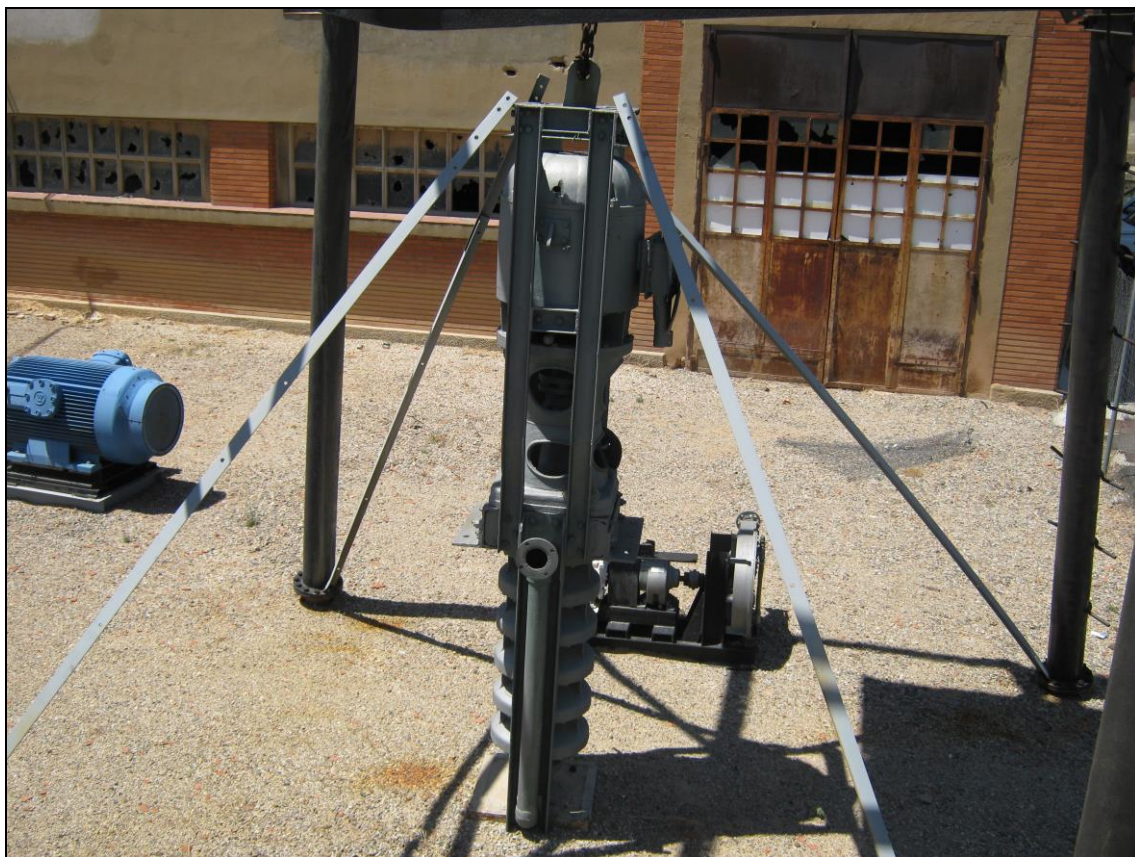
Figura 16: Bomba "DINA" utilizada en el desagüe del pozo, expuesta en la actualidad (Fot. Antonio Pizarro, 2012).
