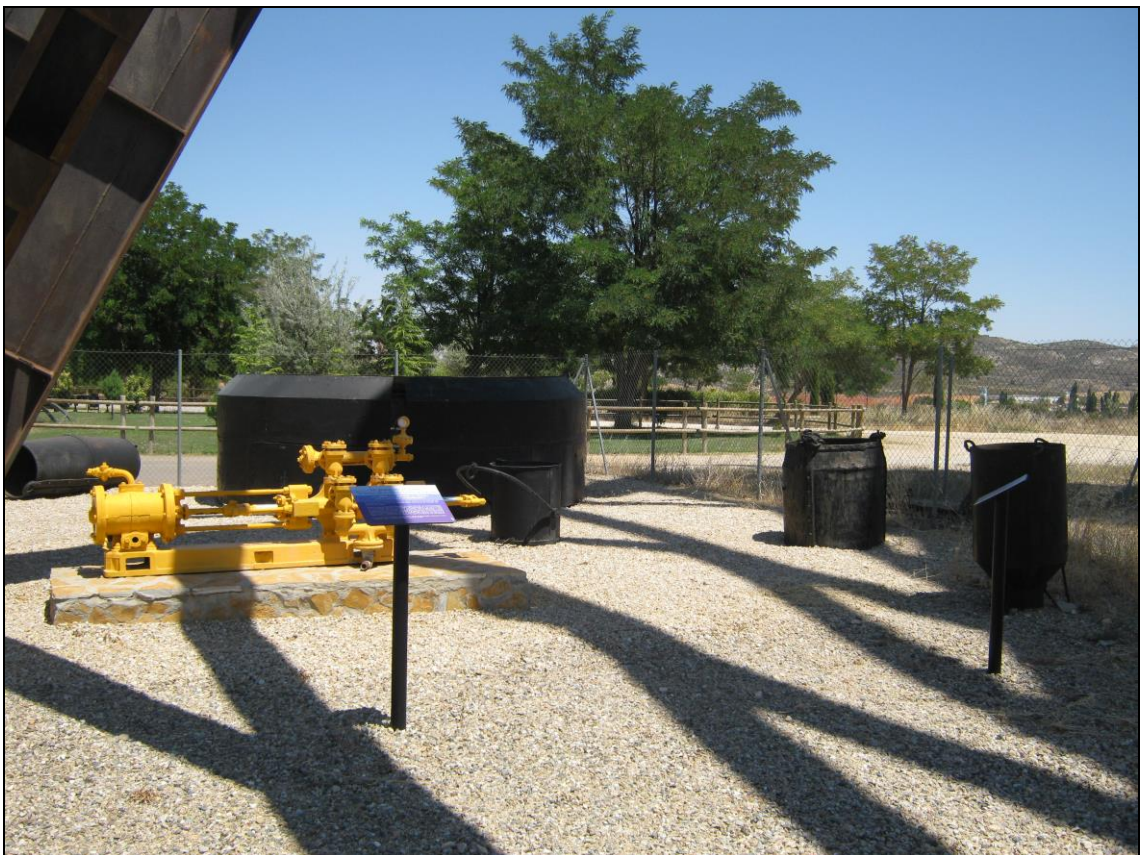
Figura 13: Elementos utilizados para hormigonar la caña del pozo: bomba inyectora, cincho, cubas, etc (Fot. Antonio Pizarro, 2012)
