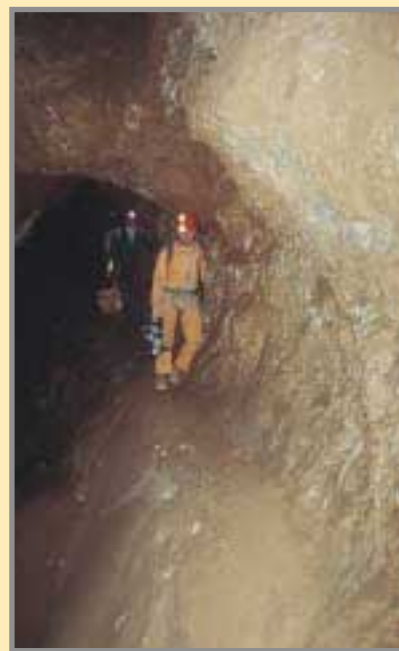
La verticalidad de la mineralización condiciona unos accesos algo estrechos a las zonas con restos de mineral, que son básicamente las llaves y los hastiales sin apurar. Foto: M. Hedrosa, 2001.
