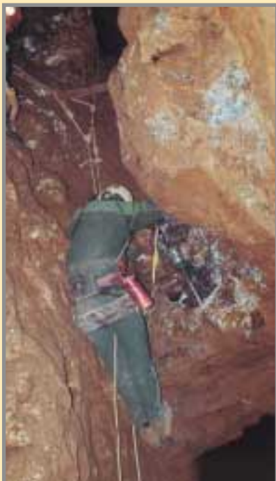
El martillo de gasolina facilita notablemente el trabajo de búsqueda de geodas, siempre dentro de la dificultad que suponen las condiciones de una veta verticalizada. Foto: M. Hedrosa, 2001.
