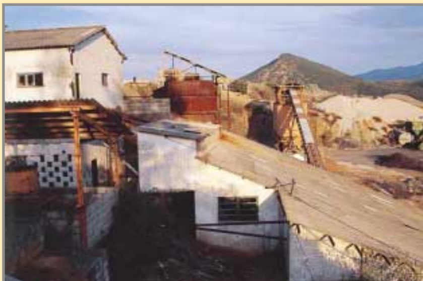
Vista parcial del lavadero. A la izquierda, sección de molienda, a la derecha, sección de flotación. Entre 1965 y 1972 se extrajeron 185.000 t de mineral (6,3 % Pb ; 3,2 % Zn ; 59 g/t Ag). Foto: F. Piña, 1998.
