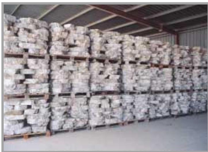
Palets de lonchas de 27 cm de espesor para la elaboración de placas. Tras el serrado de las placas, se escuadran y se calibran con los diferentes tamaños comerciales. Aserradero de "Canteras Soro, S.A.". Foto: G. García, 6/2002.
