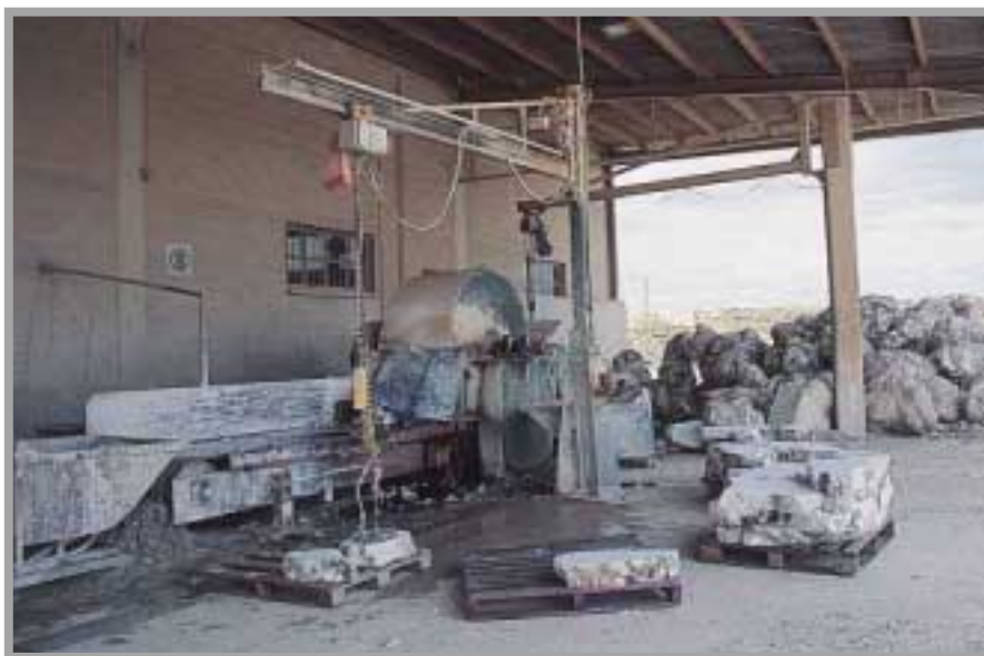
Sierra de disco donde se cortan los bolos de la cantera, acopiados detrás. Aserradero de "Canteras Soro, S.A.". Foto: G. García, 6/2002.
