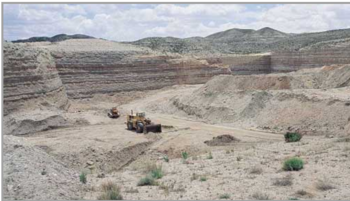
Laderas del suave relieve de la zona de "Patillas", seccionadas por las excavaciones. En el corte son visibles los niveles con alabastro explotable. La maquinaria necesaria para los trabajos es muy simple, dozer ripador y pala cargadora (con sus camiones). Foto: G. García, 6/2002.
