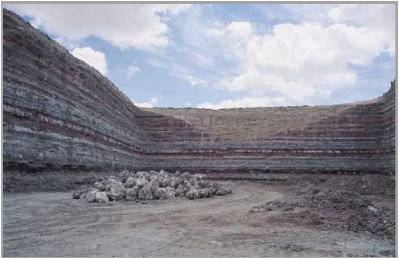
Típica cantera, con el acopio de bolos en su plaza. En el talud frontal, que corresponde a la pendiente de la ladera, se aprecia una erosión producida sobre la serie mineralizada y el material de relleno más moderno. Foto: G. García, 6/2002.
