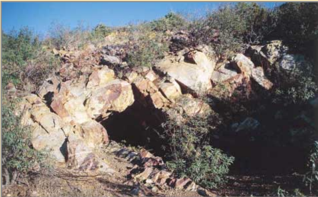
Socavón de la mina "Capitán". El avance se ha realizado siguiendo la estratificación de la cuarcita, de forma que la sección de la galería es inclinada (véase foto página derecha). A unas decenas de metros se corta el filón aurífero, que ha sido reconocido por una travesía en ambas direcciones. La escombrera es pequeña y poco atractiva para la búsqueda de oro nativo. Foto: G. García, 11/2001.
