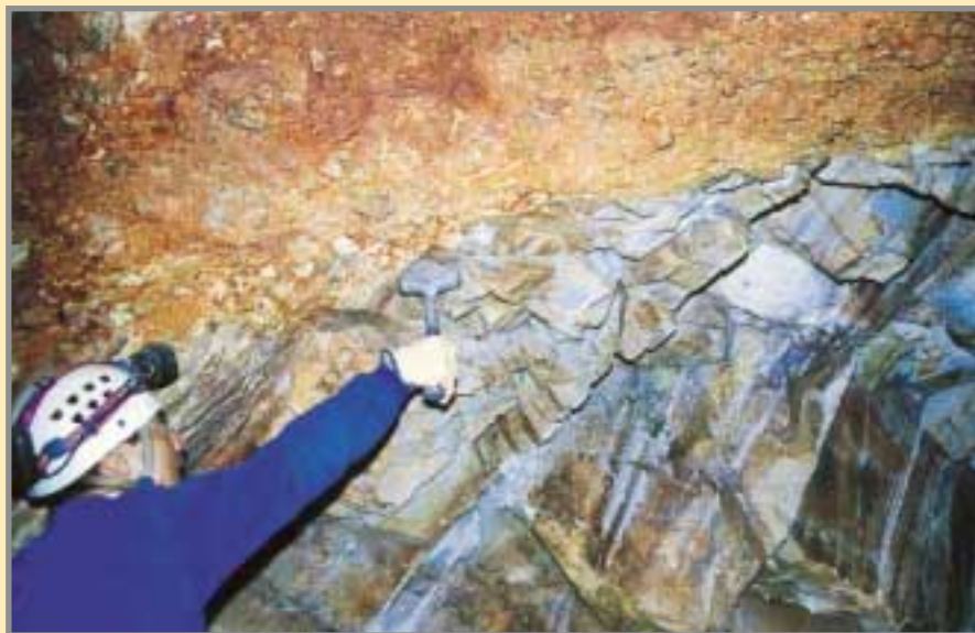
Un vistoso ejemplo de filones auríferos en bandas de cizalla. Contacto por falla entre el conglomerado y las Areniscas de Azorejo.
