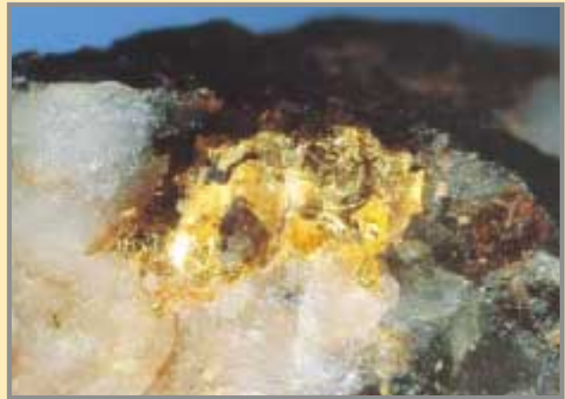
Foto superior: culatón sobre una rama del filón "Ingeniera". En este punto debió presentarse con una ley muy pobre, y en consecuencia se abandonó. Foto: G. García, 11/2001.
