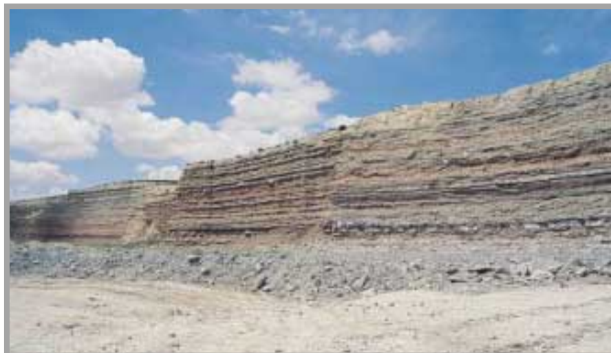
Arcillas grises ripadas en el piso de la cantera, antes de llegar al alabastro. La profundidad ripada se carga con palas frontales y se inicia un nuevo ripado del piso. Foto: G. García, 6/2002.
