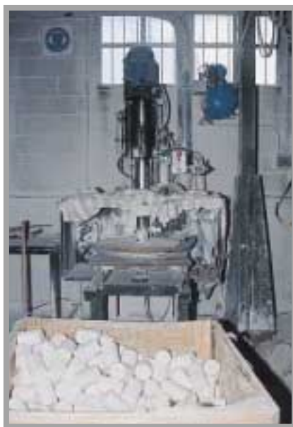
Fresadora para el atochado, produciendo piezas de 12 cm (8 de diámetro). Aserradero de "Canteras Soro, S.A.". Foto: G. García, 6/2002.
