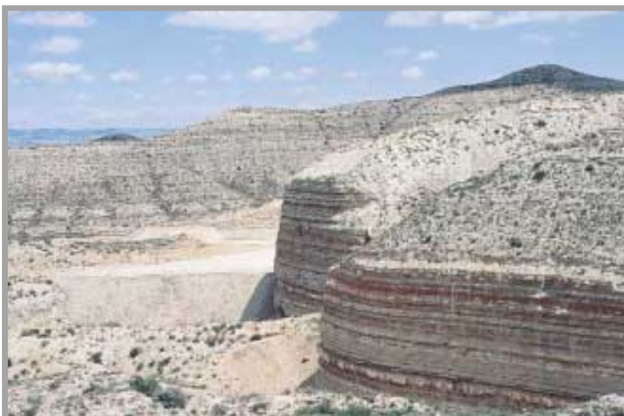
Vista de una zona con trabajos de restauración activos. La rala vegetación de la zona coloniza rápidamente los rellenos. Como se observa en la foto, los taludes admiten pendientes prácticamente verticales. Foto: G. García, 6/2002.
