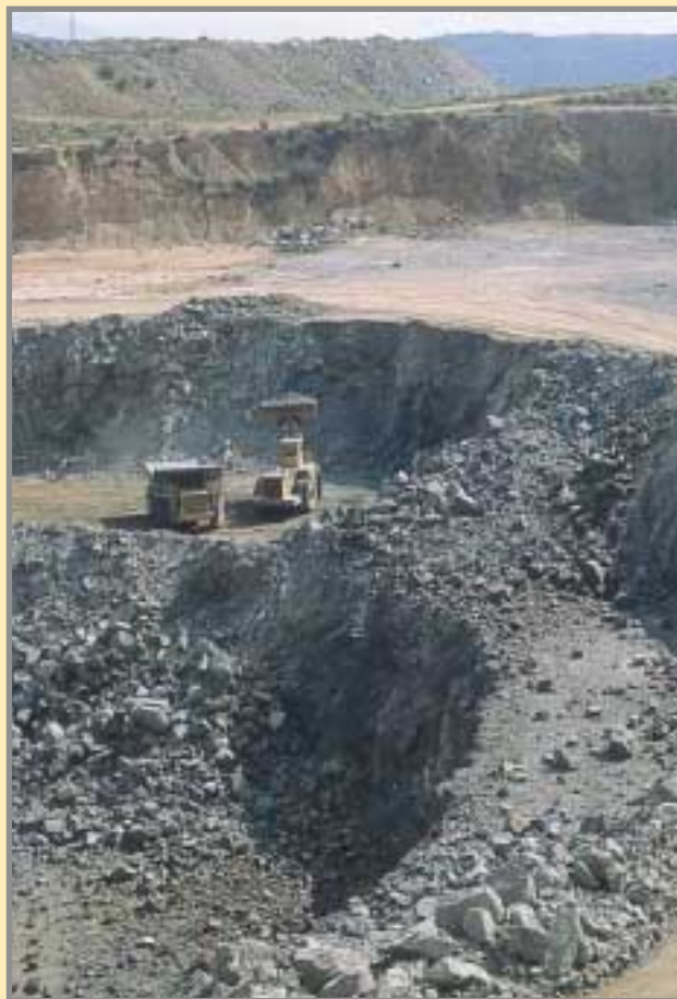
CAT-992 en trabajos de carga de estéril (roca intrusiva de color claro) para limpieza del skarn mineralizado, en el extremo sureste de la corta "Manuel". Foto: F. Palero.
