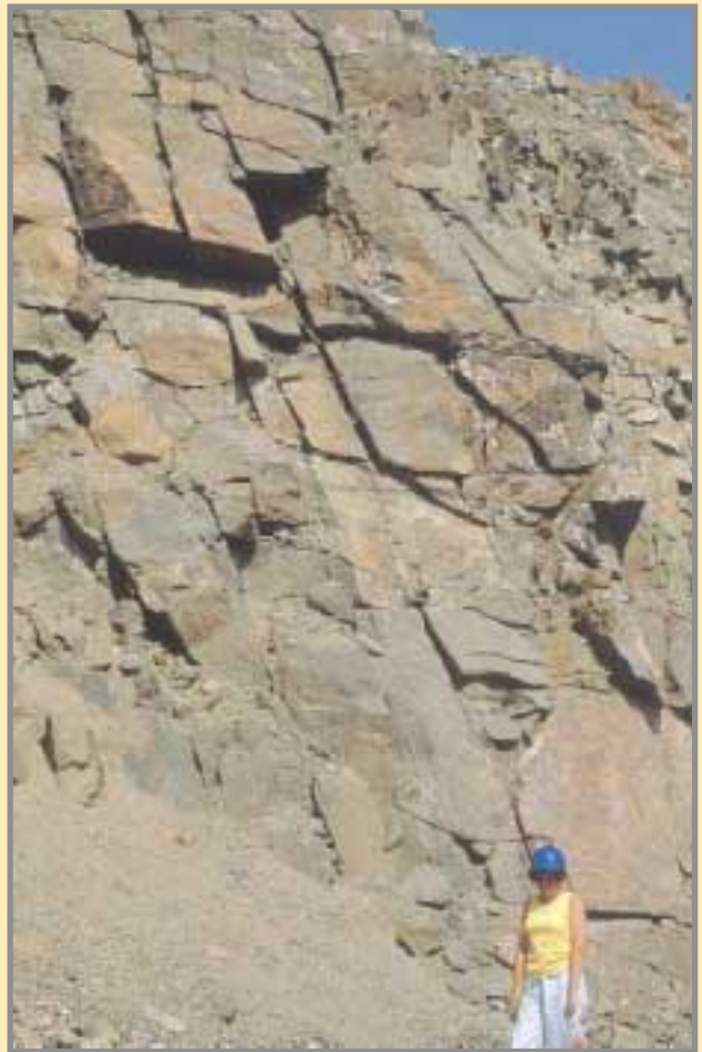
Masa de magnetita masiva, mostrando su fracturación. Su potencia media es de 35 m, aunque localmente llega a alcanzar 130 m, incluyendo algunas esterilidades. Foto: F. Palero.
