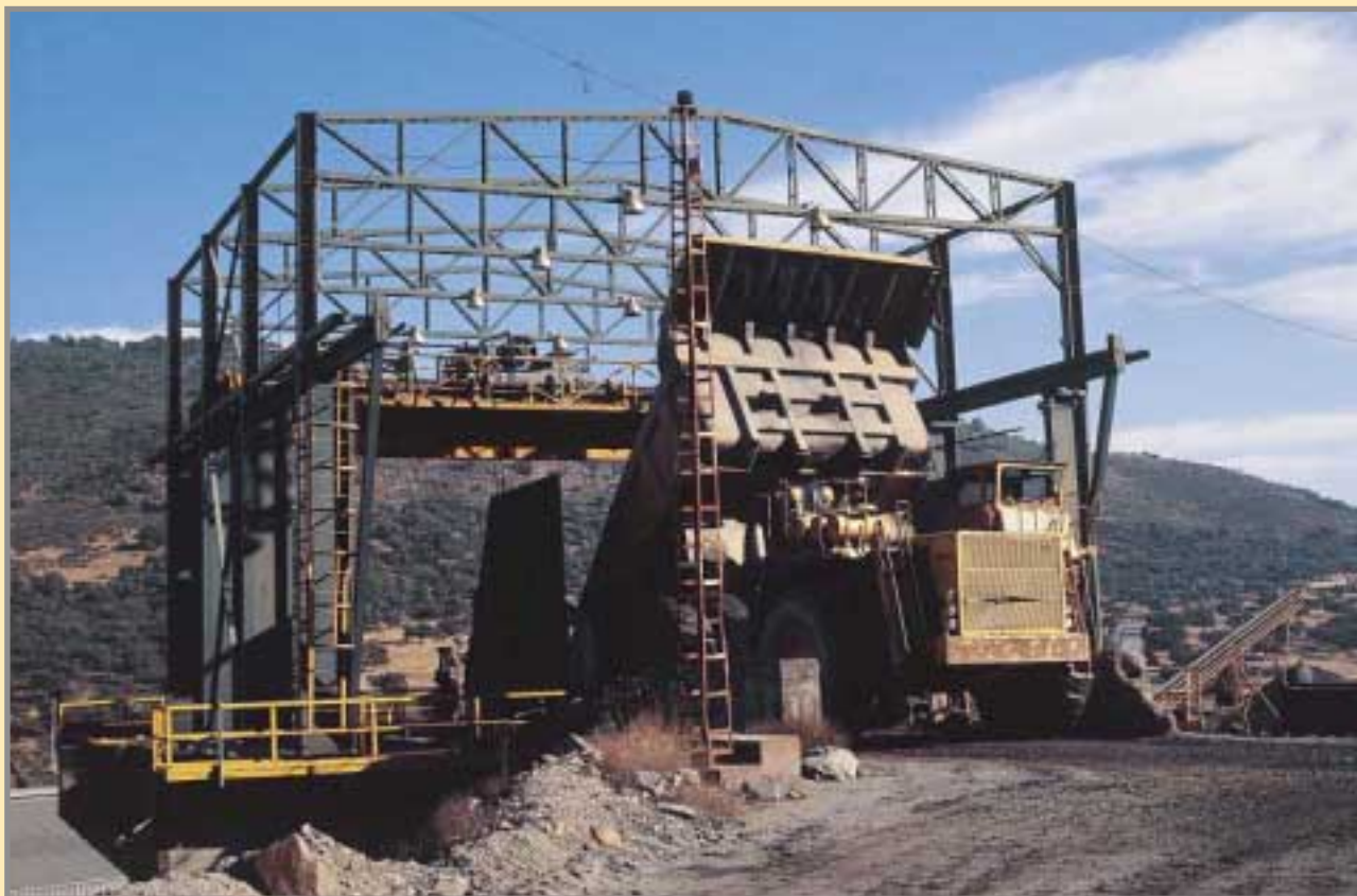
Dúmper basculando a la entrada de la trituración primaria (hidrocono). Foto: G. García, 11/98.
