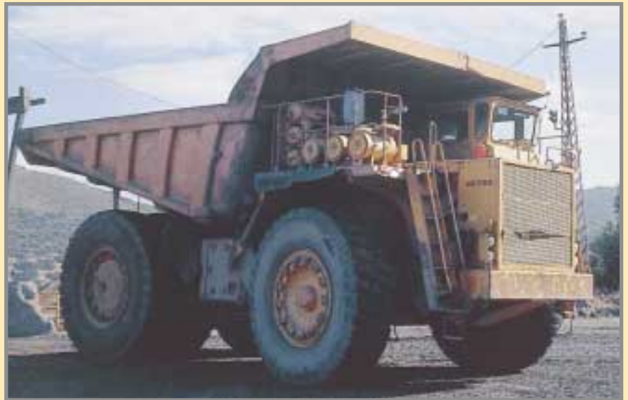
Una operación minera que comenzó subterránea: Dúmper Komatsu HD-785 de 78 t a la salida de trituración.
