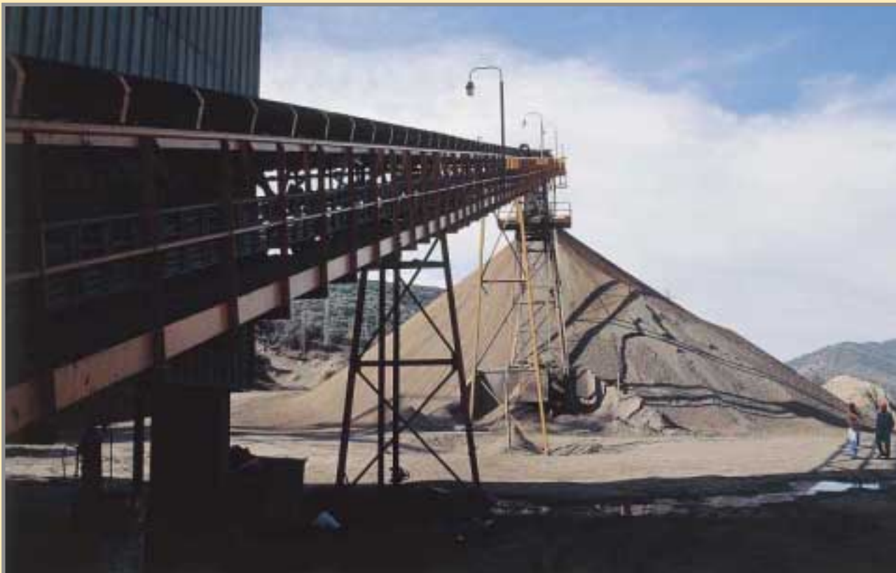
Cinta de salida a acopio de mineral 0 mm - 30 mm. Foto: G. García, 11/1998.
