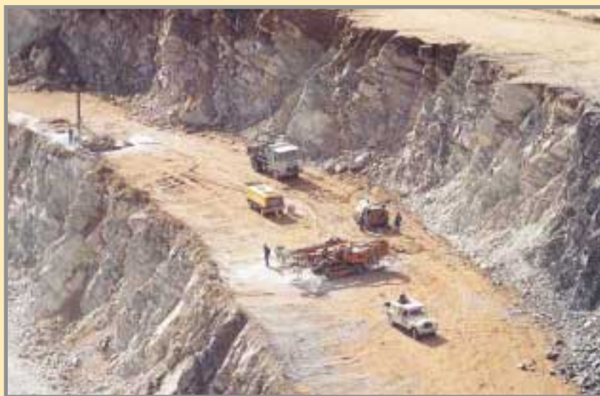
Trabajos de perforación en la masa de granodiorita, para ampliación de la corta en 1995. Foto: G. García.
