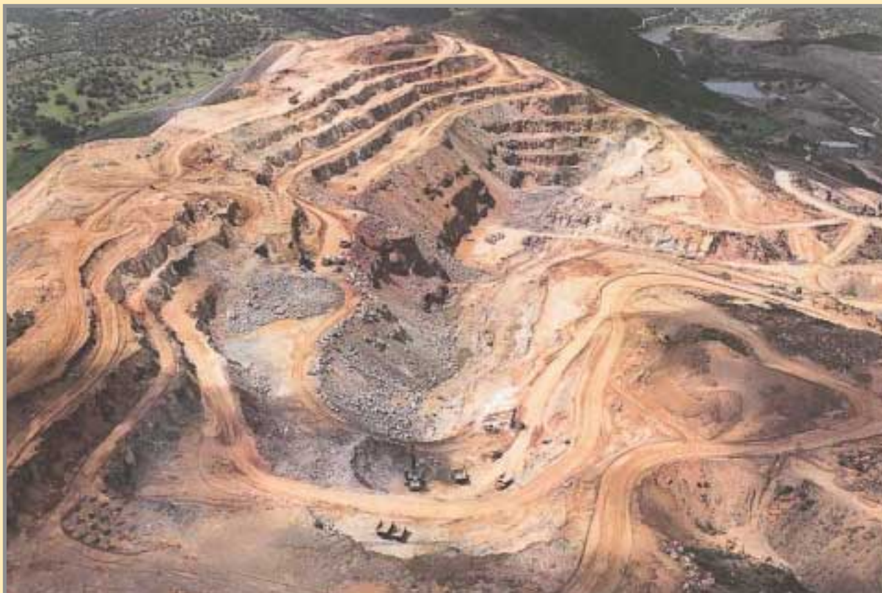
Imagen aérea de la corta de explotación del skarn de Minas de Cala, hacia 1992. Perspectiva desde el sureste hacia el noroeste. En primer término, trabajos de la corta “Mercedes”, con una corrida de 650 m y un gossan cobrizo. Al fondo, la corta “Manuel”, con 550 m de longitud de la masa de magnetita (color oscuro, en la parte central de la excavación). Foto: cortesía de Presur, S.A.
