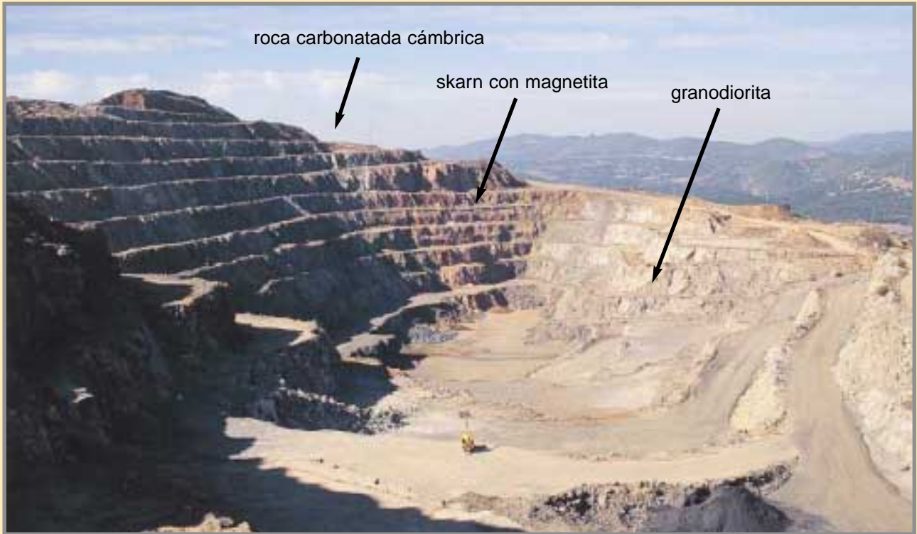
La corta "Manuel-Mercedes", con el talud de calizas y dolomías cámbricas (izquierda de la imagen), subiendo de cota la Sierra del Castillejo. A la derecha de la foto, intrusión de granodioritas. En el contacto, el skarn mineralizado. Foto: G. García, 11/1998.
