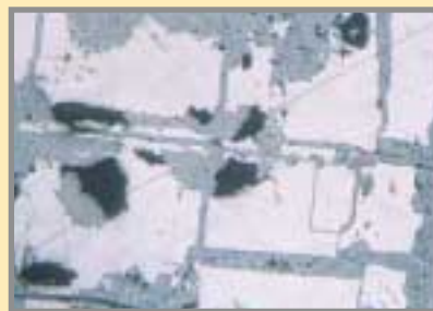
Alteración de galena a cerusita, siguiendo los planos de exfoliación. Microscopio x 200. Foto: F. Palero.
