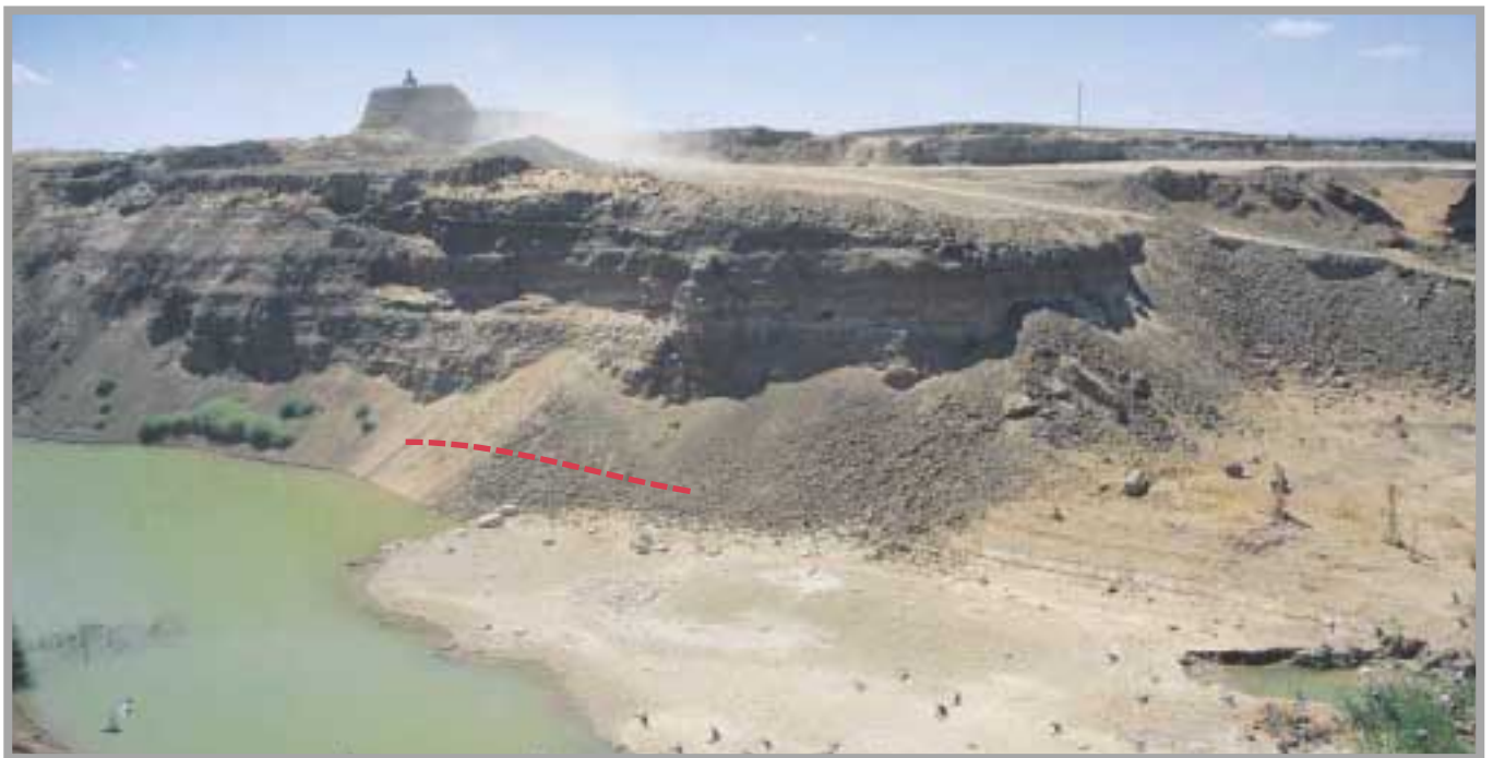
Vértice La Serna y explotaciones de arcilla. El hoyo inundado de la parte derecha de la foto corresponde a una excavación realizada para llegar al nivel con aragonito. Se ha señalado con línea discontinua roja la cota aproximada del nivel. Foto: G. García, 11/1999.
