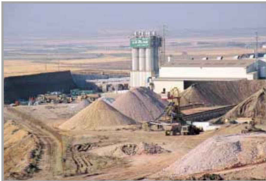
La base de la pasta cerámica es una mezcla variable de arcilla plástica y arena desengrasante. Las propiedades de uno y otro son distintas de unas zonas a otras, y por ello las fábricas cuentan con laboratorios de ensayo donde se experimenta con distintas proporciones de mezcla y la aportación de aditivos. En la foto, tolva-desmenuzador y apiladora móvil para la realización de acopios. Foto: G. García, 8/2002.
