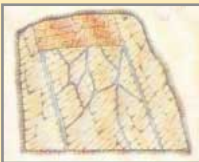
Filón "San Alberto". Frente del Piso 14 a 200 metros al oeste del crucero de San Juan. Las vetas de galena están dispersas en cuarzo blanquecino. El material naranja del techo es relleno. Dibujo: Hervada, 1894.
