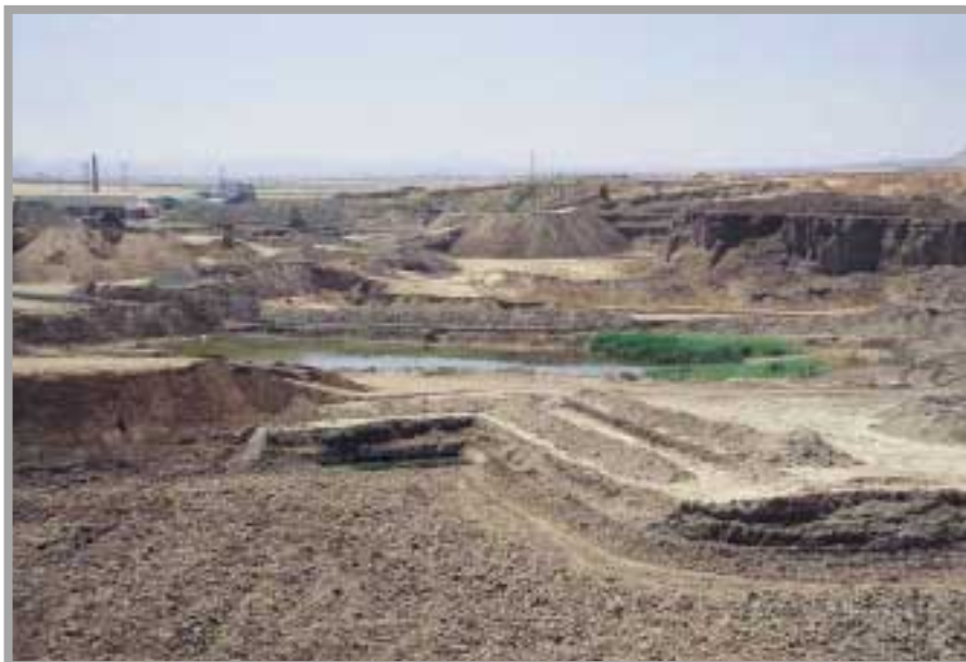
El envejecimiento de la arcilla en parvas a la intemperie mejora la plasticidad de la materia prima y la resistencia en seco de las piezas. La mayor parte de las arcillas tienen que ser “desbravadas” (inducir la fragmentación espontánea) para facilitar su extrusión. Foto: G. García, 11/1999.
