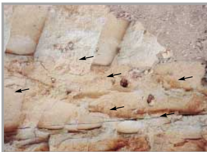
Nódulos con aragonito in situ, en un frente de cantera. Véanse las marcas de los dientes de la pala cargadora y el despegue entre capas. Foto: G. García, 8/2003.
