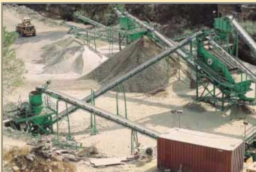
Planta de trituración y clasificación de "Austral", trabajando a comienzos de los años 90. Un volumen importante de escombreras fue procesado por esta instalación. Foto: F. Piña.
