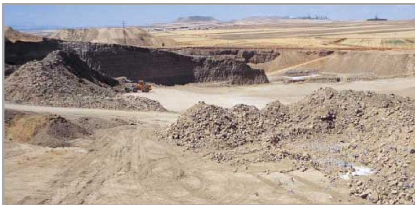
Apilado y carga de la arcilla oreada. Al fondo se distinguen las instalaciones de la fábrica de cementos de Asland y el Cerro del Águila, en Villaluenga. Foto: G. García, 11/1999.
