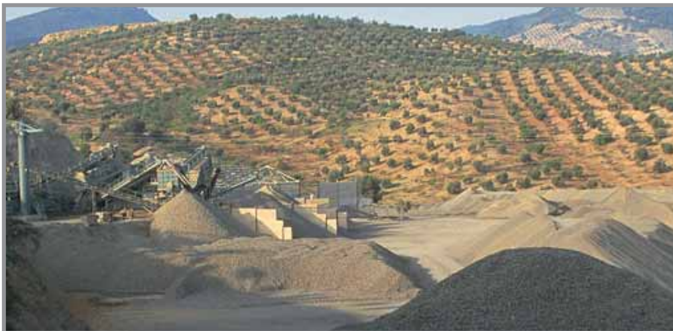
Diferentes acopios de las granulometrías comerciales de árido se disponen en la plaza de la cantera Oficarsa. Foto: G. García, 2003.
