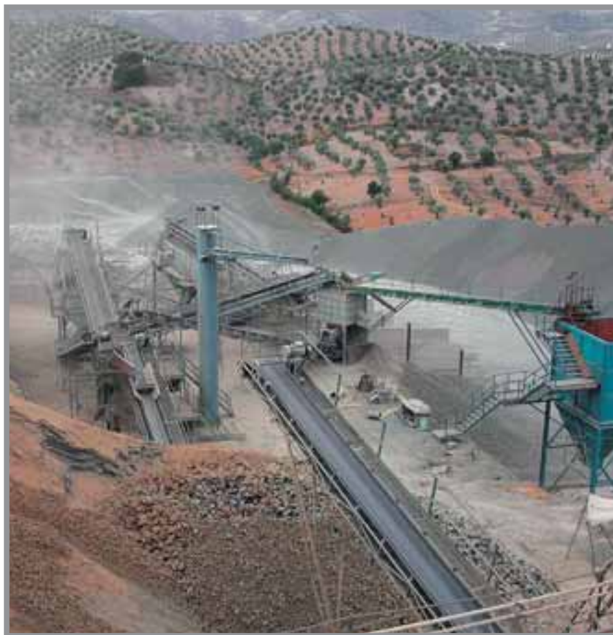
Perspectiva parcial de la instalación de trituración y clasificación situada a pie de cantera, para la preparación de las granulometrias comerciales. Foto: F. Palero, 2005.
