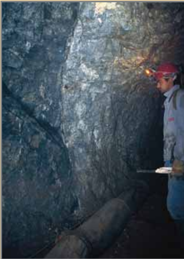
Contacto por falla entre la caliza (izquierda) y la dolomía. Foto: G. García, 4ª Planta, 1995.
