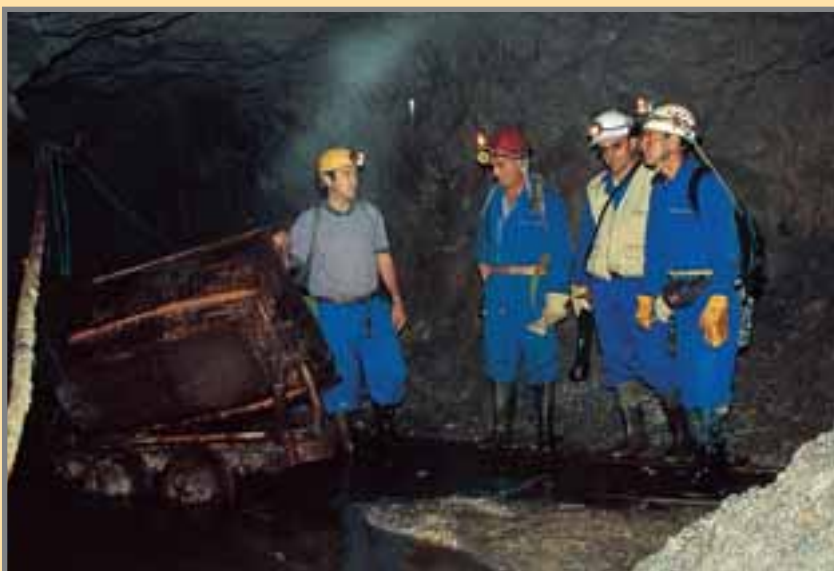
Había vagones de 800 kg y de 1 t que se transportaban manualmente en los niveles hasta embarcarlos en la jaula. Una vez subidos hasta el 1º nivel, su transporte hasta la tolva de la planta se hacía mediante una locomotora de baterías AL-7 Kalmar en trenes de 8 a 12 vagones. Foto: G. García, 9/2002.
