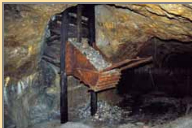
Tolva de carga de mineral en la galería de transporte de 4ª Planta. Foto: G. García, 2003.
