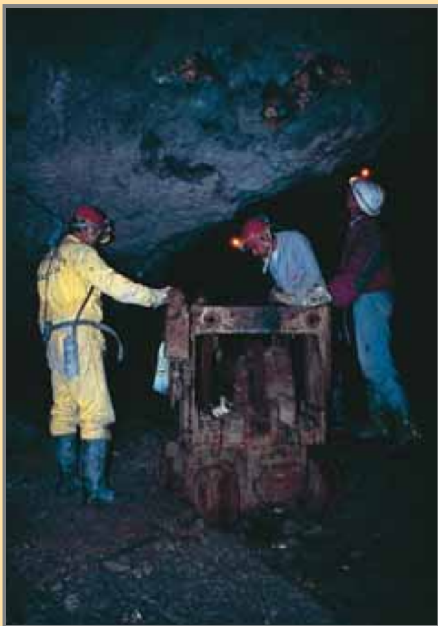
Pala neumática Salzgitter HL-100 en la 1ª Planta, debajo de un manchón de blenda. El aire comprimido se generaba por un compresor eléctrico estacionario de pistón AR-1 Atlas Copco, instalado en la boca del socavón general. Foto: G. García, 1995.
