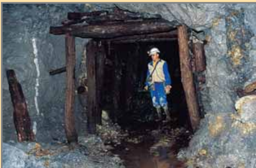
Fortificación con cuadros de madera en la 1ª Planta. La parte derecha de roca fresca deja ver mineralización. Foto: G. García.
