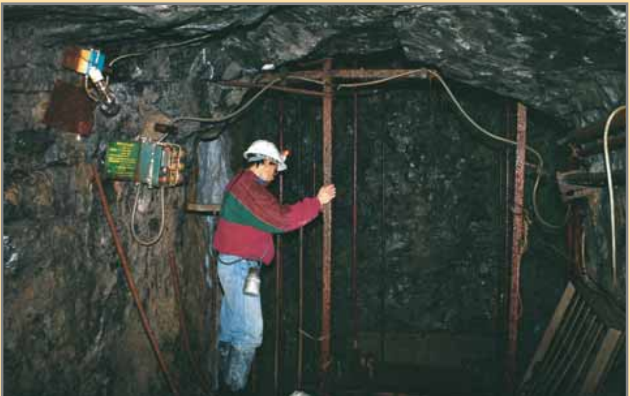
Enganche de la jaula en la 4ª Planta, con todos sus elementos intactos: cuadro de toques, accionamiento eléctrico y el ábaco de recuento que no se aprecia en la imagen. Foto: G. García, 12/1995.
