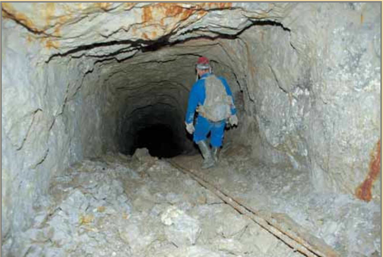
Descendiendo la rampa que baja a la 4ª Planta, con los cables de acero del scráper para arrastre de mineral. Foto: G. García, 9/2002.
