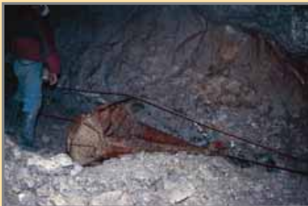
Escráper o arrodadera, para el arrastre de mineral en el interior del cuartel. Foto: G. García, 1995.
