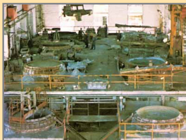
El "plomo de obra" se desplateaba en 12 calderas Pattinson, pasando a ser "plomo dulce". La imagen corresponde a "La Cruz". Foto: Archivo de F. Gutiérrez Guzmán.
