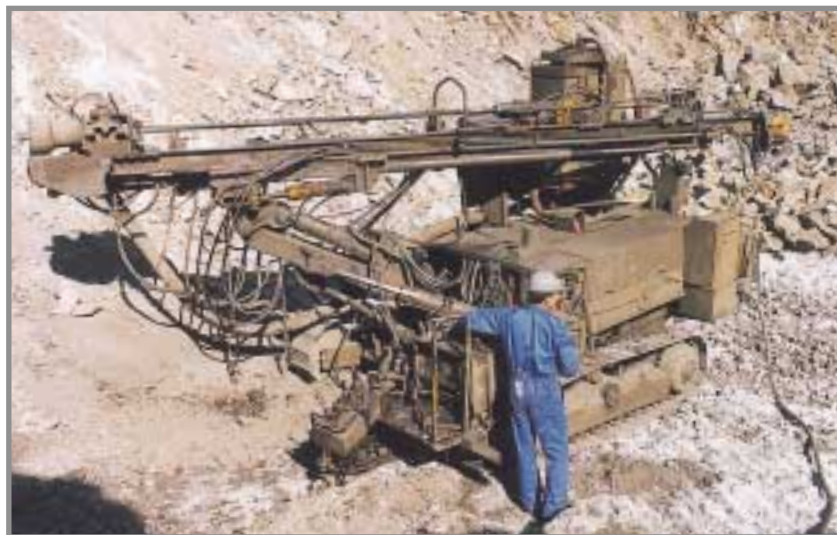
Carro perforador en trabajos de taqueo en el fondo de la corta Filón Norte (Tharsis). Marzo de 1995. Foto: Gonzalo García.
