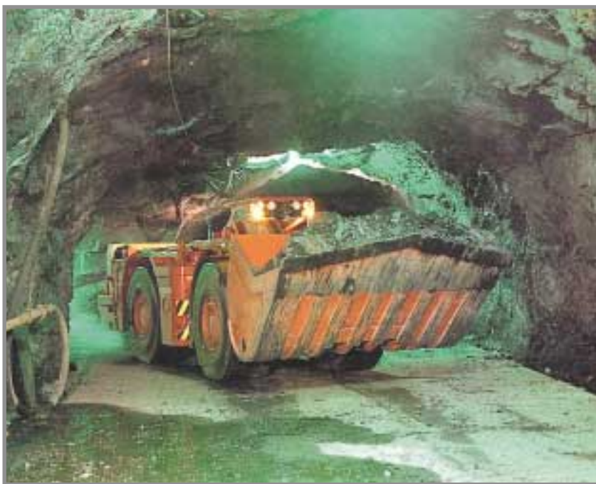
Pala cargadora Toro 501 de perfil bajo trabajando en la mina Sotiel. Este tipo de maquinaria se utiliza para cargar el mineral dentro de las cámaras por medio de un control remoto, manejado por un operario, que hace las operaciones más seguras. Foto cedida por Fernando Plá.
