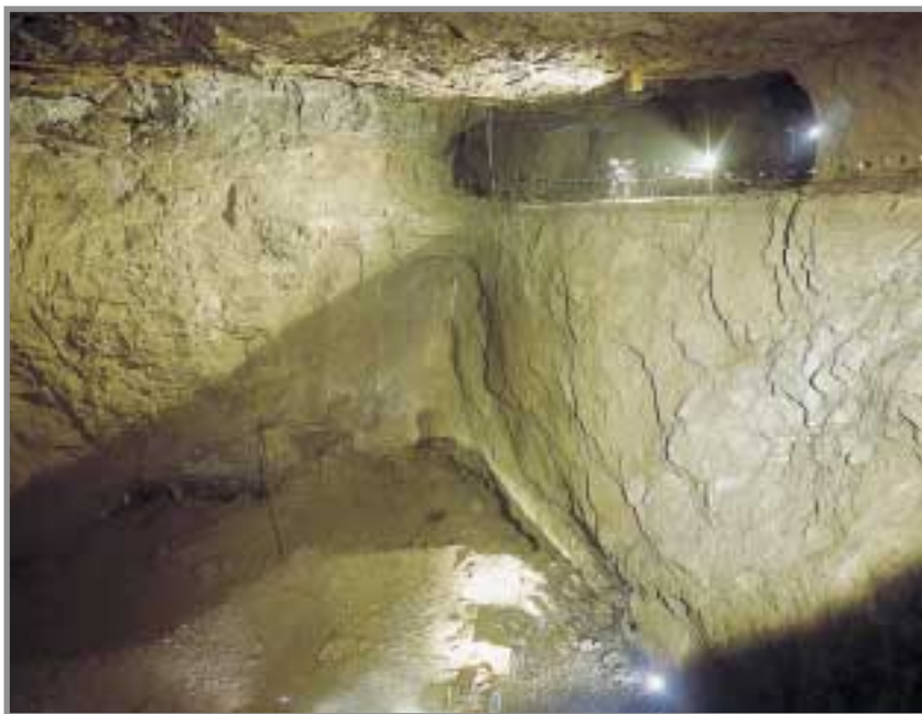
Espectacular vista de la cámara experimental 1350 en la mina Sotiel (Huelva). En esta cámara, de 25 m de altura, se probó el nuevo método de subniveles cuando se decidió cambiar el antiguo método de corte y relleno. Foto cedida por Fernando Plá.
