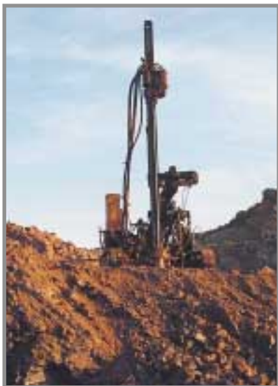
Carro para perforación de barrenos en Filón Sur (Tharsis). Marzo de 1995. Foto: G. García.
