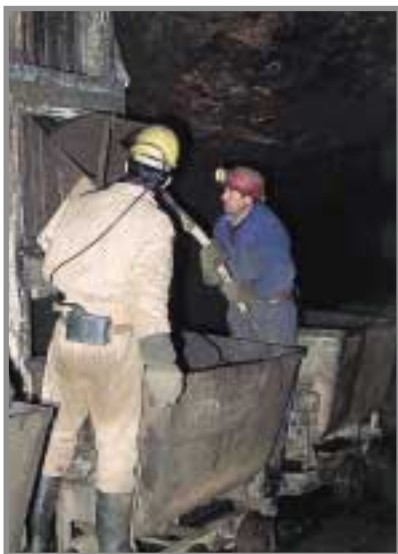
Mineros cargando vagonetes con mineral de hierro y manganeso mediante una tolva, en la mina Serra do Rosalgar (Cercal). Foto: F. Palero.
