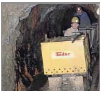
Locomotora eléctrica de extracción arrastrando una hilera de quince vagonetes cargados de mineral. Mina Serra do Rosalgar (Cercal). Foto: F. Palero.
