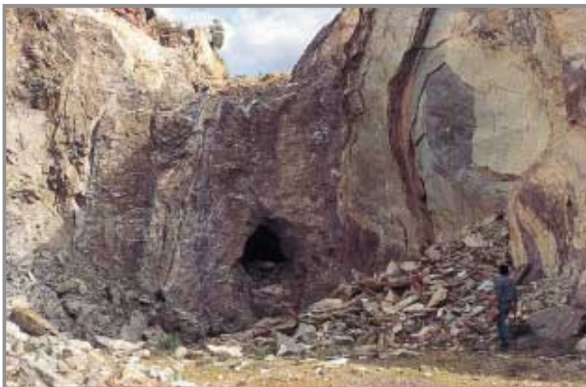
Detalle de la corta de la mina La Joya, en el yacimiento de Soloviejo, donde se observa el frente del cuerpo mineralizado encajado entre pizarras grises arcillosas. Los trabajos a cielo abierto dejaron al descubierto algunas de las galerías de la antigua explotación subterránea. Foto: Fernando Palero.
