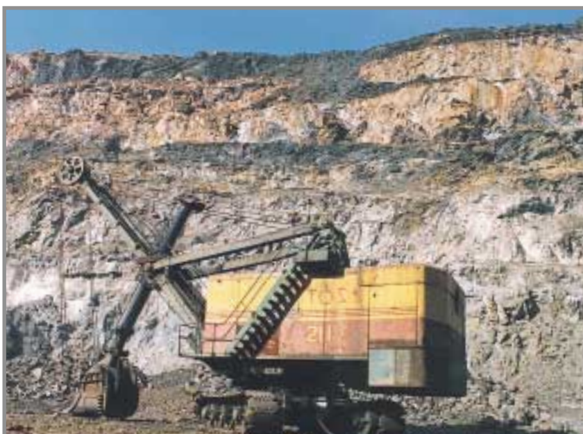
Excavadora eléctrica de cables, modelo BUCYRUS, trabajando en el fondo de la corta de Filón Norte (Tharsis). Marzo de 1995. Foto: G. García.
