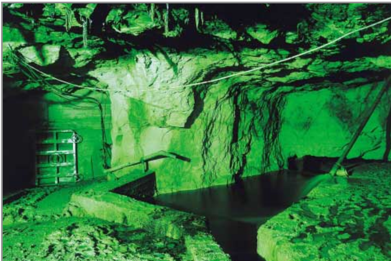
Vista del depósito de agua del 45 Piso del Pozo Alfredo. A la izquierda se puede observar la puerta que da paso a la Sala de Bombas. En ella, actualmente hay ubicadas 3 bombas, con una capacidad de bombeo cada una de 125 m 3 /h, a una profundidad de 111 m bajo el nivel del mar en Huelva. Foto: F. Piña.
