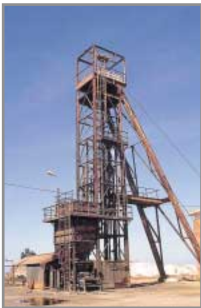
Castillete metálico y tolva en las minas de Aljustrel (Portugal). Los estudios de previabilidad llevados a cabo en los últimos años en estas minas, hacen de del yacimiento de Feitais uno de los de mayor potencial económico de toda la FPI. Foto: G. García.
