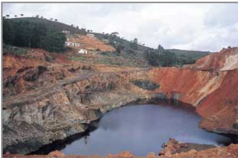
Filón Sur (Tharsis). Al fondo, la planta de cianuración que trabajó el oro de los gossans hasta 1963. En primer término, la corta Filón Sur (ya explotada). El agua tiene 400 gr de cobre por toneleda. Foto: Antonio Arribas.
