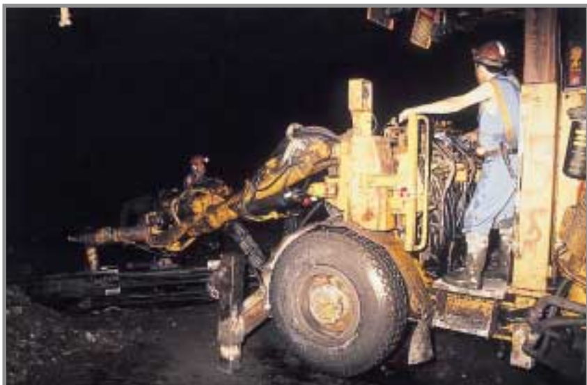
Labores de avance en cámaras, realizadas mediante un Jumbo electrohidráulico, en la mina de Neves-Corvo (Portugal). Foto cedida por Fernando Plá.
