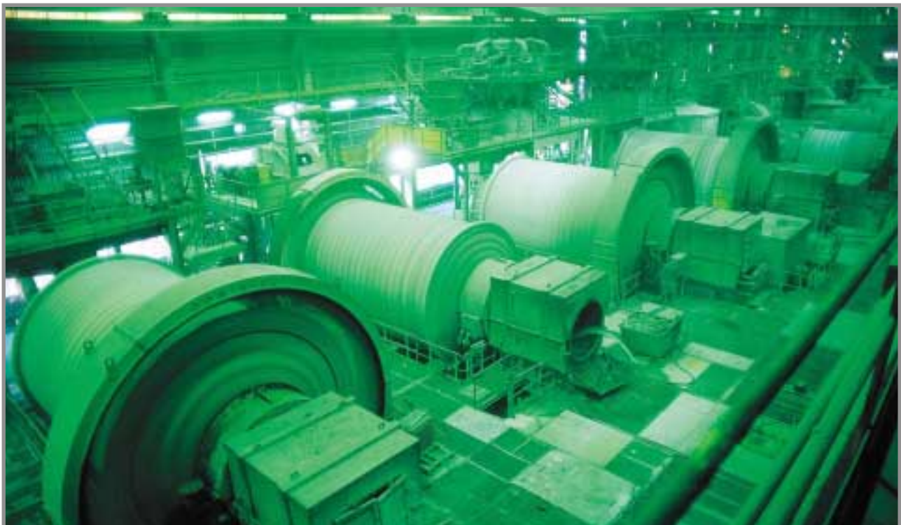
Área de molienda del concentrador de Cerro Colorado. Esta área está constituida por tres etapas: Molienda de barras, de bolas y remolienda, complementadas con etapas de clasificación mediante baterías de hidrociclones (aparecen situadas sobre los molinos en la parte superior de la foto) para llegar a un tamaño de grano adecuado para el proceso de flotación. Hay cuatro lienas de molienda, tres de 250 t/h de capacidad cada una y la cuarta (que es la que aparece en primer término de la imagen) de aproximadamente el doble. Foto: F. Piña.
