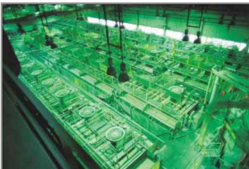
Área de flotación de cobre en el Concentrador de Cerro Colorado. Tras la fase de molienda y clasificación, la pulpa es distribuida por un repartidor de carga (derecha, en primer término) entre cuatro líneas de "flotación desbaste" (centro de la imagen) en la que separan todos los sulfuros de la ganga. El flotado, tras una remolienda para separar los sulfuros de cobre del resto de sulfuros, pasa a una segunda fase denominada "flotación selectiva", de la que resulta el concentrado de cobre. Foto: F. Piña.
