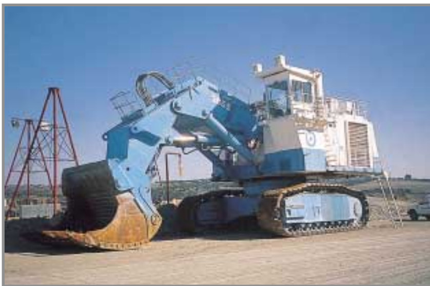
Excavadora hidráulica DEMAG H2855, con cazo de 22 m³ y motor de 1.600 caballos de potencia. Es de carga frontal y se emplea en Aznalcóllar para carga de mineral en zonas difíciles de cargar para las excavadoras eléctricas. Foto: Miguel Checa.
