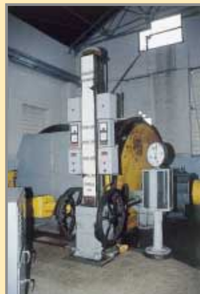
Tambor, velocímetro e indicador de piso de la máquina de extracción del Pozo Santa Amelia. 6/01, Foto: G. García.
