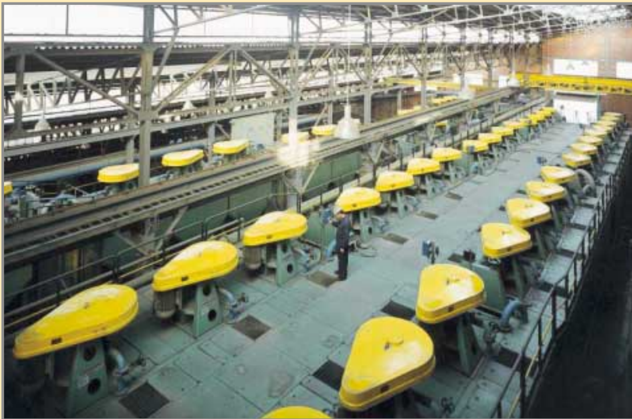
Edificio de flotación de Torres, con capacidad de tratamiento de 4.000 t/día. Foto: AZSA.
