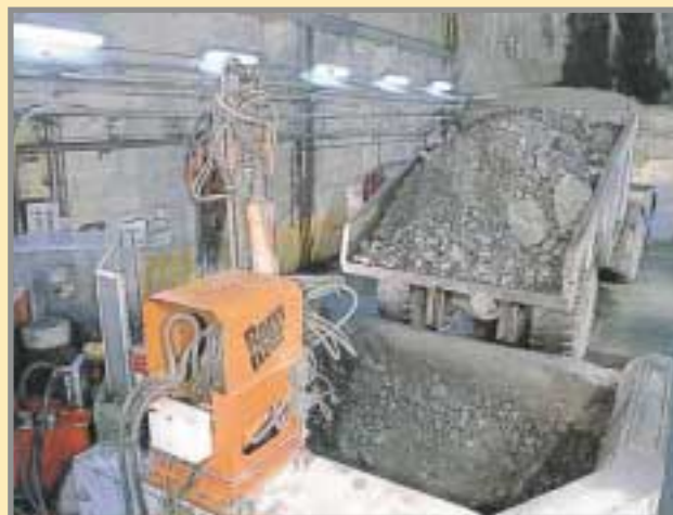
Instalación de trituración primaria del nivel -260, junto al Pozo Santa Amelia. Se trata de un cono Nordberg 30/60 que produce un <150 mm. Foto: AZSA.
