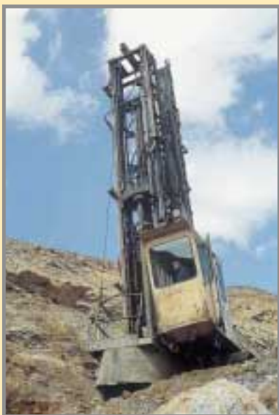
Perforadora realizando barrenos de producción para voladura en banco. Foto: G. García, 7/98.
