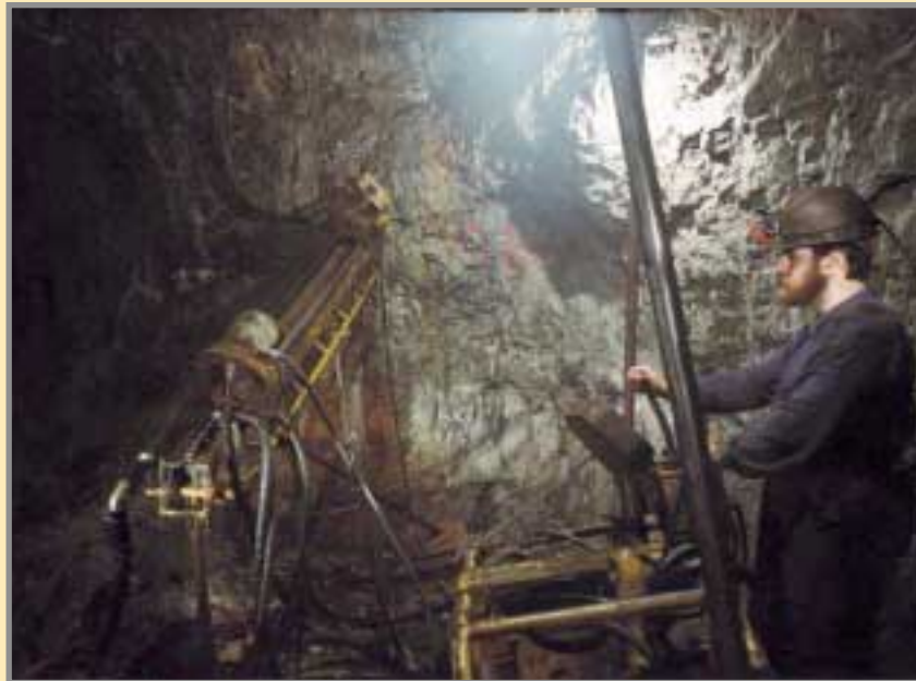
Realización de un sondeo de investigación en el interior. Foto: AZSA.
