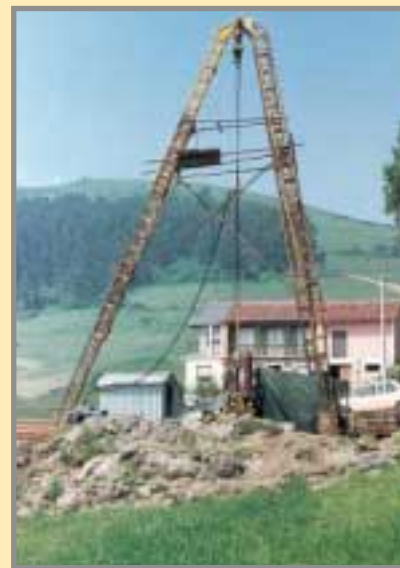
Sonda de investigación trabajando en la localización de nuevos yacimientos en el sinclinal de Santillana. Foto: AZSA.
