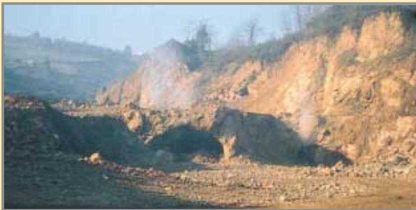
Salida de aire del interior al nivel 6° (fondo del Zanjón), visible por efecto de la condensación de vapor en invierno. Foto: R. Antón.
