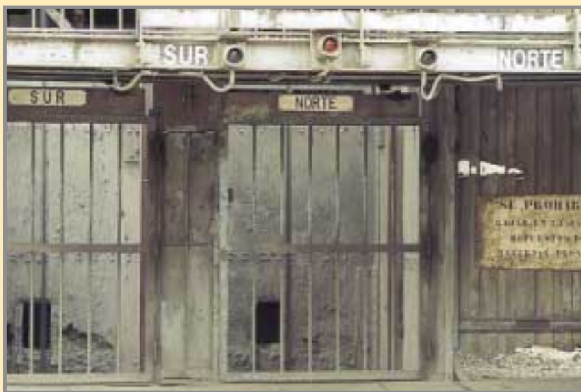
Embarque del Pozo Santa Amelia en superficie. El pozo da servicio al transporte de personal y a dos skips de 7,5 t, desde la trituración primaria en el nivel -260 Foto: G. García.
