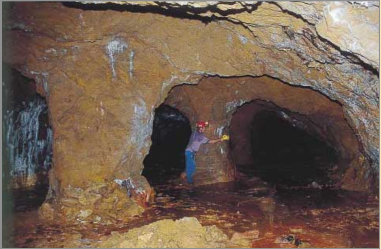
Zona de explotación por cámaras y pilares en la mina de Mercadal. El yacimiento es muy similar a Reocín, del que sólo le separa una falla. Ambos se caracterizan por la abundancia de pirita y marcasita, minerales que son mucho más escasos en los otros yacimientos estratoligados de Cantabria. Foto: G. García.
