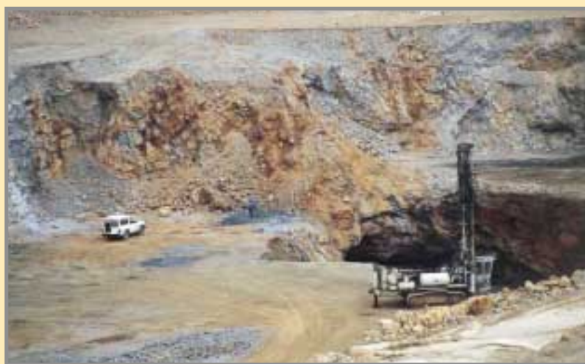
La explotación a cielo abierto se reanudó en 1965, como consecuencia del hundimiento de la mina subterránea. Como se observa en la fotografía, conecta con la mina subterránea, cuyos pilares recupera. 6/01. Foto: G. García.
