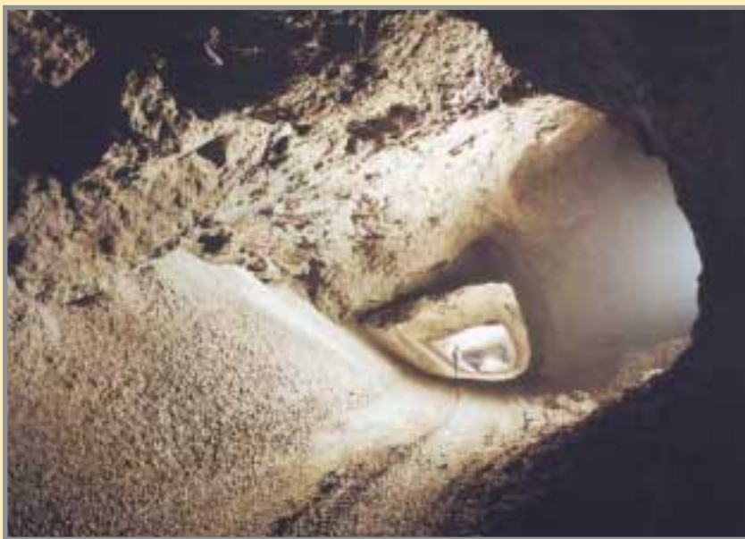
Calle de trabajo: relleno cementado a la izquierda y sucesión de pilares a la derecha, pendientes de extracción. El hueco lleva la inclinación de la capa. Foto: AZSA.
