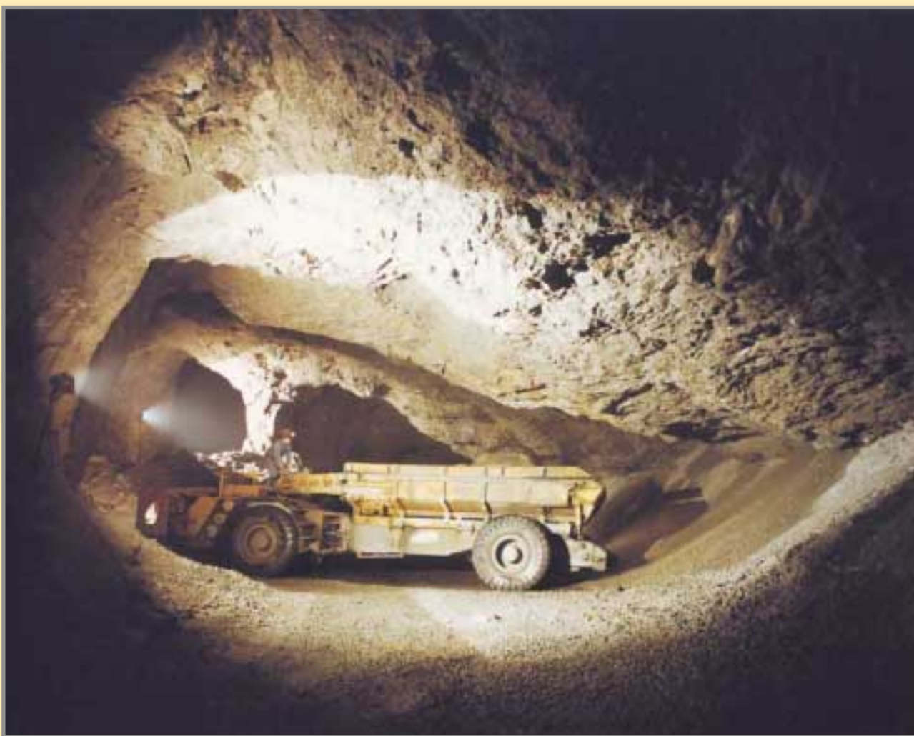
Camión lanzadera de relleno trabajando en la zona de recuperación de pilares. Foto: AZSA.
