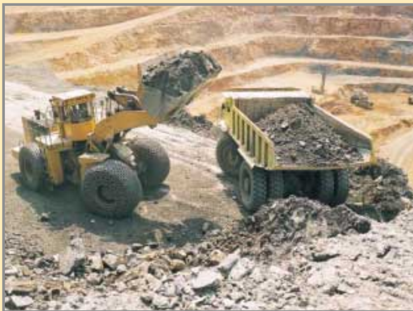
Carga de estériles en el talud Norte del Zanjón. Foto: AZSA.
