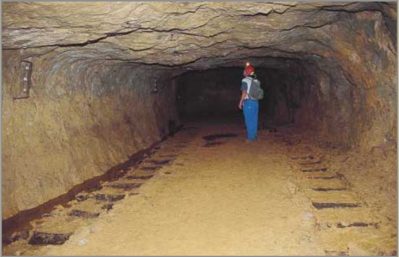
Socavón para doble vía en el primer nivel de la mina de Udías. La conexión entre las plantas tiene lugar por planos inclinados mecanizados para la extracción de minerales, y por pozos igualmente equipados para la subida a la calle. En Sel del Haya partía un ferrocarril minero que llevaba las calaminas a los hornos de la empresa en Reocín. Foto: G. García, 7/2001.
