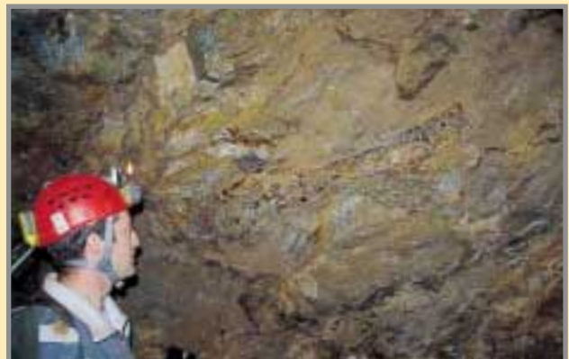
En las rocas de caja de la mineralización, y en la propia capa, son frecuentes las pasadas carbonosas de lignitos, observables en diversas minas. Mina Isidra, 5/2001. Foto: G. García.
