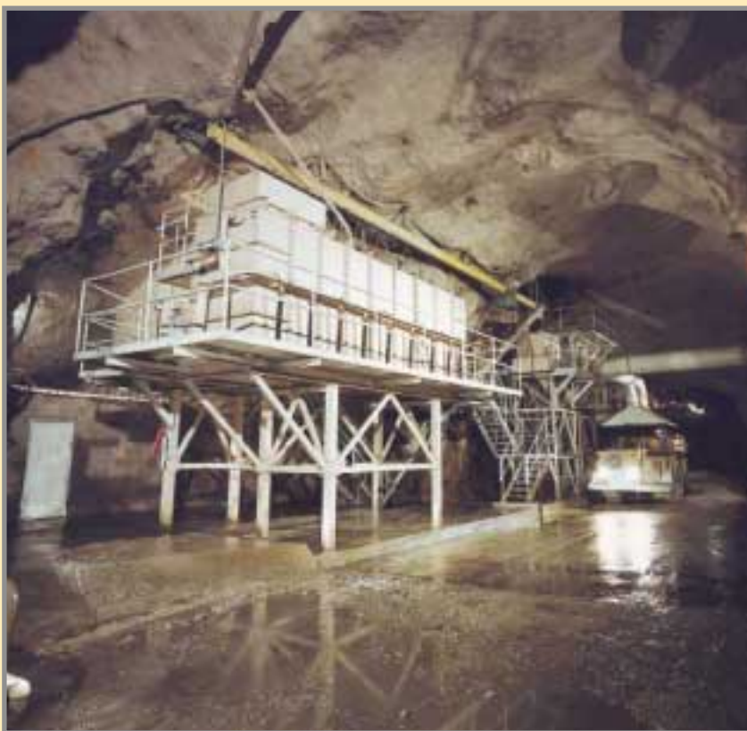
Arriba: La rampa Jorge Valdés recibe su nombre en honor al malogrado Jefe de Geología de AZSA. Abajo: Planta subterránea de preparación automatizada del relleno, en el nivel -140. Foto: AZSA.
