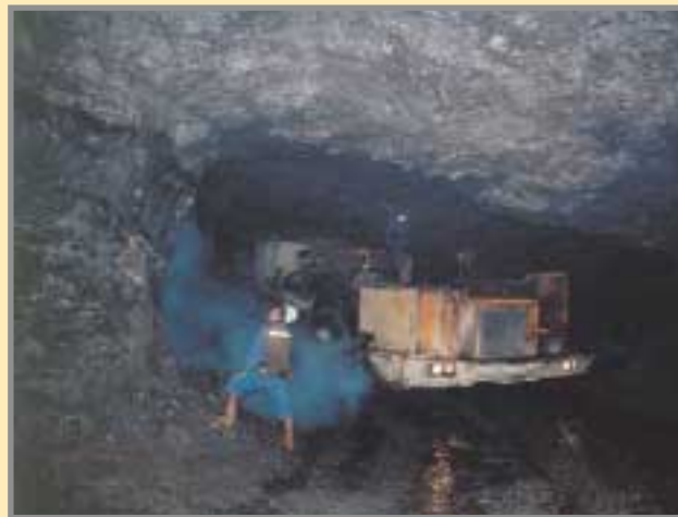
Camión lanzadera proyectando relleno de hormigón en Punta de Lanza, nivel -290, cámara 1. 6/01. Foto: G. García.
