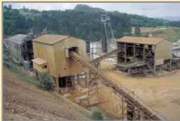
Cinta de entrada a trituración secundaria. Detrás, el castillete del Pzo Santa Amelia. 6/01. Foto: G. García.
