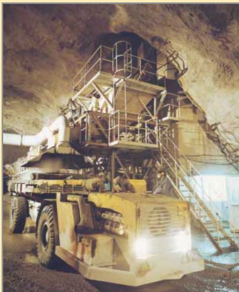
Lanzadera de perfil bajo cargando en la planta de preparación del relleno. Foto: AZSA.
