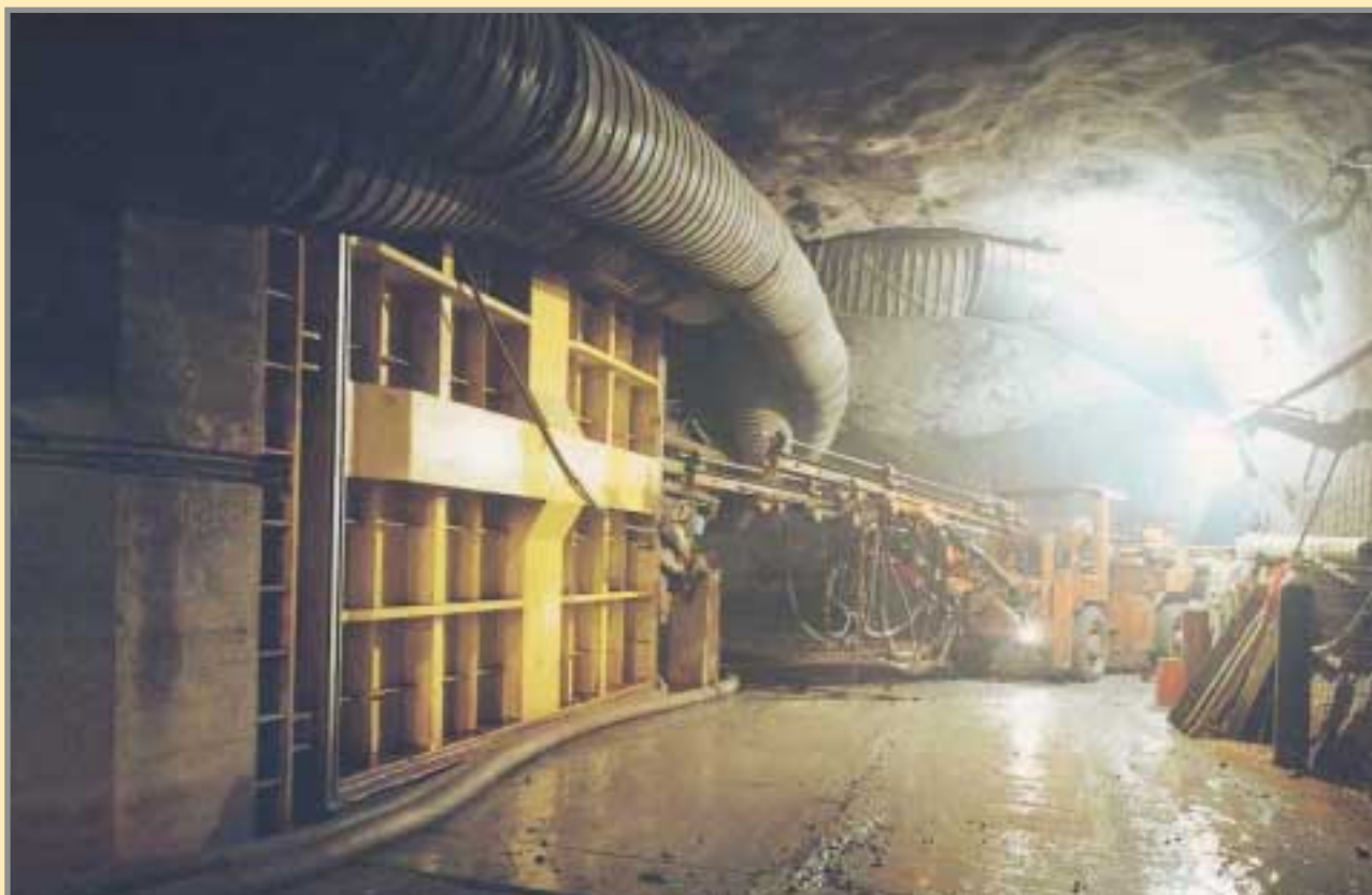
Compuerta estanca de protección de la cámara de bombas. Detrás, un jumbo de dos brazos. Foto: AZSA
