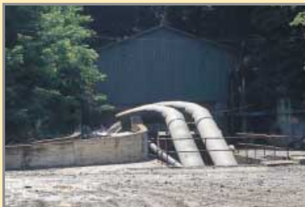
El desagüe de la mina se realiza a través de dos tuberías de 1 m de diámetro, que salen al exterior por un plano inclinado de 728 metros. Foto: G. García.
