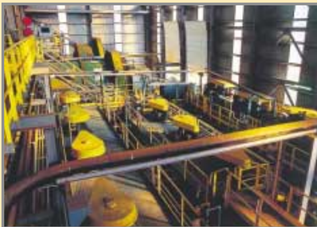
La línea de flotación tiene por objeto reducir el contenido en cobre tras la gravimetría, y evitar así fuertes consumos de cianuro y posteriores interferencias en la extracción del oro. Foto: Cortesía de RNGM, S.A.
