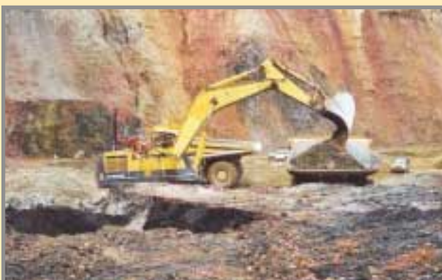
Extracción selectiva del mineral de alta y baja ley, con arreglo a los resultados analíticos de los sondeos de control de leyes. Foto: Cortesía de RNGM, S.A.
