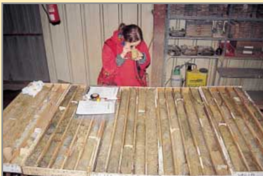
De la descripción detallada de los sondeos de exploración se dedujo el modelo geológico del yacimiento y la caracterización de los parámetros geotécnicos de los macizos rocosos. Foto: Cortesía de RNGM, S.A.
