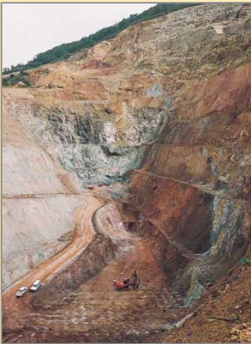
Perforación y voladura en Boinás Este de los jasperioides y el skarn oxidado (mineralización tipo "Sienna"). En la parte superior de la fotografía se observa el cabalgamiento de las dolomías de la Formación Láncara sobre las areniscas de la Formación Oville. Foto: Cortesía de RNGM, S.A.
