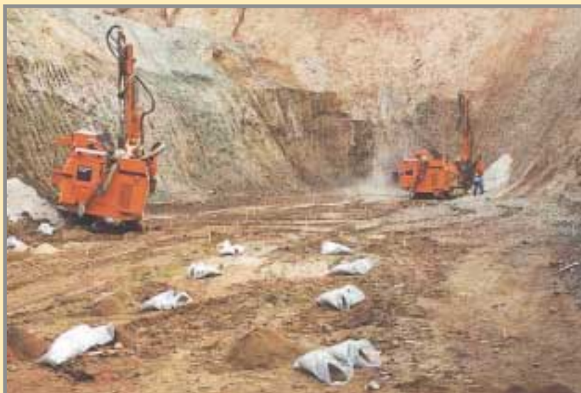
Perforadoras Tamrock realizando sondeos de control de leyes en la corta El Valle. Obsérvese el muestreo sistemático de rípios para su posterior análisis. Cada perforadora dispone de una cuarteadora para la obtención de una muestra representativa de toda la columna del sondeo. Foto: Cortesía de RNGM, S.A.
