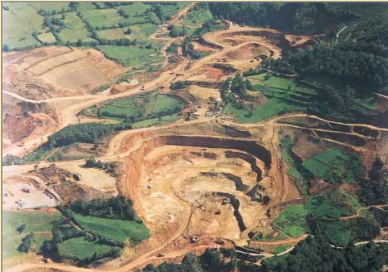
Fase preliminar de los desmontes, en 1997. Los estériles van apilándose en la escombrera del Regueral, futura ubicación de la balsa de estériles de la planta. Las potentes capas de arcillas del Terciario del desmonte de las cortas fueron empleadas para la construcción del vaso impermeable de dicha balsa. Foto: Cortesía de RNGM, S.A.
