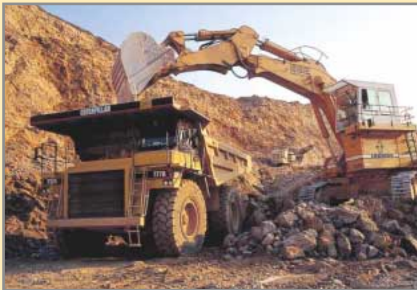
Labores de carga de estéril en la corta de Boinás Este (1999). Las empresas contratistas apostaron por la adquisición de equipos nuevos para el importante movimiento de tierras previsto. Foto: Cortesía de RNGM, S.A.
