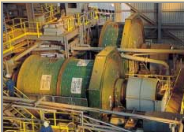
Molino semiautógeno y de bolas (en primer plano) para una salida de producto inferior a 74 micras. Foto: Cortesía de RNGM, S.A.
