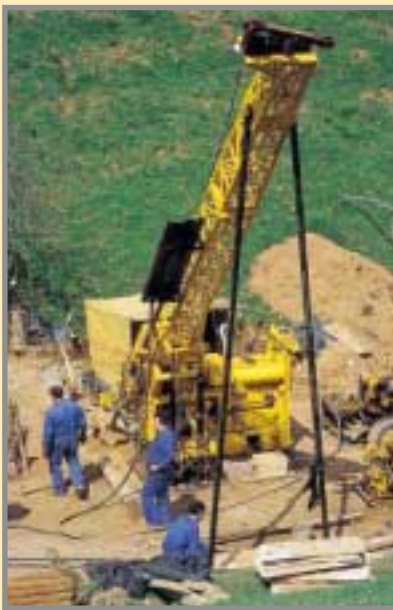
Campaña de sondeos de exploración en la zona de Boinás Este. Debido a la intensa alteración de las mineralizaciones, se emplearon mezclas de lodos de perforación muy específicas, para aumentar la recuperación. Foto: Cortesía de RNGM, S.A.
