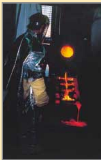
La fusión del bullión de oro y plata se realiza una vez por semana, en un horno basculante que trabaja a 1.200°C. Foto: Cortesía de RNGM, S.A.
