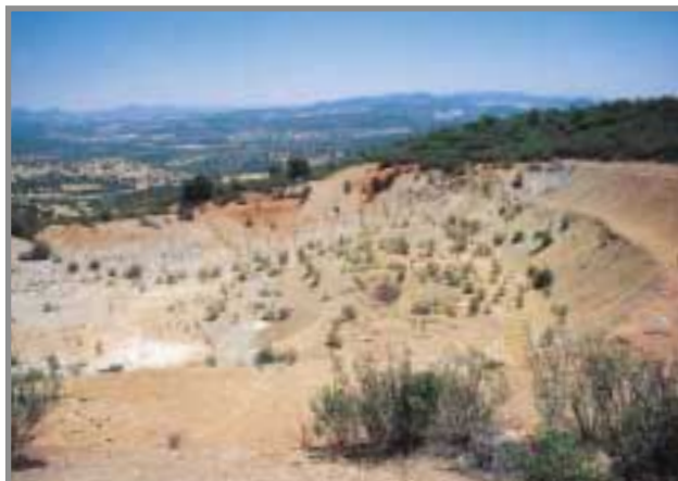
Cantera abandonada de caolín, situada 2 km al NW de las Minas Viejas. Fue puesta en marcha en 1908 por Peñarroya, para el revestimiento refractario de la fundición de zinc de la empresa. Foto: G. García, 8/2001.
