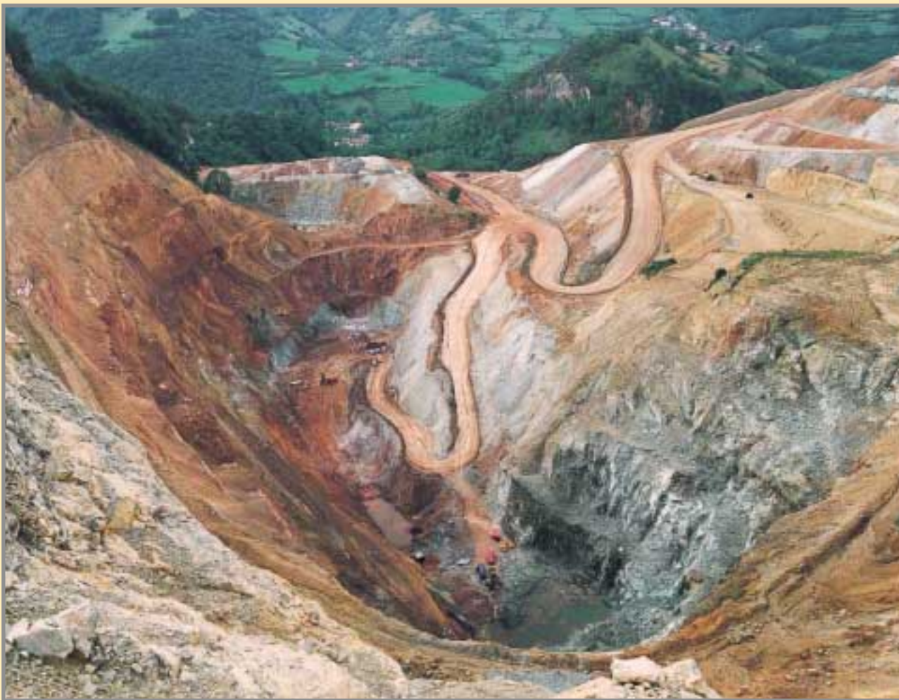
Aspecto del fondo de corta de la fase 1 de Boinás Este en diciembre de 1999. En el talud derecho de la fotografía se aprecia la mineralización de skarn fresco (abajo), en contacto con la roca ígnea semialterada (arriba). Foto: Cortesía de RNGM, S.A.
