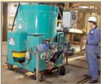
Concentrador Knelson 30, de gravimetría. Foto: Cortesía de RNGM, S.A.
