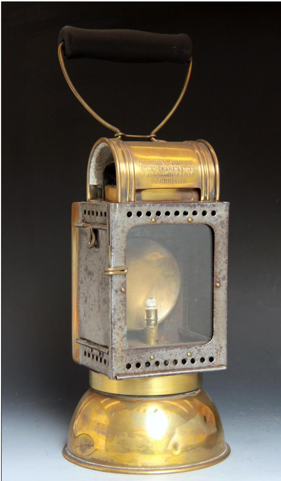
Figura 13: *Linterna de acetileno de latón mod. 110 (Col. y foto. J.M. Sanchis)*
