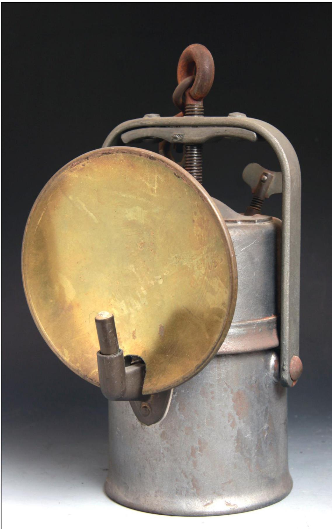
Figura 9: Lámpara Seippel de carburo 102a (Col. y foto. J.M. Sanchis)
