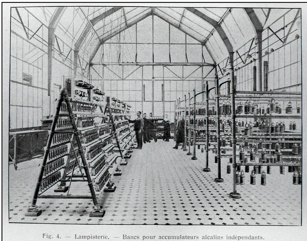
Fig. 4. — Lampisterie. — Bancs pour accumulateurs alcalins indépendants.
