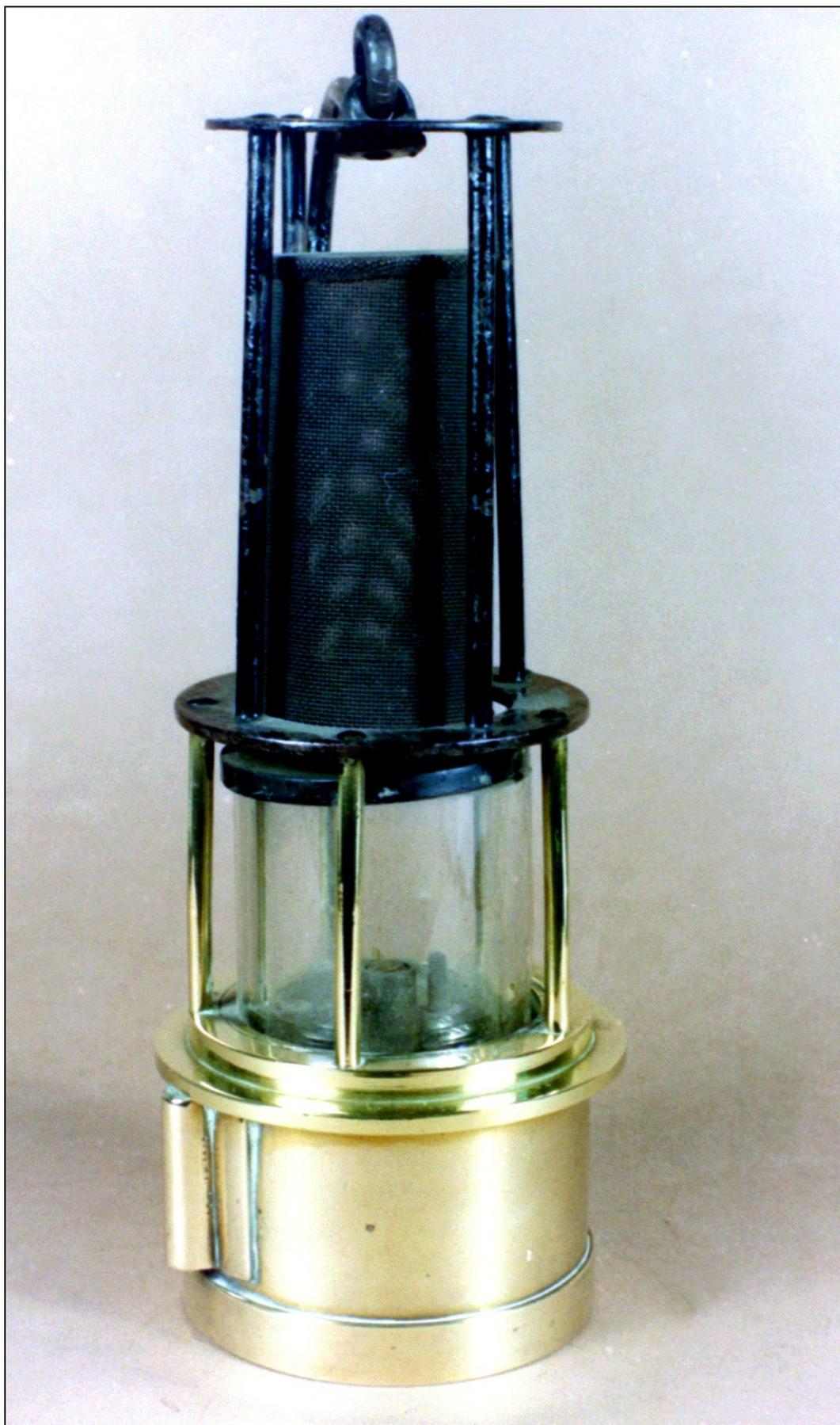
Figura 4: Lámpara de latón con cierre de seguridad vertical. 1930
