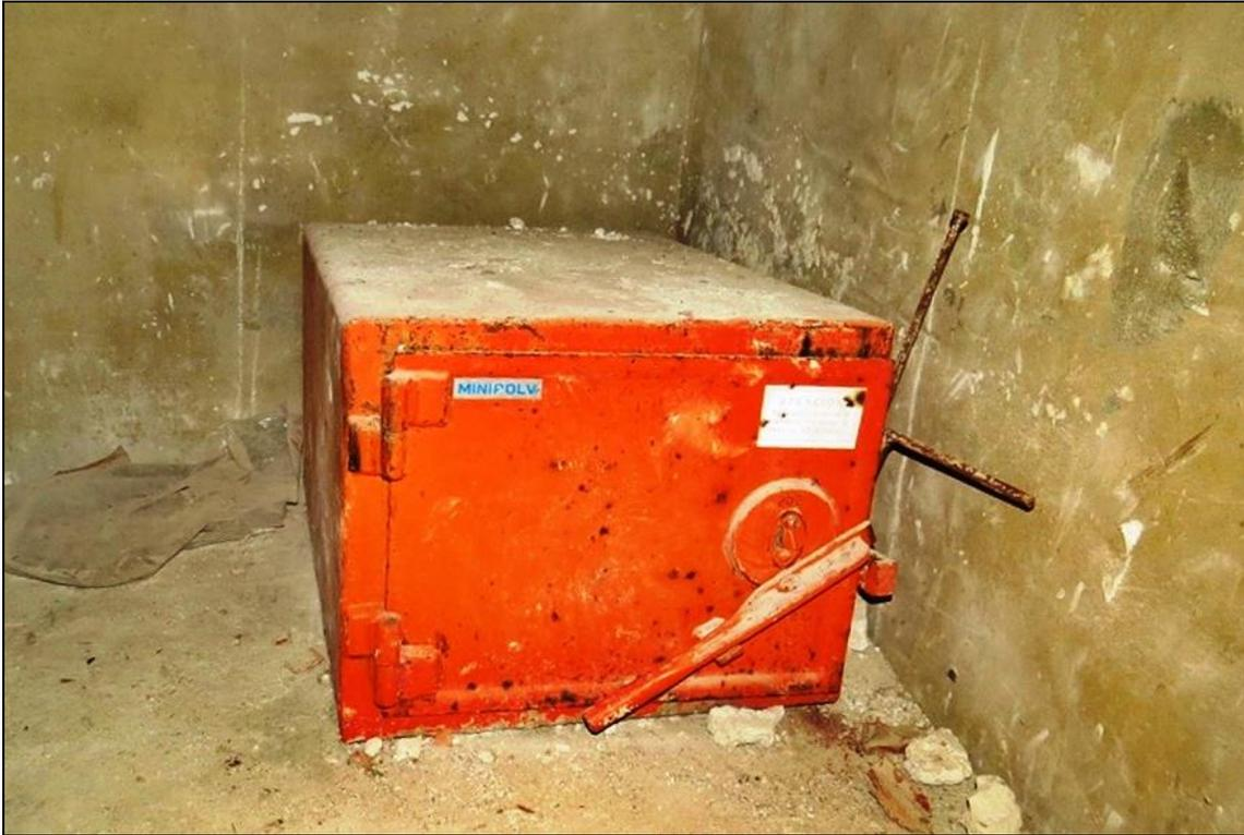
Figura 15: Minipolvorín usado en labores de interior. Minipolv Tipo A, fabricado por Unión Española de Explosivos (Fot. M. Arlandi, 2023)
