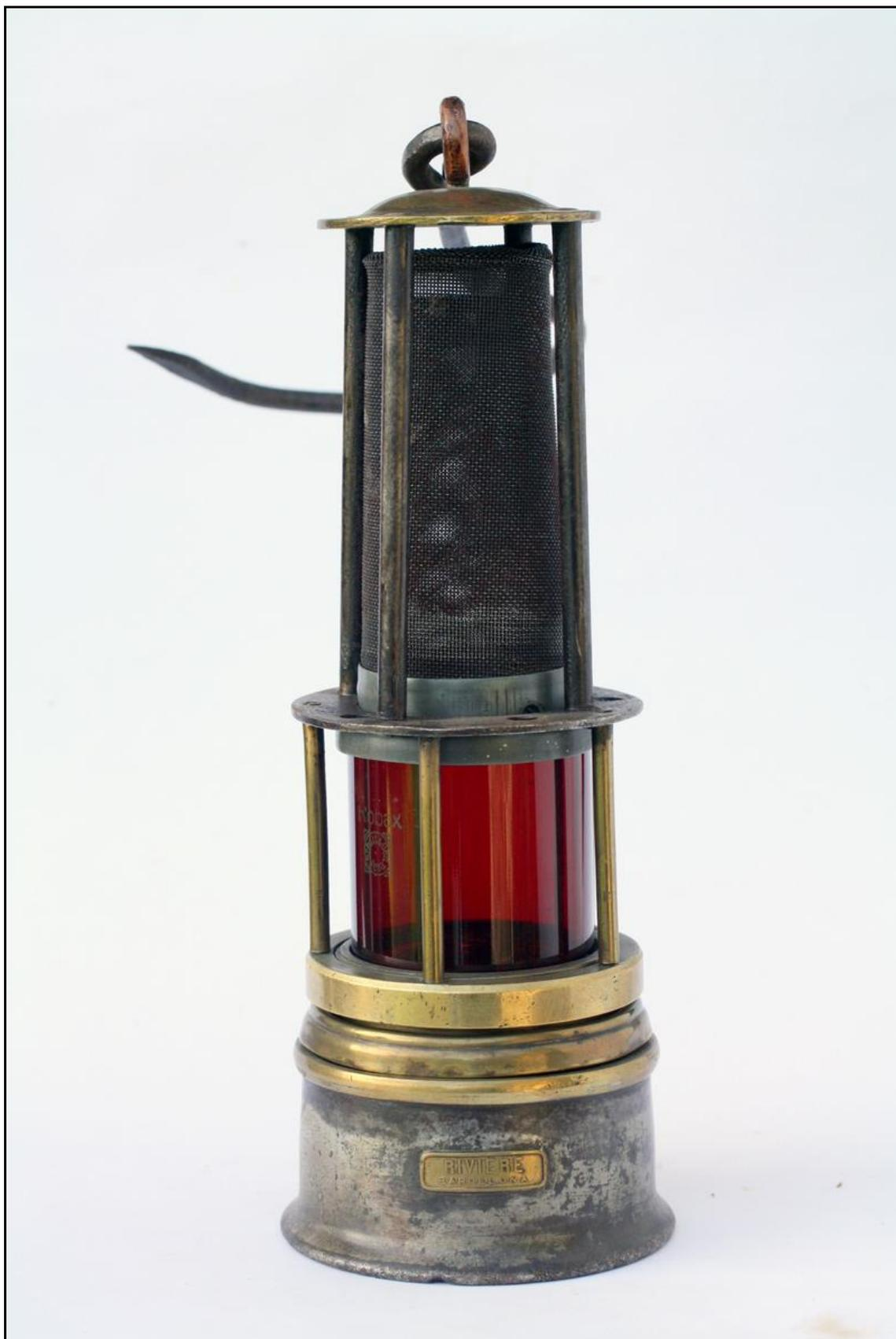
Figura 95: Lámpara Joris con cristal rojo para señalización
