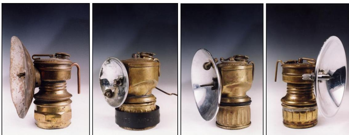
*Figs. 73, 74, 75 y 76. De izquierda a derecha, Carburo de casco Universal Lamp, USA, 1930; Las dos siguientes, Lámpara de casco Justrite, USA, 1960 y por último, Lámpara Butterfly, Hong Kong, 2000. (Col. y fotos J.M. Sanchis)*
