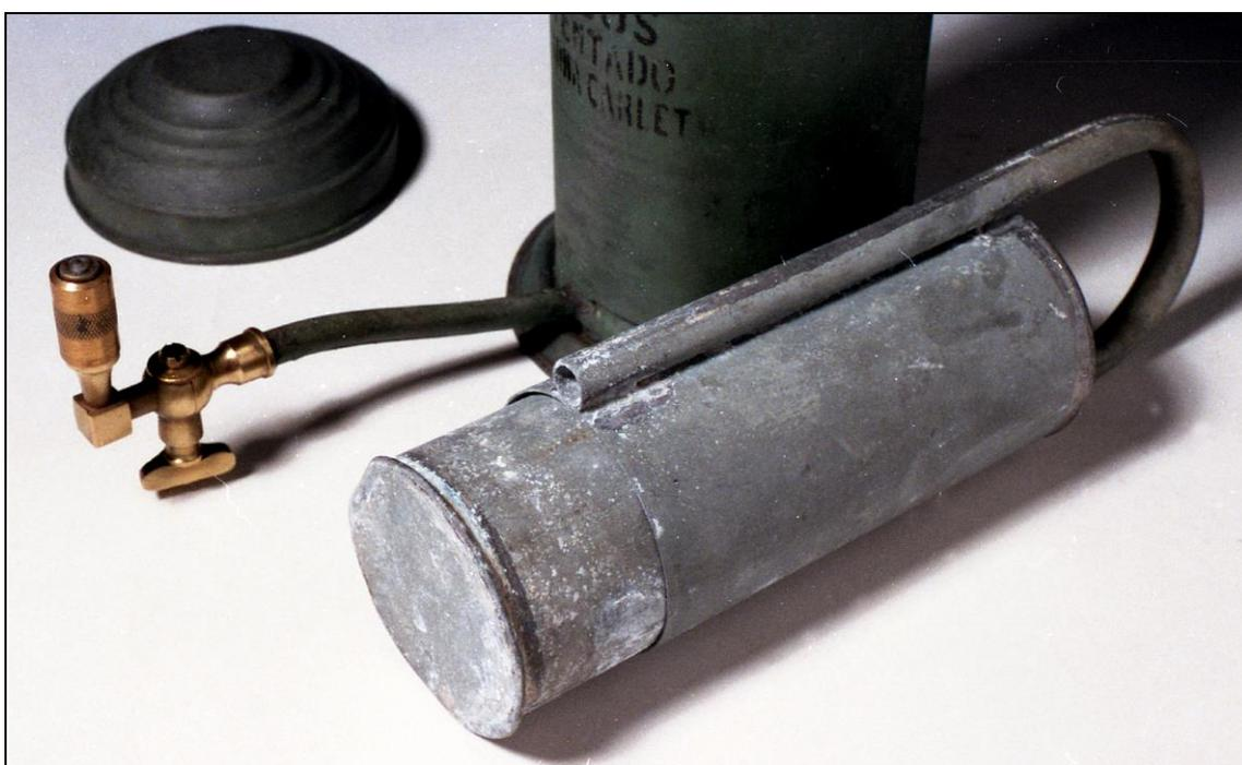
*Fig. 5: Tubo de salida del acetileno (Col. J.M. Sanchis)*
