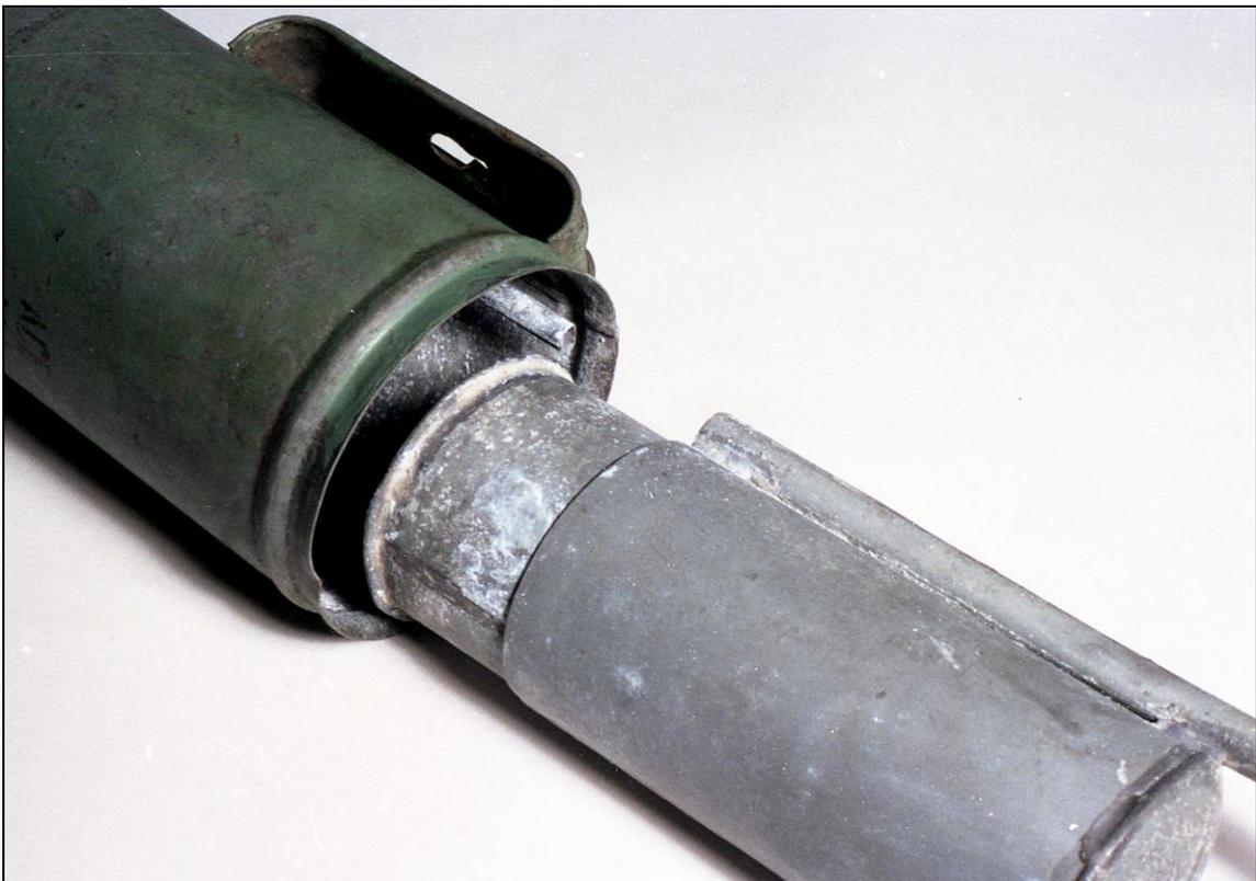
*Fig. 4: Disposición del depósito interno de carburo (Col. J.M. Sanchis)*
