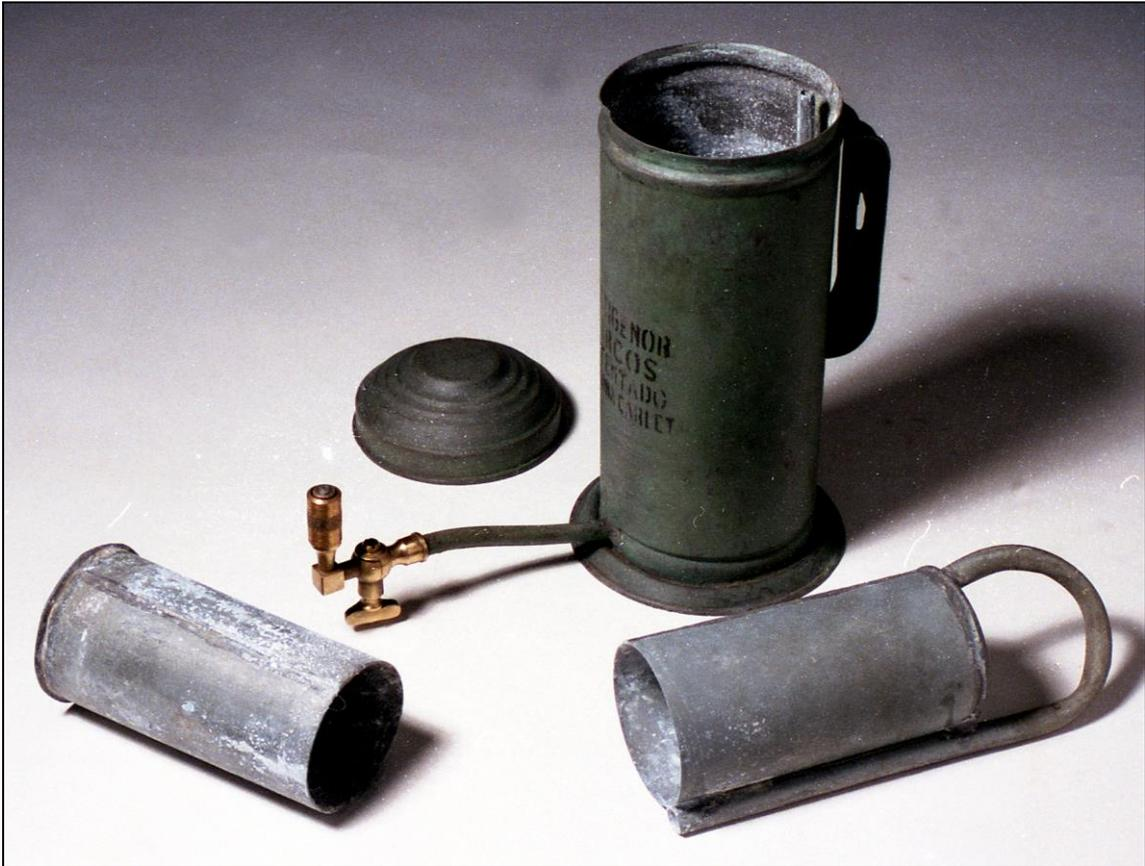
*Fig. 3: Depósito interno de carburo (Col. J.M. Sanchis)*
