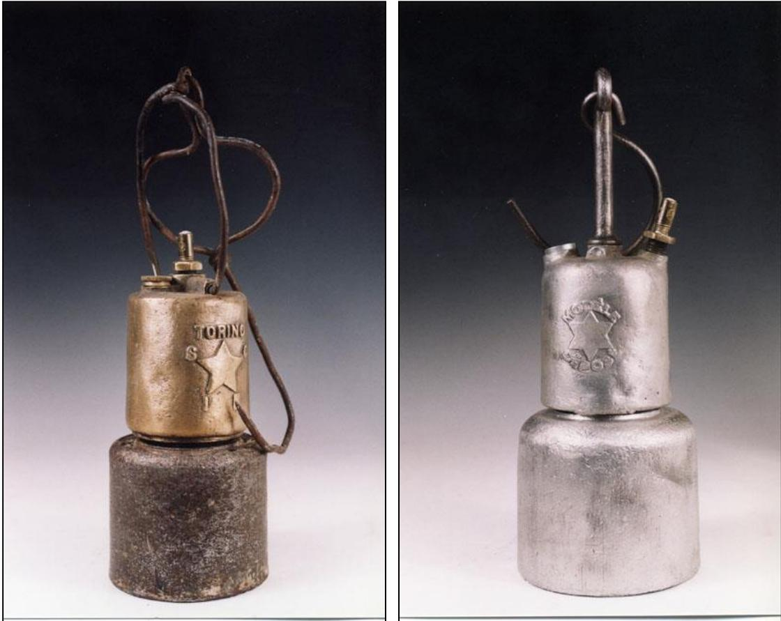
Figs. 33 y 34. De izquierda a derecha, Lámpara tipo Simplon de SIEC. Italia, 1925 y Carburero tipo Simplon de Mercier & Fils, Francia, 1930 (Col. y fotos J.M. Sanchis).
