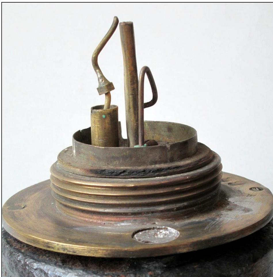
*Fig. 3: Encendedor eléctrico de una lámpara Patterson tipo HCP
