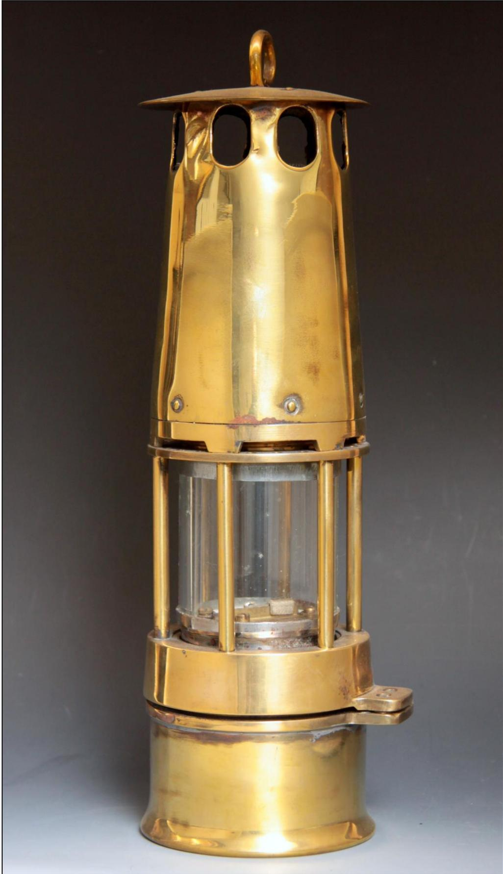
*Fig. 70: Lámpara Adaro equipada con encendedor horizontal tipo Koch
