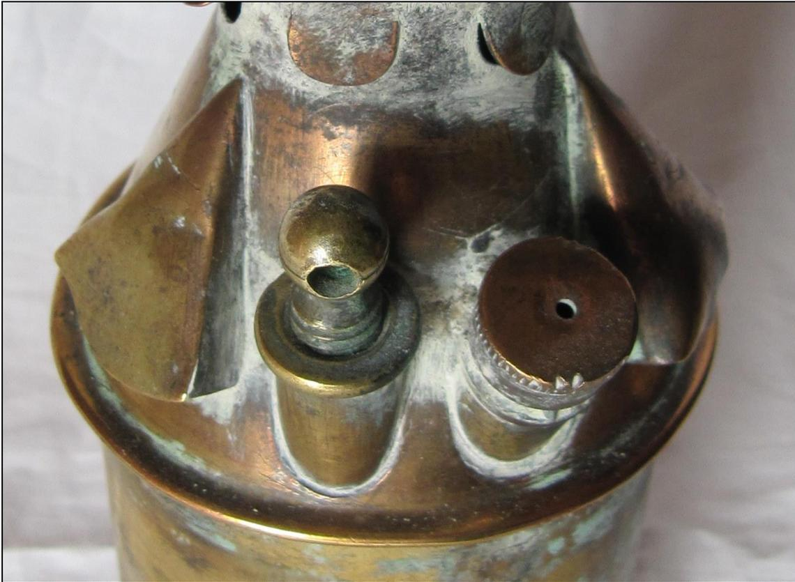
*Fig. 8: Detalle de la aguja reguladora y el tapón del depósito de agua (Col. y foto J.M. López Vallina)*
