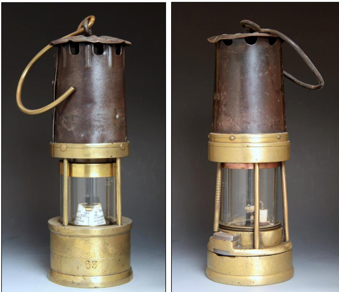
*Fig. 1 (Izquierda): Lámpara de seguridad Hailwood & Akroyd con encendedor eléctrico (Col. y fotos J.M. Sanchis)*
