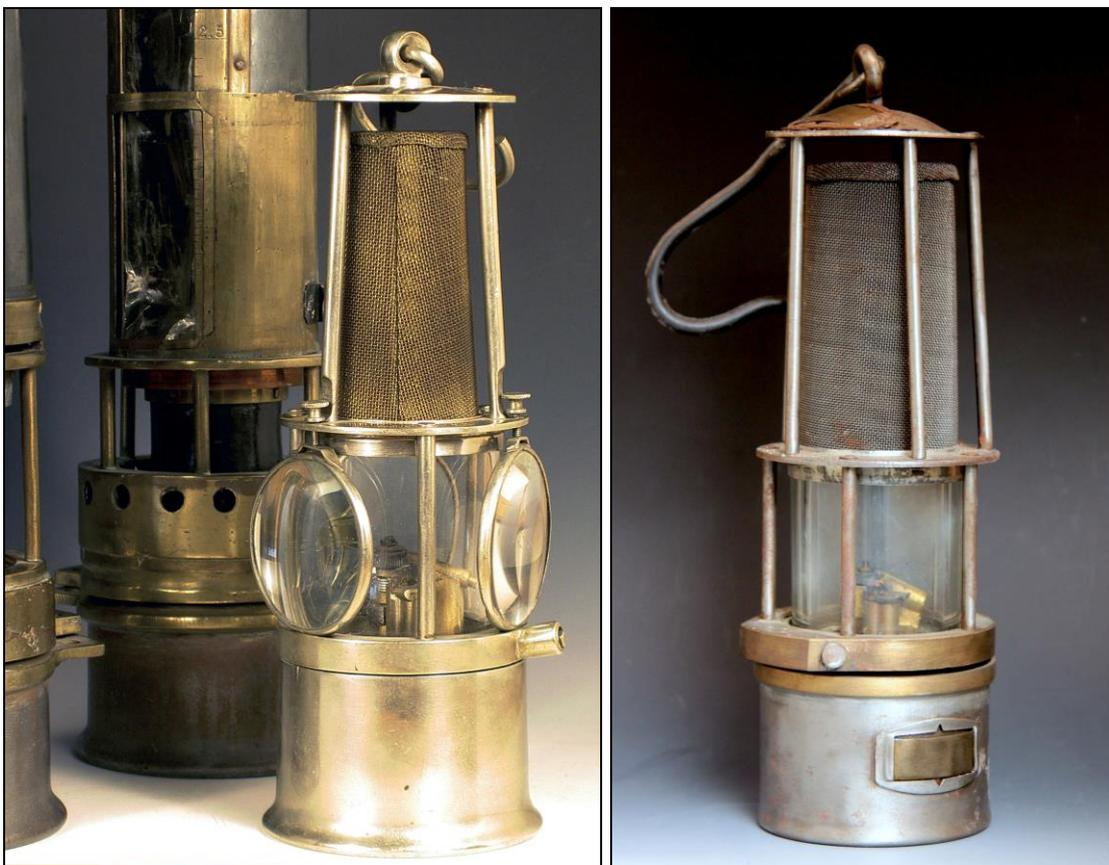
Fig. 32 (Izquierda): Lámpara de geómetra con encendedor vertical (Col. Museo H.M. Felipe de Borbón, ETSIM, Madrid. Foto. J.M. Sanchis)
