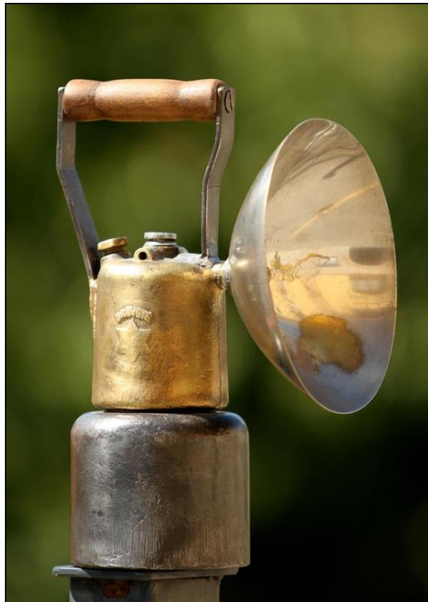
Fig. 13: Lámpara Mercier del tipo corriente (Col. y foto J.M. Sanchis)
