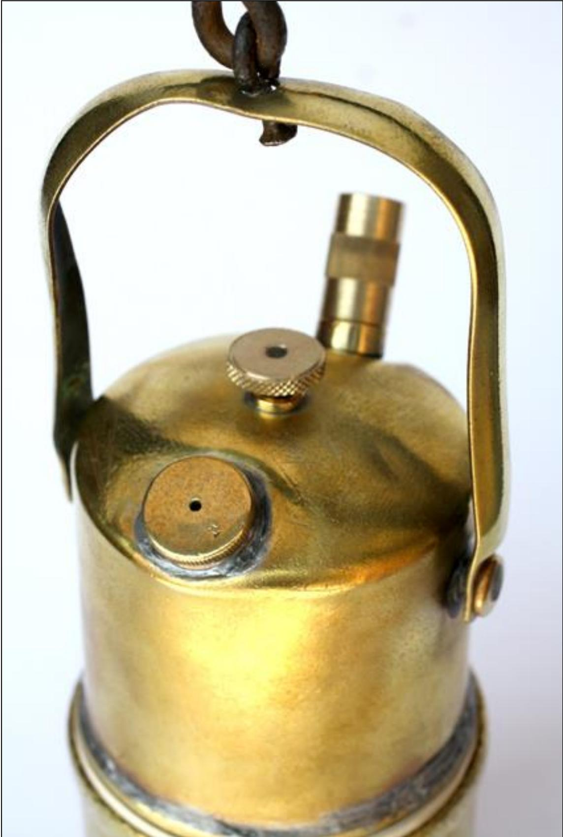
*Fig. 20: Detalle del tapón y la llave reguladora (Col. y foto J.M. Sanchis)*
