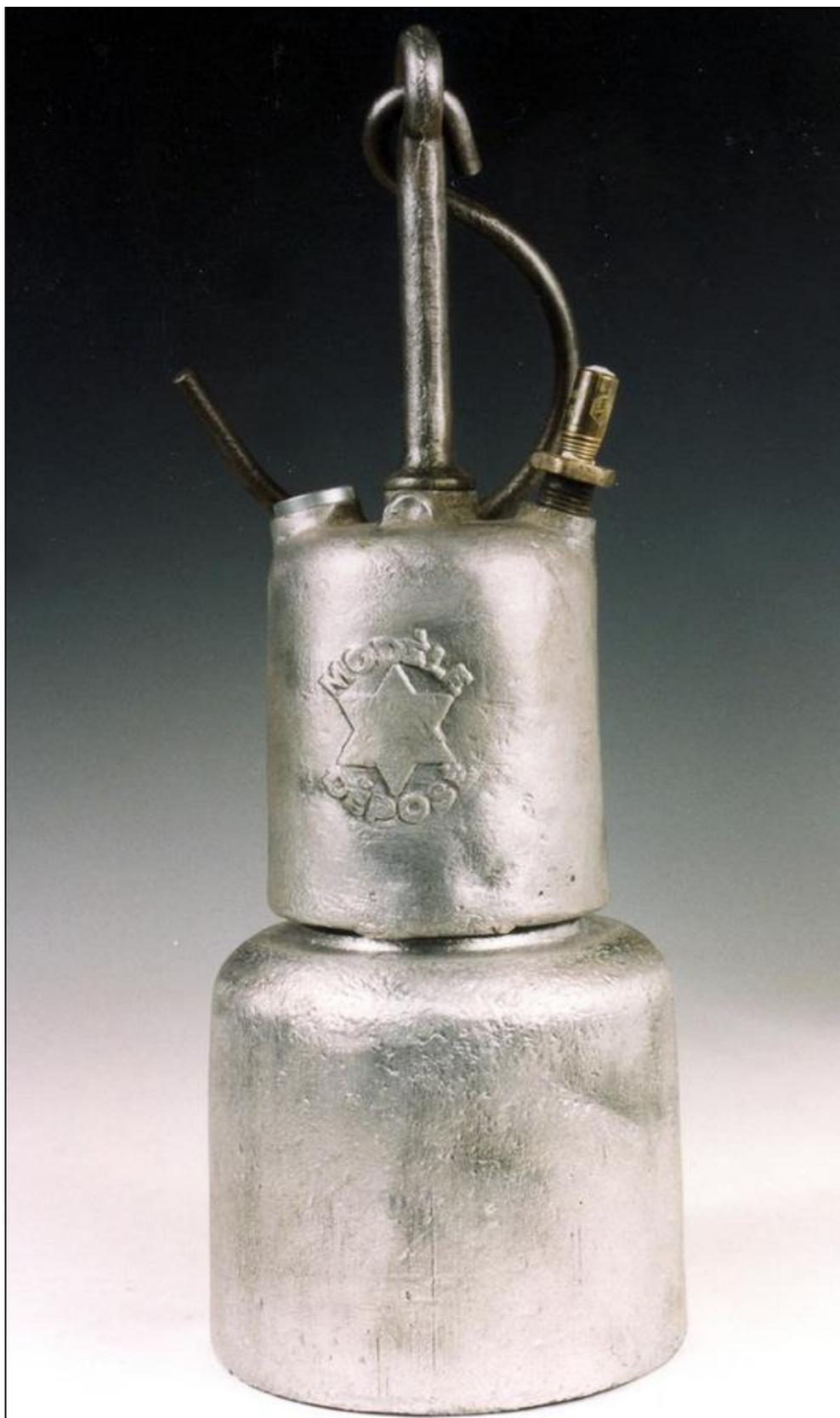
*Fig. 10: Lámpara construida con aluminio (Col. y foto J.M. Sanchis)*
