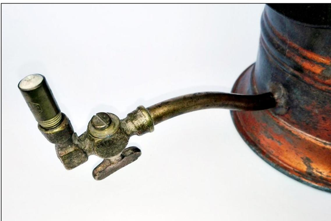
Fig. 14: Lámpara Espriu. Tubo de salida del gas al mechero (Col. J.L. García)
