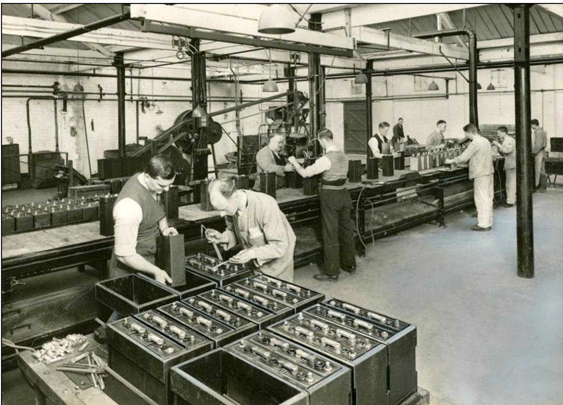
Figura 23: Sala de montaje de acumuladores, hacia 1930 (Arch. J.M. Sanchis)
