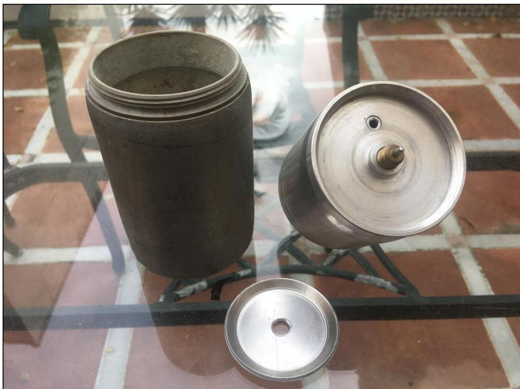
*Figura 28: Lámpara desmontada (Col. y foto A. Gómez)*
