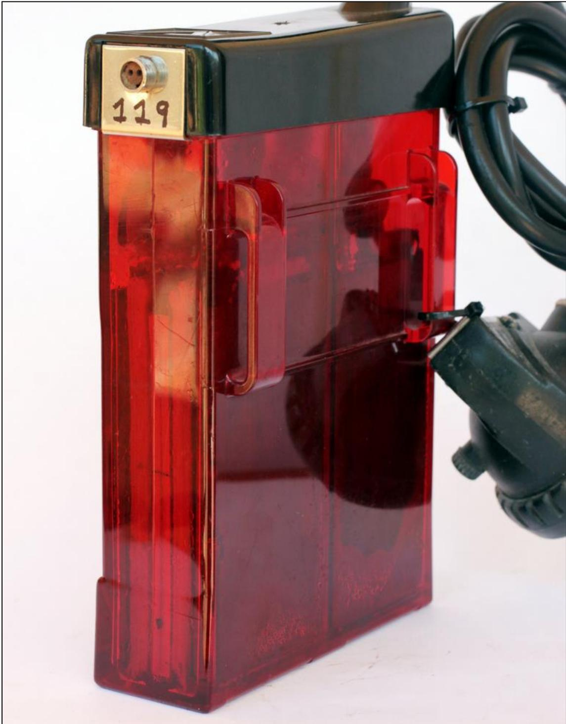
*Figura 90: Detalle de los realces para el cinturón
