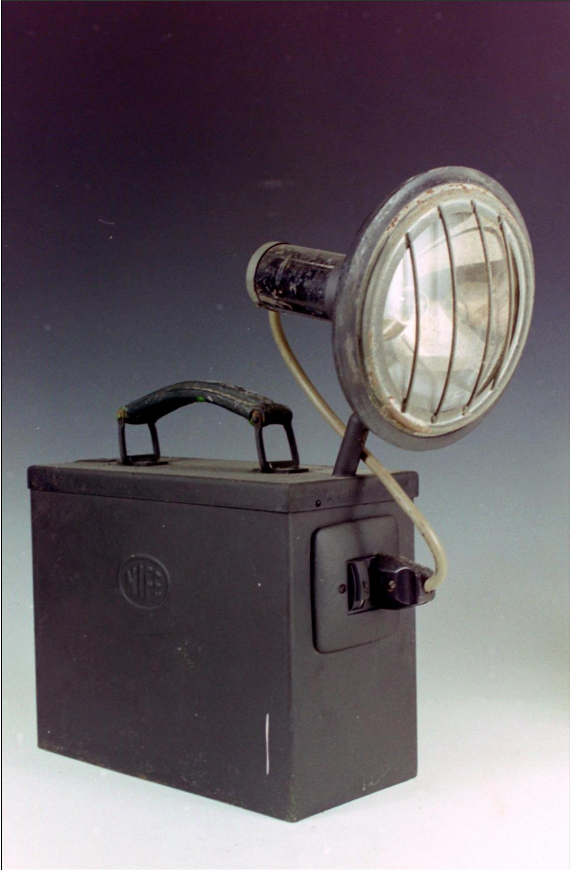
*Figura 48: Lámpara tipo L-8 (Col. y fot. J.M. Sanchis)*
