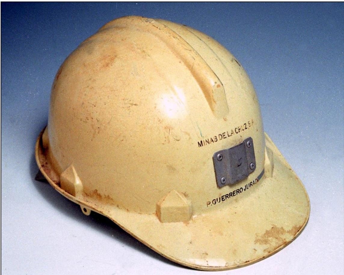
*Figura 90: Casco con soporte remachado. Minas de La Cruz, Linares (Col. y fot. J.M. Sanchis)*
