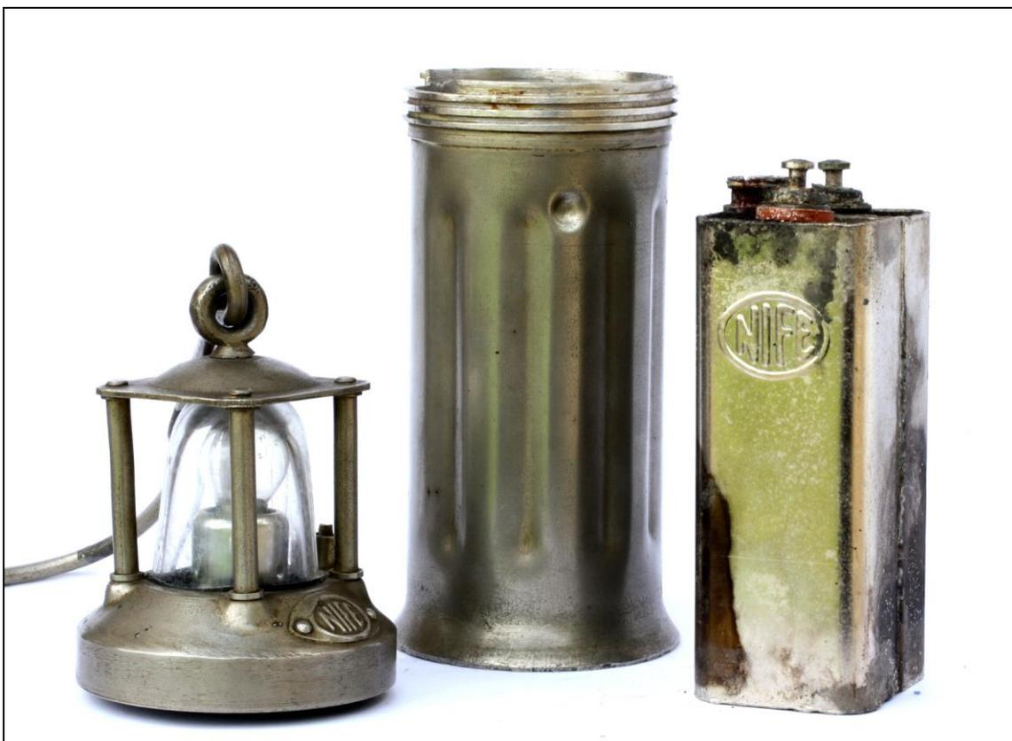
Figura 53: Lámpara de minero desmontada (Col. y fot. J.M. Sanchis)
