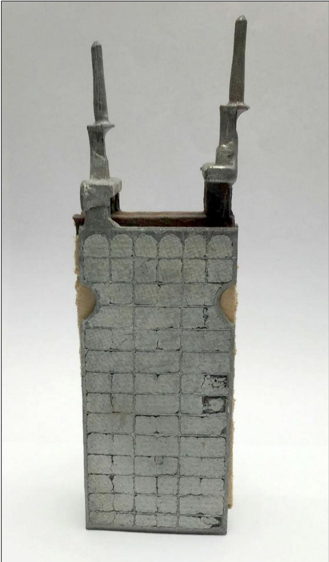
*Figura 99: Placa de una batería Tudor (Col. y fot. J.L. García)*
