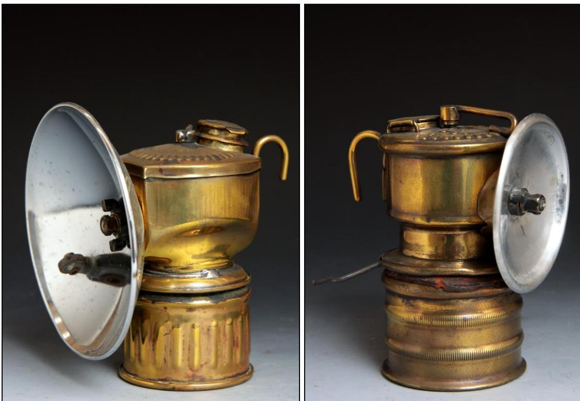
*Figura 44 (Izquierda): Lámpara de carburo de casco. EEUU, 1950
