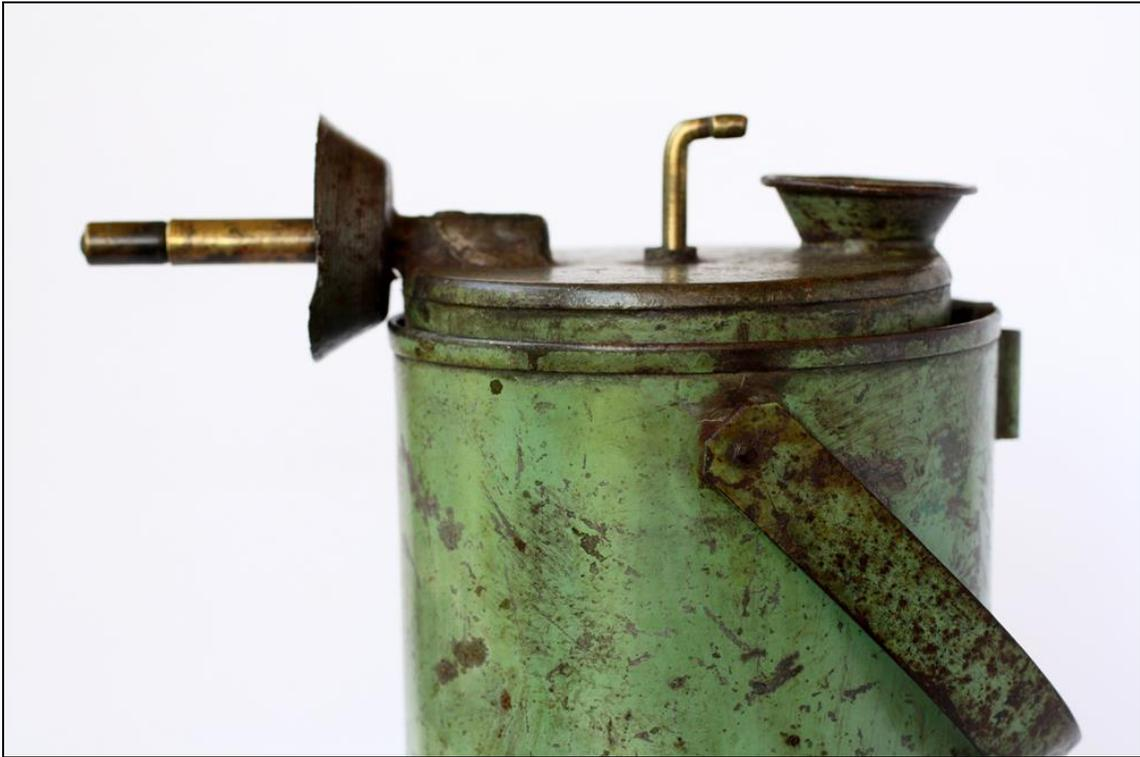
*Figura 16: Detalle de la parte superior: embudo de llenado de agua, llave reguladora y mechero con su pantalla (Fot. J.M. Sanchis; col. J.L. García)*
