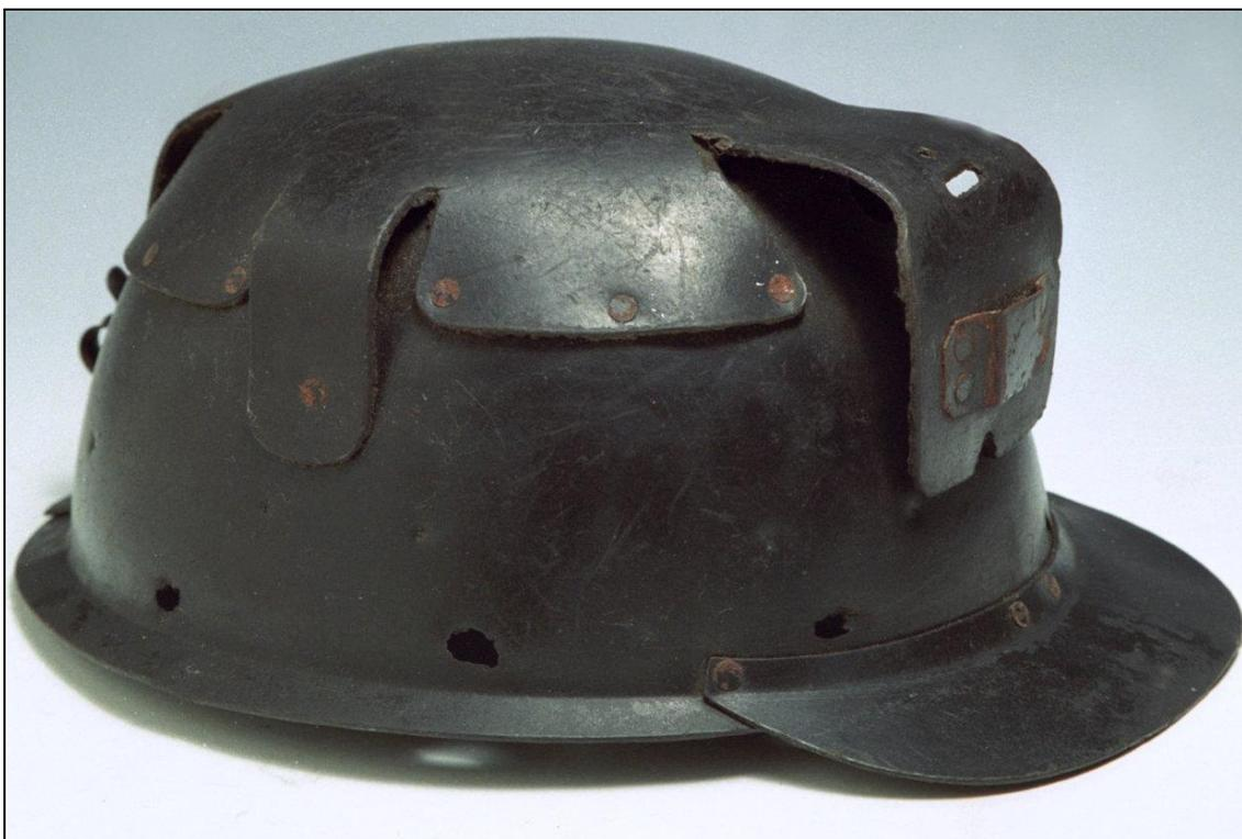
*Figura 84: Casco con soporte de cuero. Inglaterra (Col. y fot. J.M. Sanchis)*
