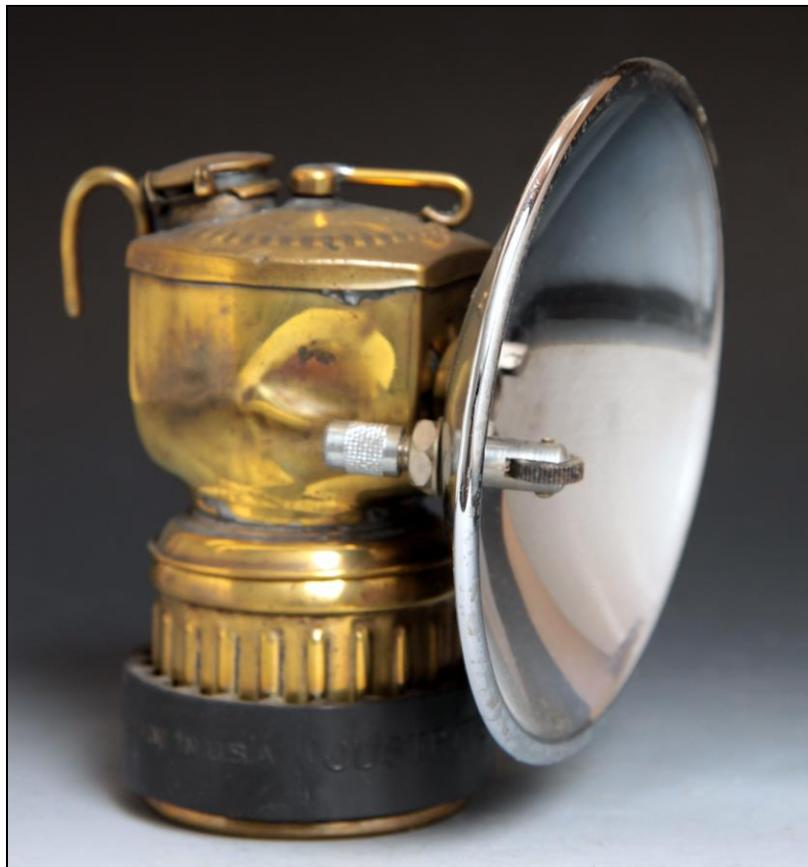
Figura 43: Lámpara Justrite con pantalla y encendedor (Col. y foto J.M. Sanchis)
