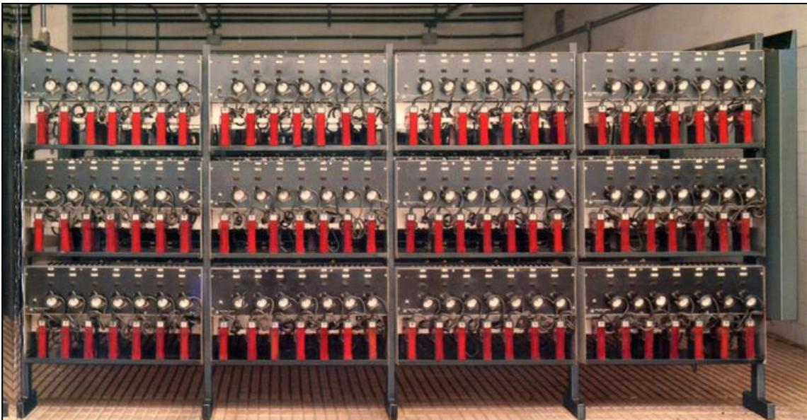
Figura 94: Cargadores de lámparas del tipo P (Fot. Adaro, S.A.)
