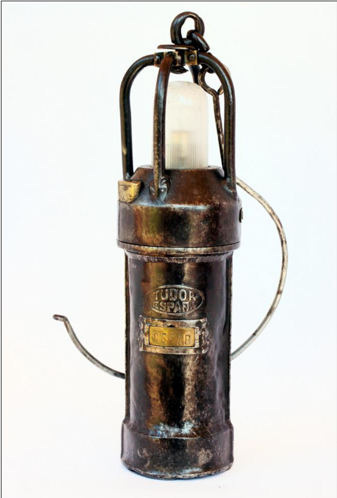
*Figura 70: Lámpara tipo III de jaula tronco-cónica
