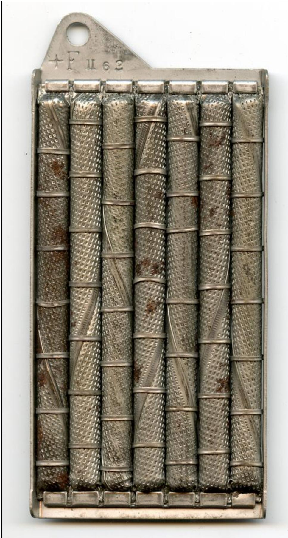
Figura 97: Placa positiva de una batería (Col. y fot. J.M. Sanchis)
