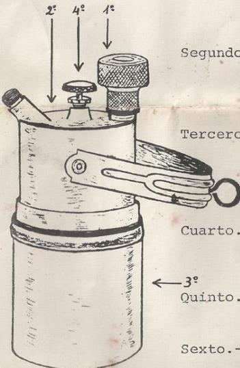
Primero.- Se desenrosca hasta destaparla la pieza n°1 que sujeta la válvula de seguridad, debiéndose de llenar el depósito de agua n°2 hasta el máximo y tapar fuertemente de nuevo.
