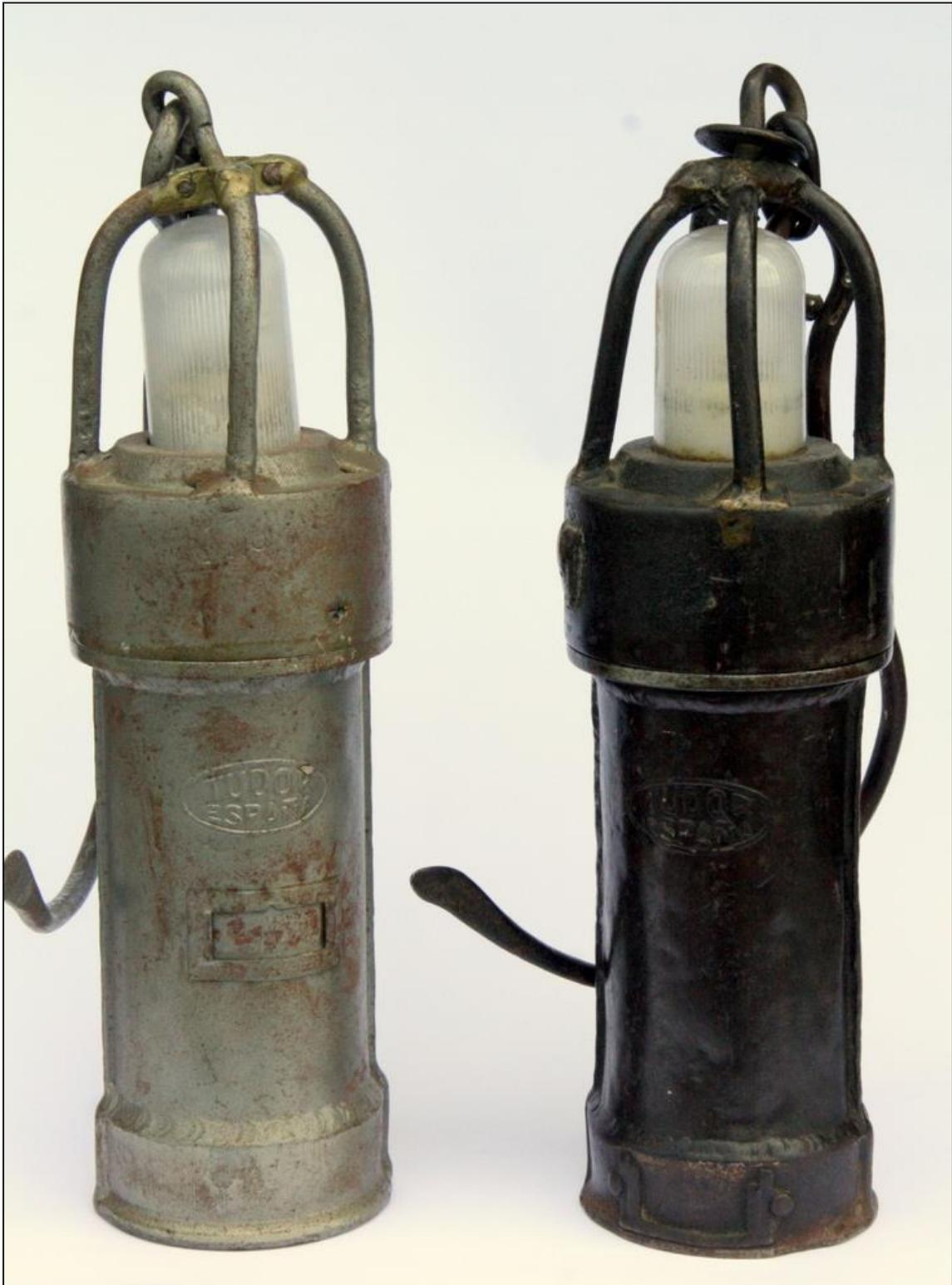
*Figura 69: Los dos tipos de lámpara de chapa lisa, tipos II y III
