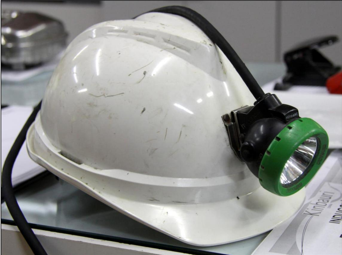
*Figura 93: Casco y lámpara Minearc Australia. Mina de oro de Carlés, Asturias (Fot. J.M. Sanchis)*
