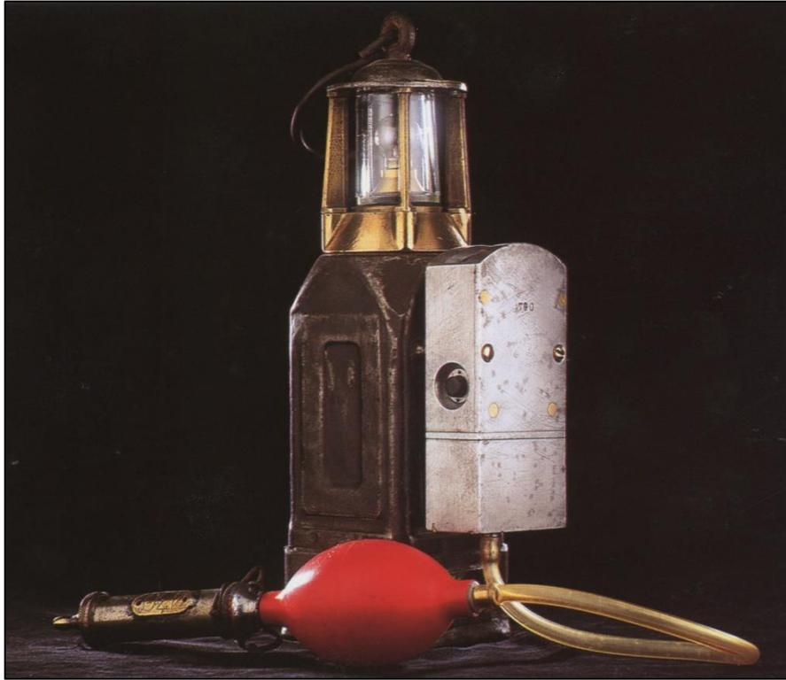
Figura 222: Grisúmetro Leon (Fot. tomada de "Les lampes de Mine", de M. Dupont y G. Lebois, 1994)
