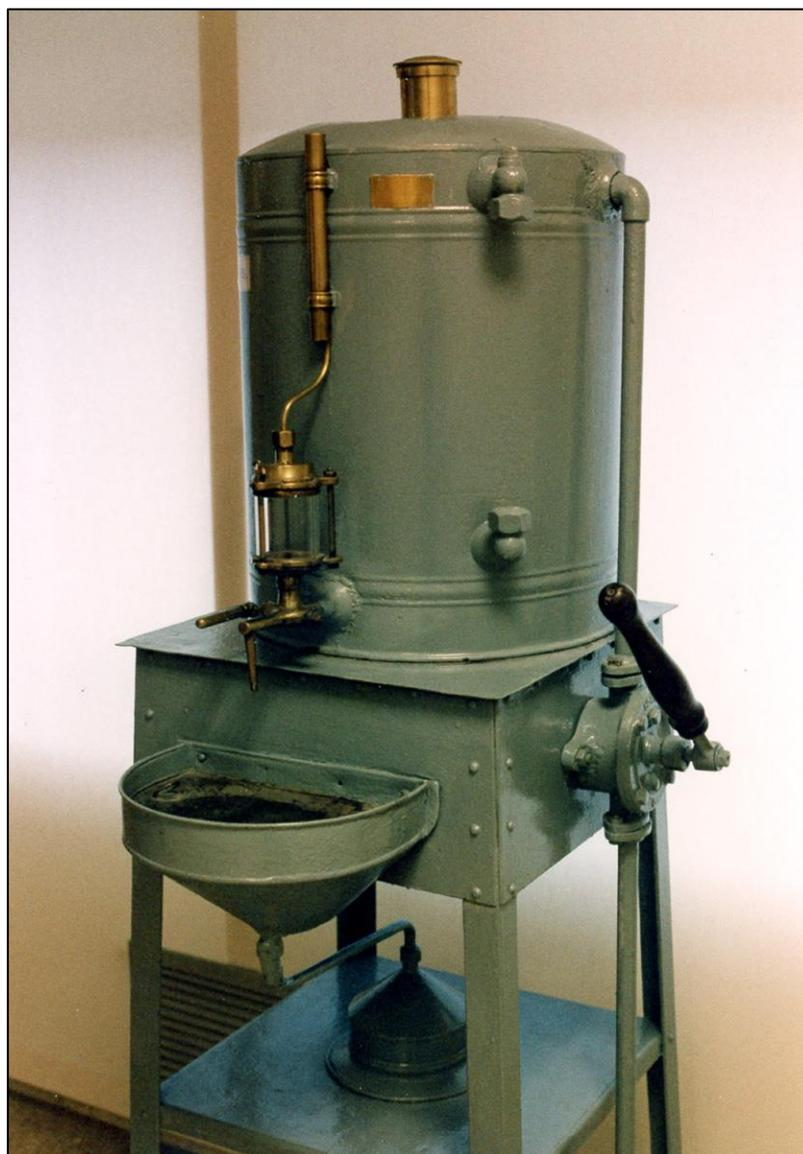
Figura 247: Aparato rellenable de gasolina Adaro. Minas de HVL (Fot. JMS)
