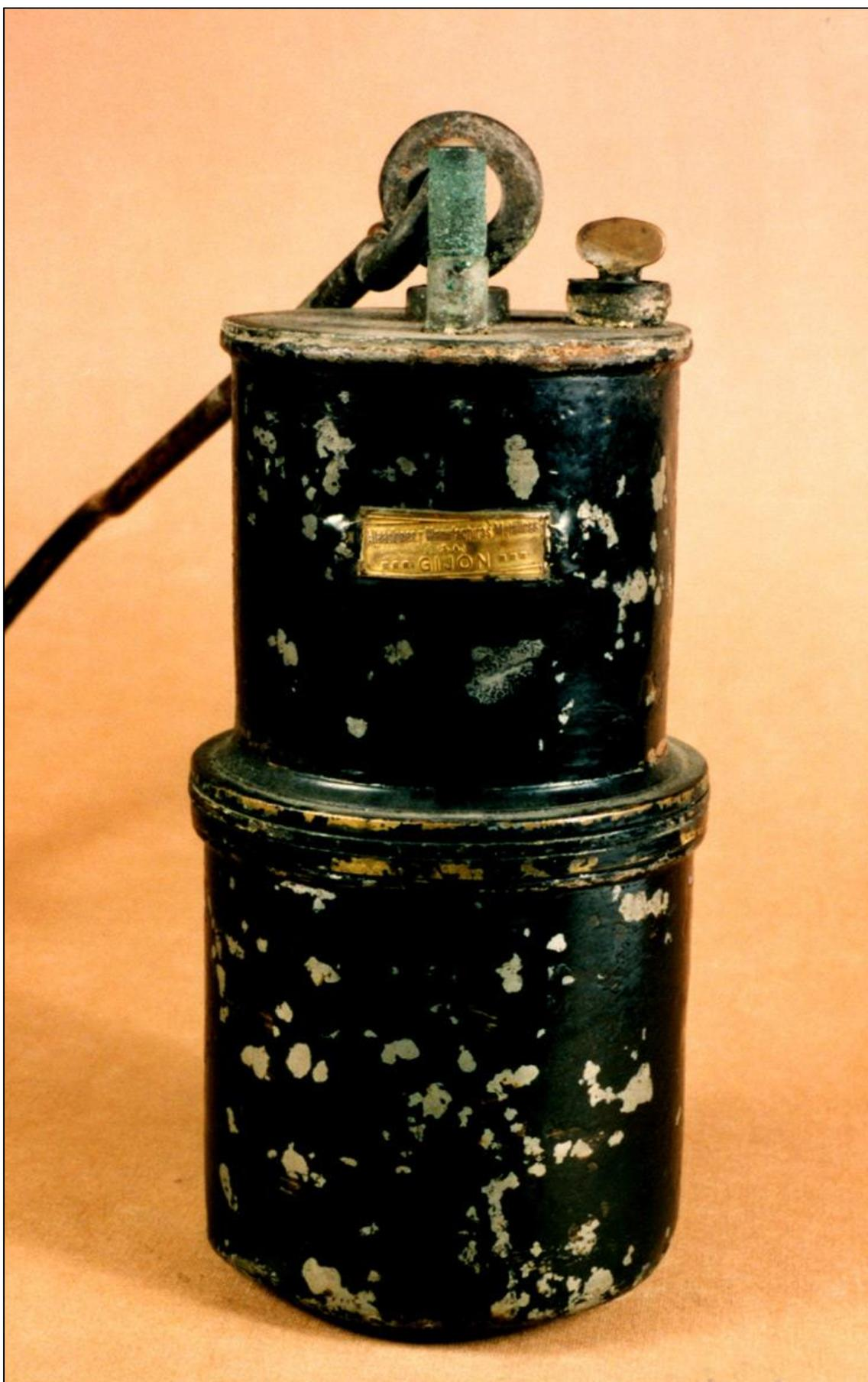
Figura 67: Primitiva lâmpara Adaro de carburo (Col. ALA; fot. JMS)
