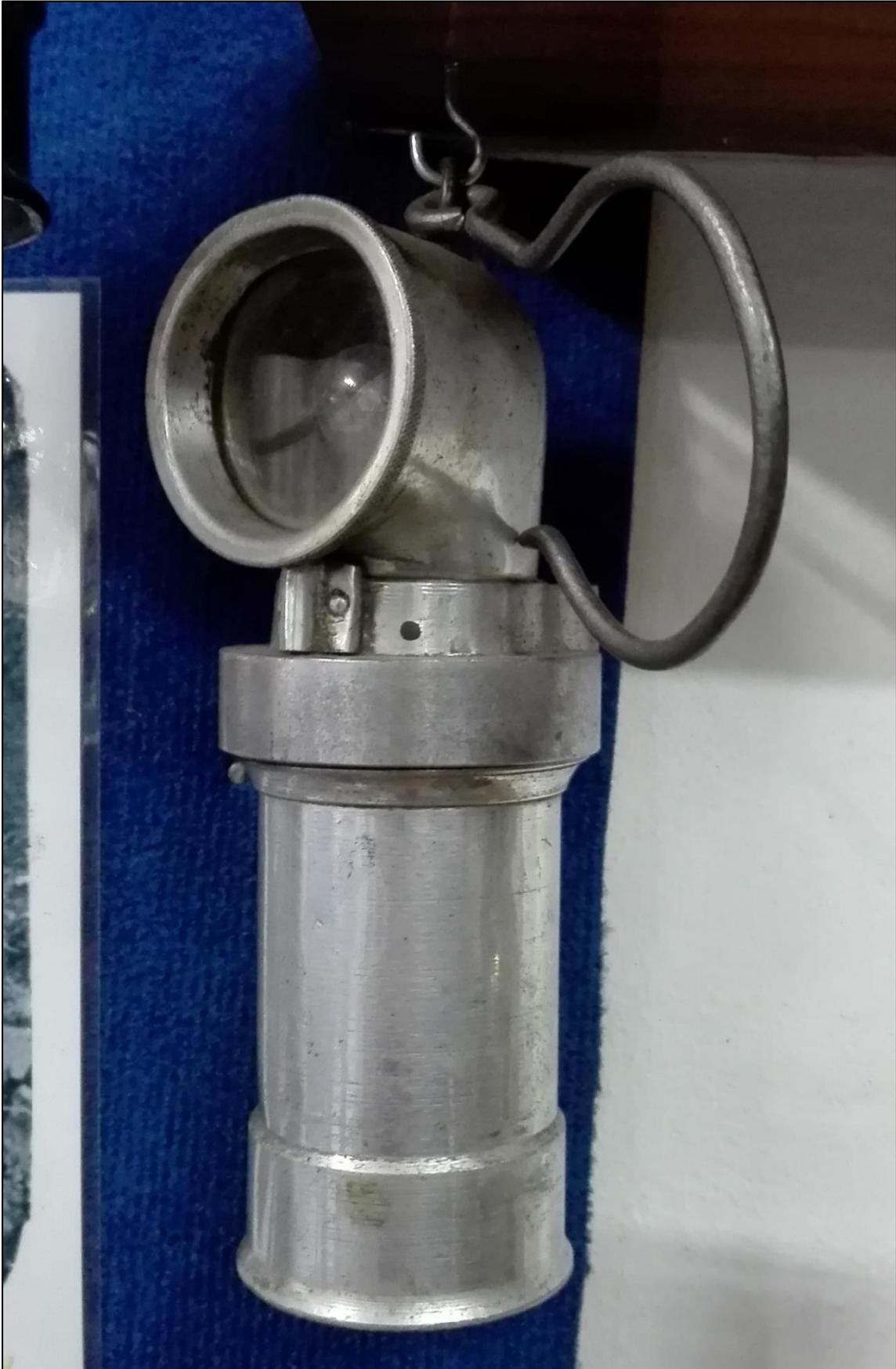
*Figura 155: Lámpara de inspección de aluminio (Col. Pepín Sánchez; fot. JMS)*
