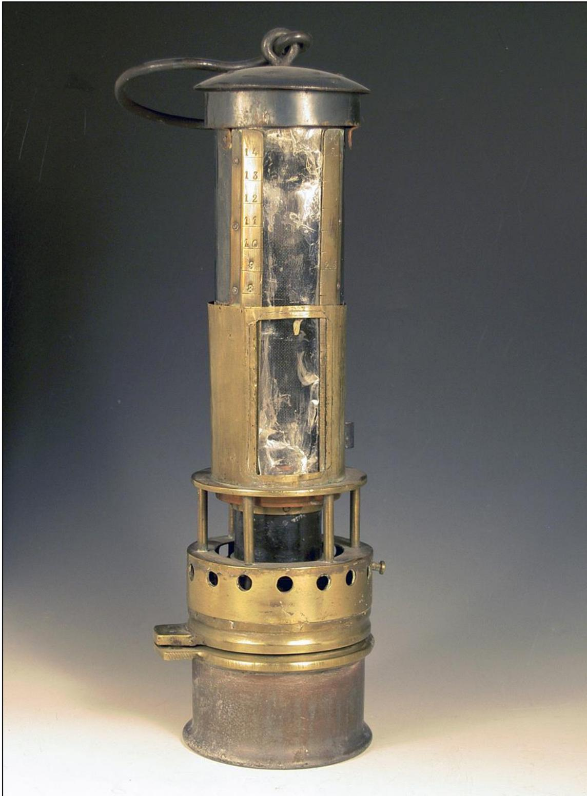
Figura 214: Lámpara Chesneau fabricada por Adaro (Col. EIM; Fot. JMS)
