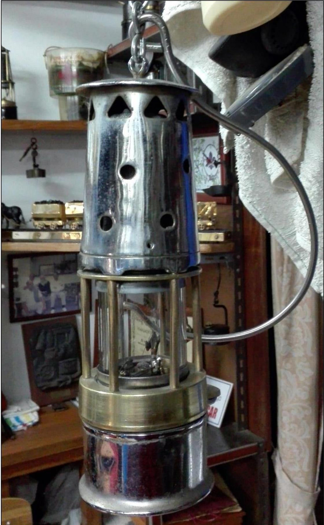
*Figura 120: Lámpara de gasolina con coraza perforada (Col. Pepín Sánchez; fot. JMS)*
