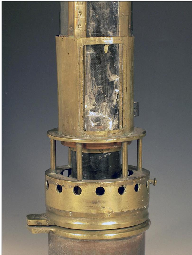
*Figura 213: Detalle de la ventanilla de mica (Col. EIM; Fot. JMS)*
