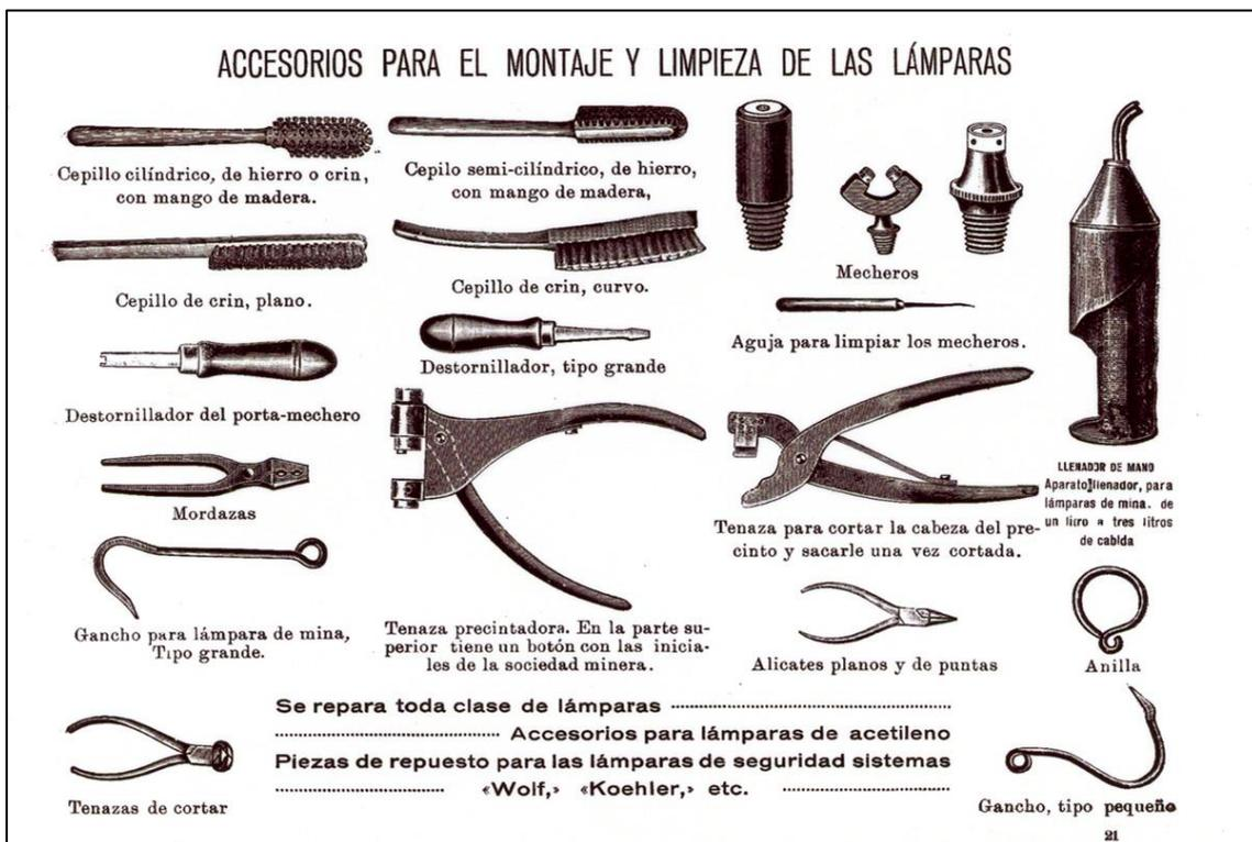
Figura 253: Herramientas de lampistería (Arch. JMS)
