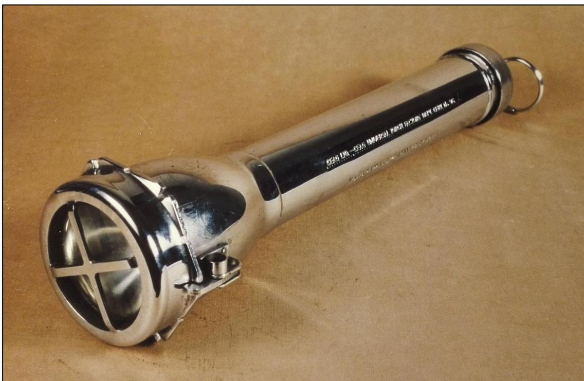
Figura 232: Linterna de seguridad Adaro-CEAG (Col. ALA; Fot. JMS)
