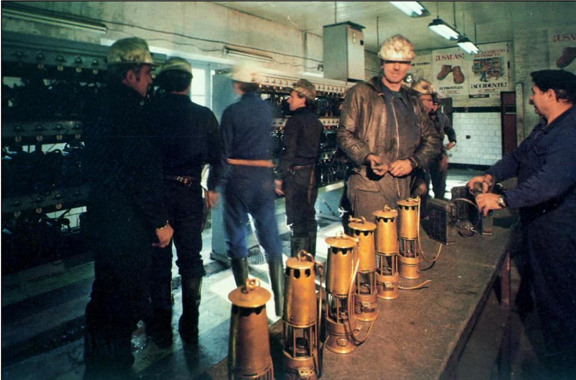
Figura 243: Lámparas de gasolina en la lampistería (Fot. HVL, rev. Hornaguera, 1994)
