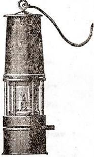
Lámpara de seguridad de alimentación inferior, para bencina, con encendedor automático. Probadas para grandes corrientes de aire y gas grisú
