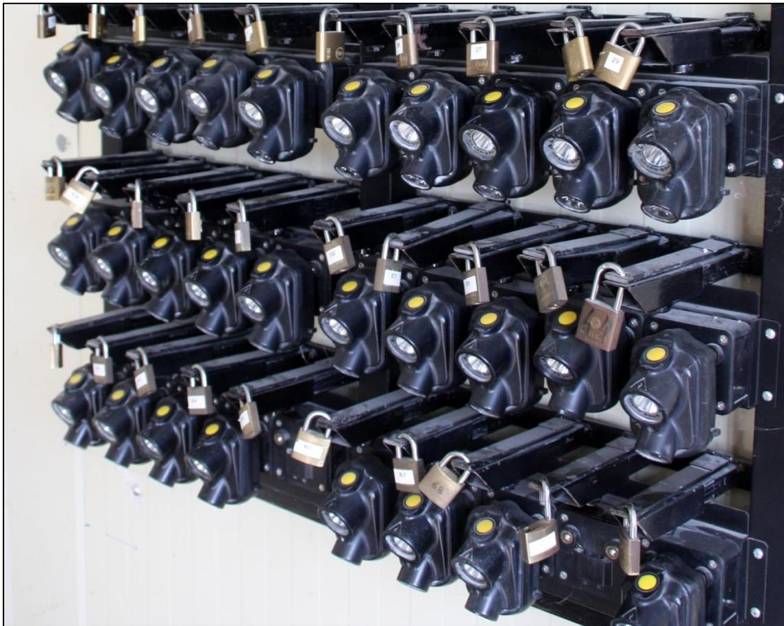
Figura 205: Lámparas Alfa WL en sus cargadores. Mina de Aguablanca, Monesterio, Badajoz, 2017 (Fot. JMS)
