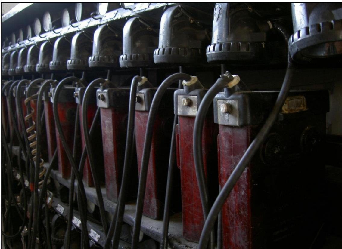
*Figura 186: Lámparas P en carga (Fot. S.A. Adaro)*
