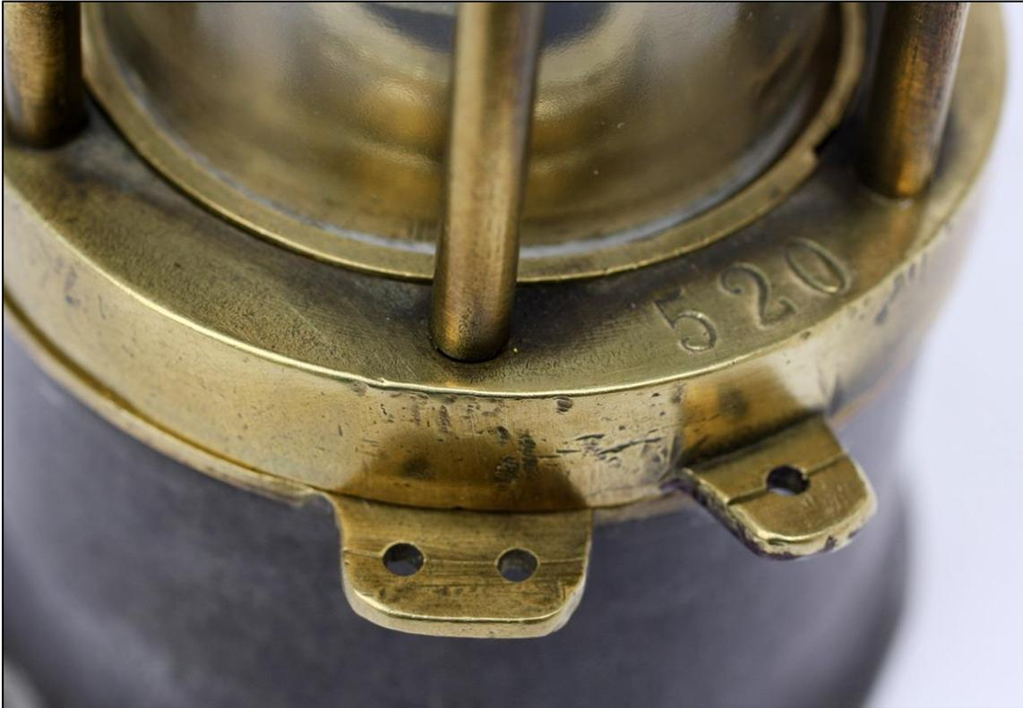
*Figura 86: Detalle de las orejas del precinto (Col. JLG; fot. JMS)*
