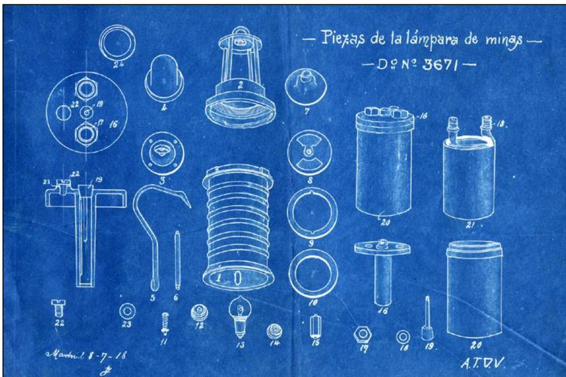
Figura 134: Plano de fábrica de la lámpara eléctrica de 1918 (Arch. JMS)
