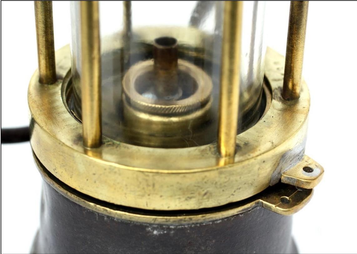
Figura 26: *Detalle orejas de precintado (Col. JLG, fot. JMS)*
